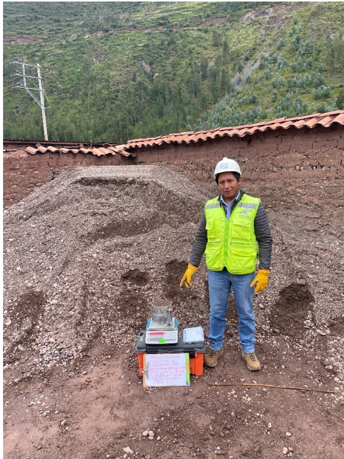
Pesaje de material que será utilizado para la prueba de carga.
