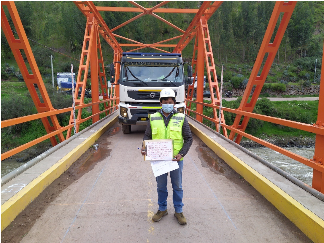
Figura 24: Ubicación del camión de prueba en centro de luz del puente.
