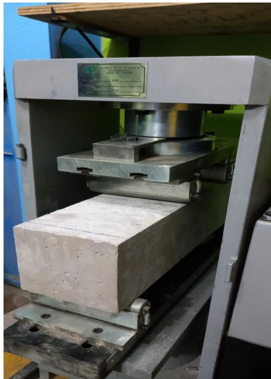
Foto N° 19 y 20. Ensayo a flexión de la muestra patrón a los 28 días.
