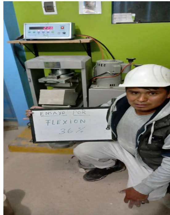
Foto N° 21 y 22. Ensayos a flexión con los porcentajes de 24% y 36% de polipropileno.
