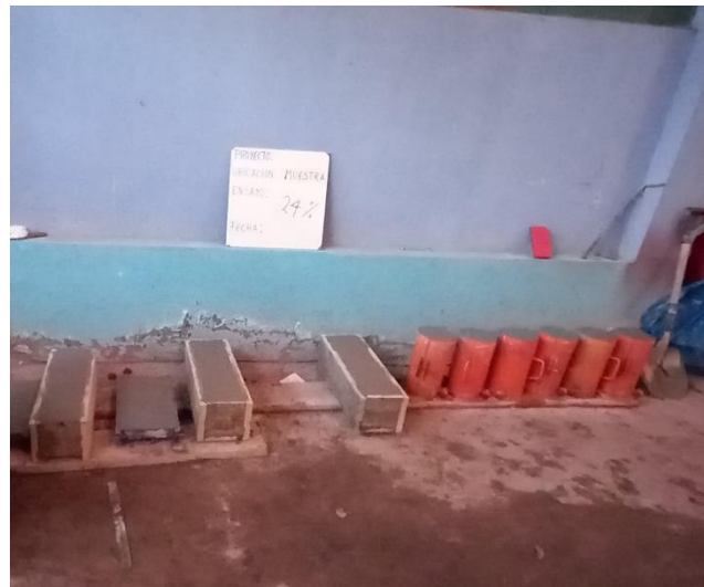
Foto N° 11 y 12. Muestra las probetas para los ensayos con el porcentaje de microfibra de PVC.
