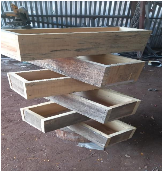
Foto N° 5 molde para el ensayo a flexión.
