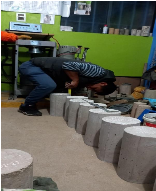
Foto N° 17 y 18. Ensayo a la compresión a los 14 días
