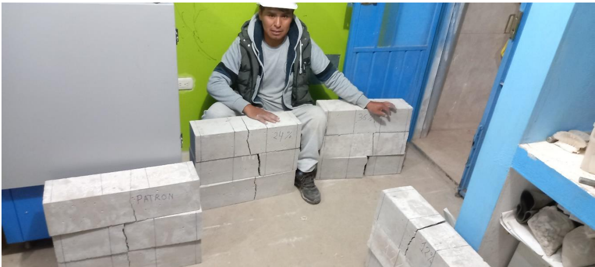
Foto N° 23. Rotura de las muestras prismáticas en el ensayo a flexión del concreto.
