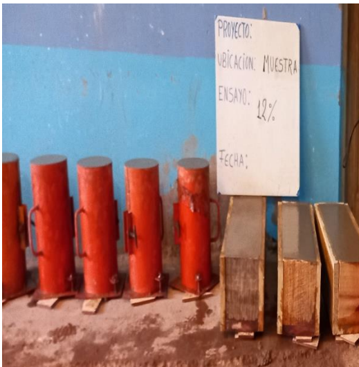
Foto N° 11 y 12. Muestra las probetas para los ensayos con el porcentaje de microfibra de PVC.
