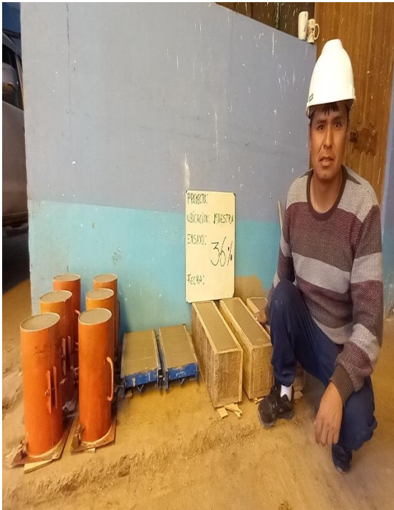
Foto N° 13. Probetas para los ensayos, con el % de microfibras de PVC.
