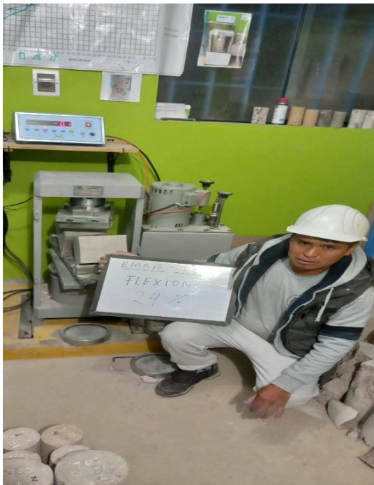
Foto N° 21 y 22. Ensayos a flexión con los porcentajes de 24% y 36% de polipropileno.
