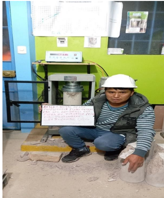
Foto N° 17 y 18. Ensayo a la compresión a los 14 días
