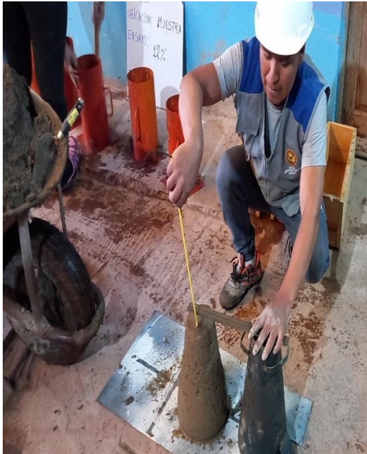
Foto N° 9 muestra el ensayo del SLUMP.
