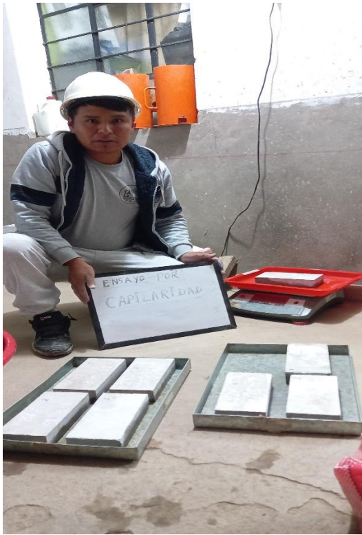
Foto N° 24 y 25. Ensayo por absorción por capilaridad.
