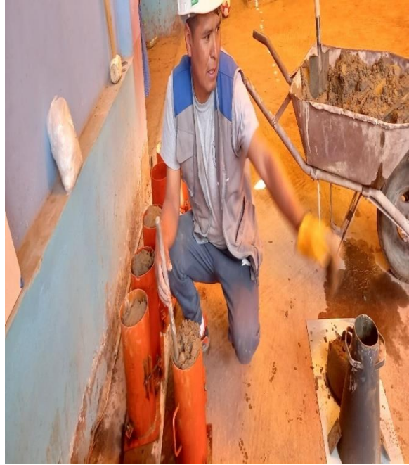
Foto N° 9 muestra el ensayo del SLUMP.
