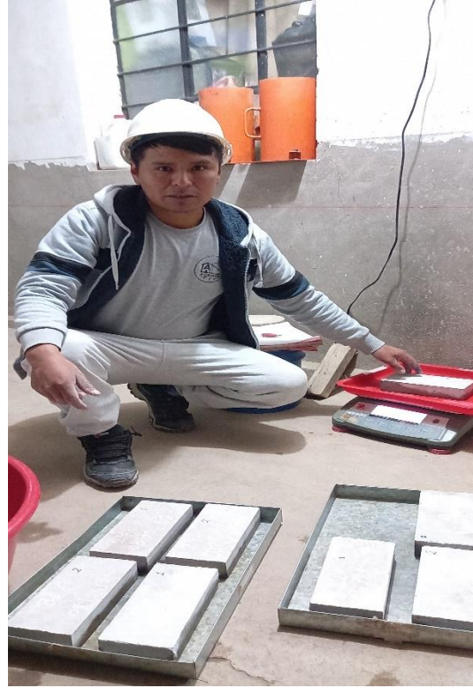
Foto N° 24 y 25. Ensayo por absorción por capilaridad.
