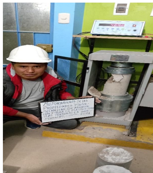
Foto N° 15 y 16. Ensayo a la compresión a los 7 días.
