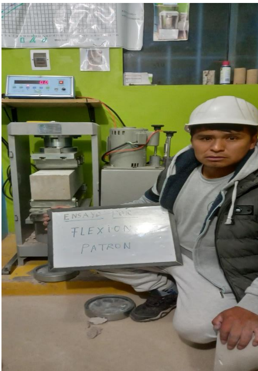
Foto N° 19 y 20. Ensayo a flexión de la muestra patrón a los 28 días.
