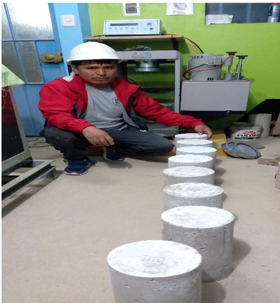
Foto N° 15 y 16. Ensayo a la compresión a los 7 días.
