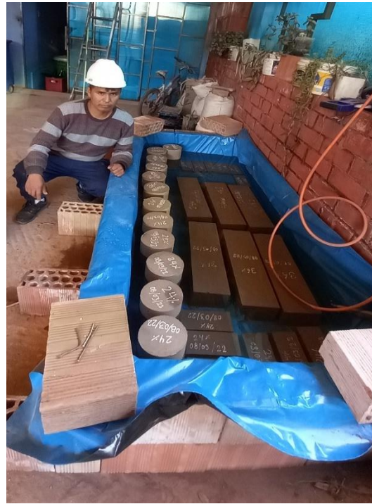
Foto N° 13. Probetas para los ensayos, con el % de microfibras de PVC.
