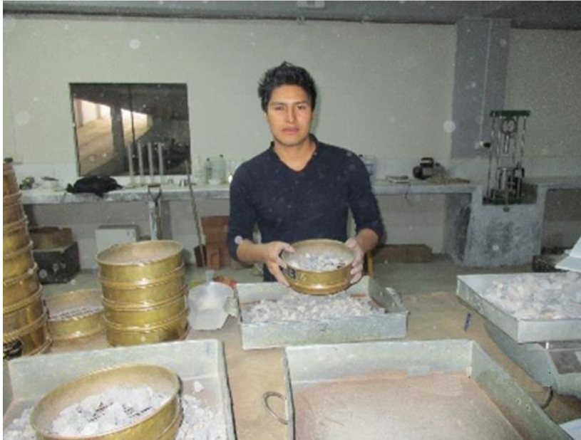
Figura 25. Granulometría de del agregado grueso Nota: La figura muestra el trabajo realizado de granulometría, a través de los tamices, para determinar el tamaño del agregado grueso.
