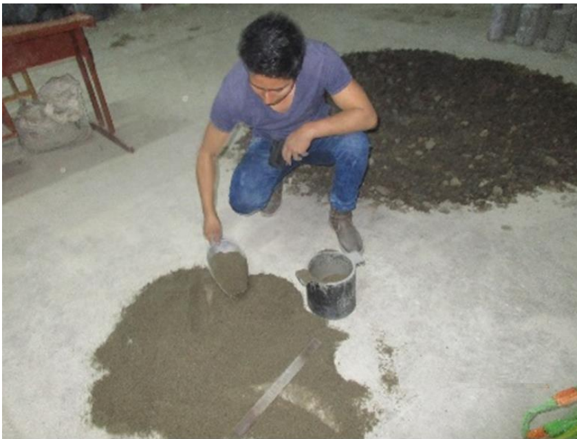
Figura 26. Cuarteo del material agregado fino Nota: En la figura se aprecia el cuarteo del agregado fino para proceder al ensayo de la granulometría.
