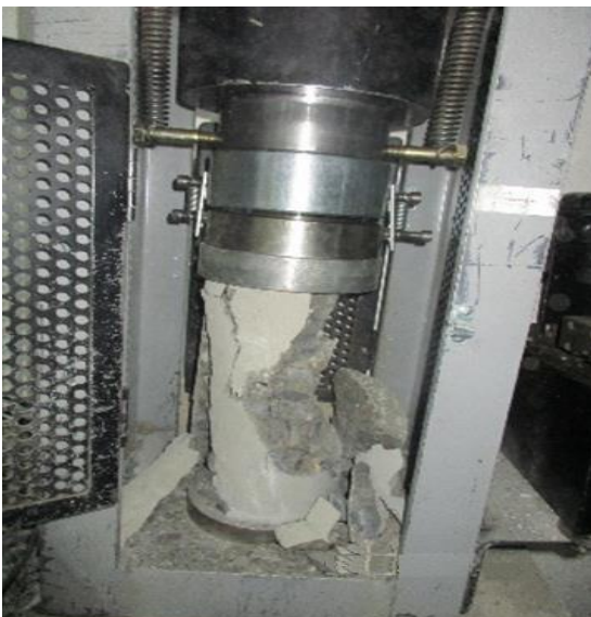
Figura 40. Fisura de probeta
