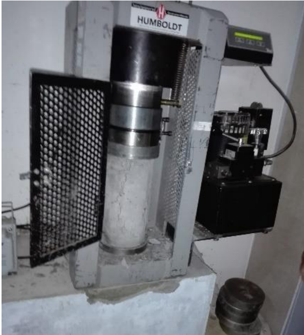
Figura 39. Prueba de resistencia a la compresión
