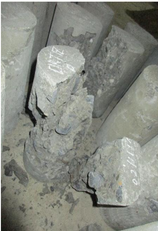
Figura 42. Probetas con fisuras
