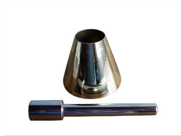
Figura 7. Cono de absorción de arena y pisón
