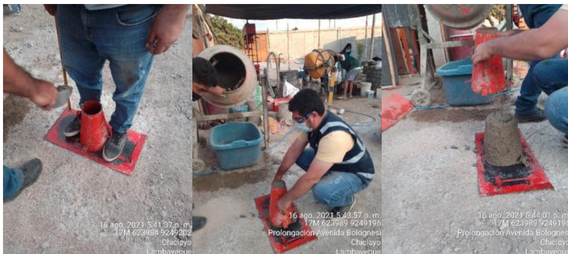
Realizando el ensayo del diseño Patrón, con el cono de Abrams o ensayo de SLUMP
