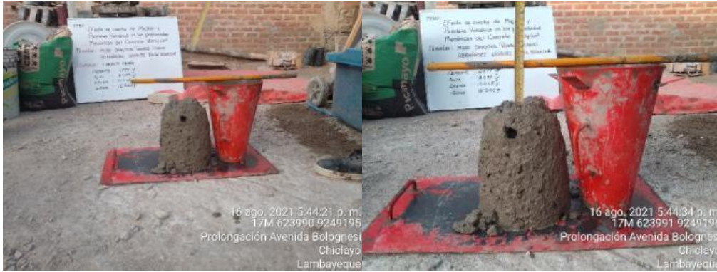
Realizando el ensayo del diseño Patrón, su SLUMP salió 3.5”, con una buena trabajabilidad de 3 – 4 in
