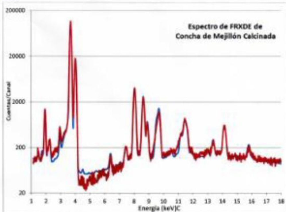
Figura 1. Espectro de FRXDE de una muestra de concha de mejillón calcinada en escala semi logarítmica. Incluye el pico de Ar del aire y los picos de rayos-X de Au dispersados por la muestra. La curva en azul muestra el espectro simulado
