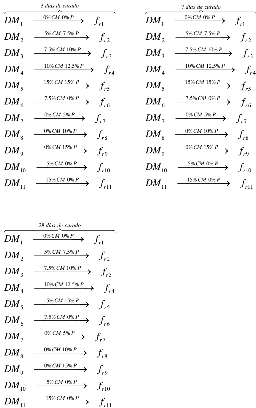
Figura 5. Diseño de investigación para la resistencia a flexión del concreto
