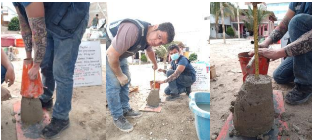
Realizando el ensayo del diseño # 5, su SLUMP salió 3.5”, con una buena Trabajabilidad de 3 in – 4 in.
