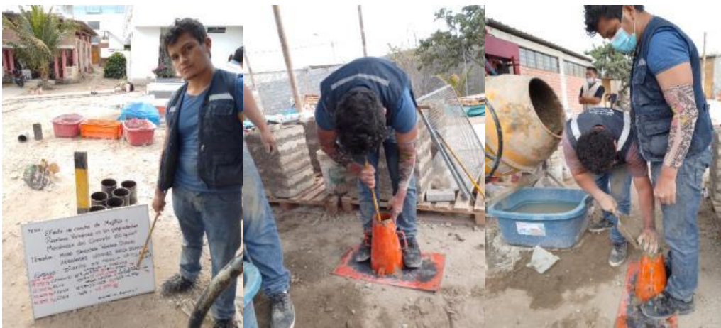
Realizando el ensayo del diseño # 5, con el cono de Abrams u ensayo de SLUMP
