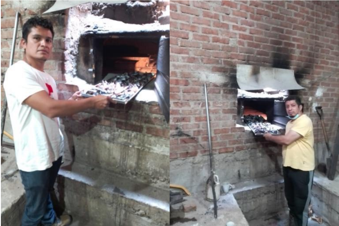
Colocación al horno a una temperatura de 150^{\circ}\text{C} \pm 10^{\circ}\text{C} por 6 horas
