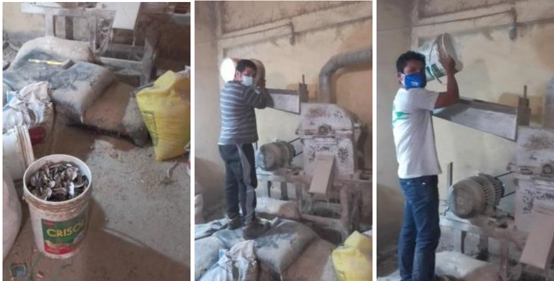
Trituración de conchas de mejillón en partículas de la arena gruesa
