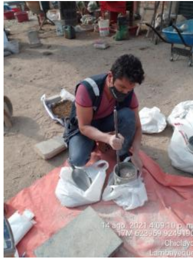
Procedimiento para la elaboración del ensayo para obtener el peso específico del material de conchas de mejillón
