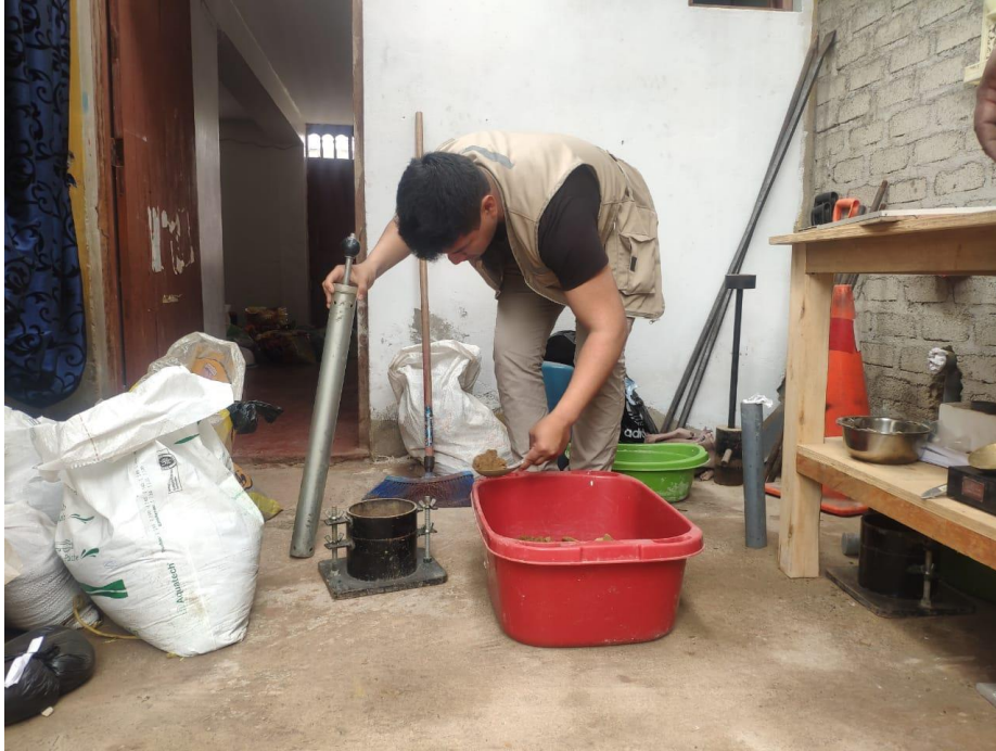
Compactación del material sub dividido en 5 capas en el molde de Proctor Modificado.
