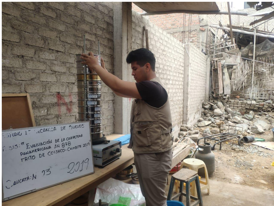
Realizando el Ensayo Granulométrico por tamizado.
