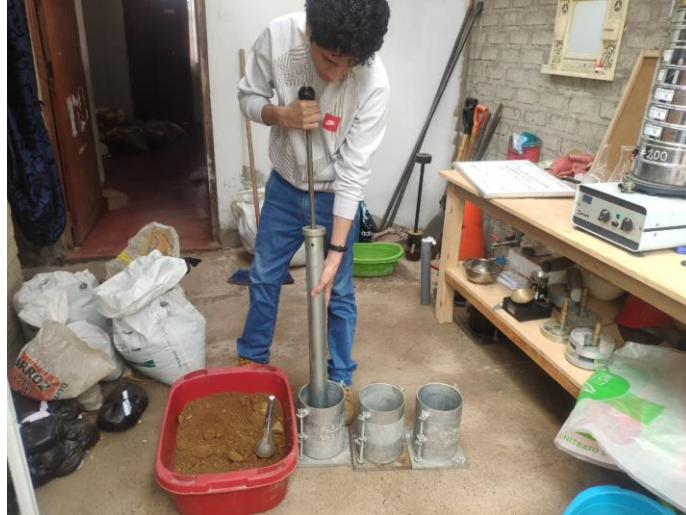
Compactación del material sub dividido en 5 capas en el molde de CBR.
