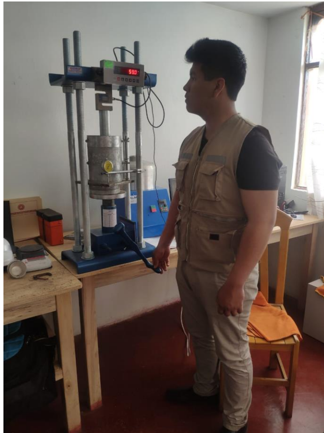
Ensayando los moldes de CBR en la prensa de Marshall.
