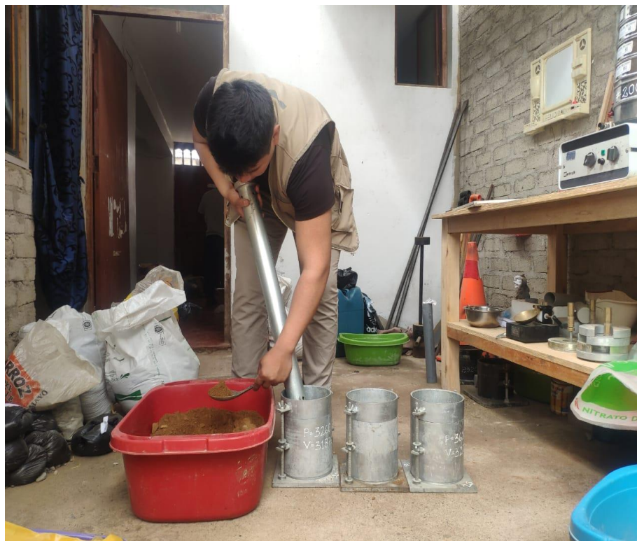
Compactación del material sub dividido en 5 capas en el molde de Proctor Modificado.
