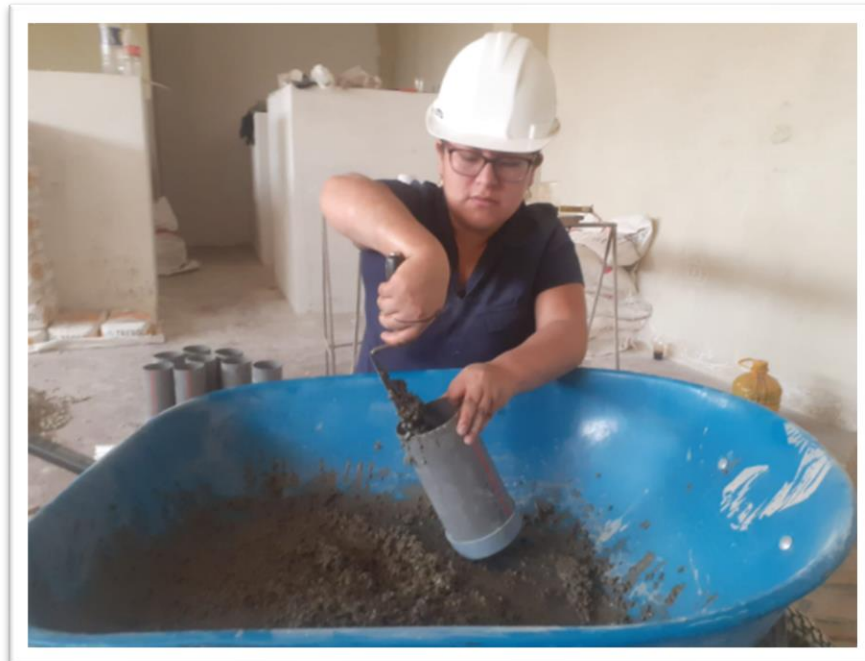
Figura 7: Elaboración de las probetas
