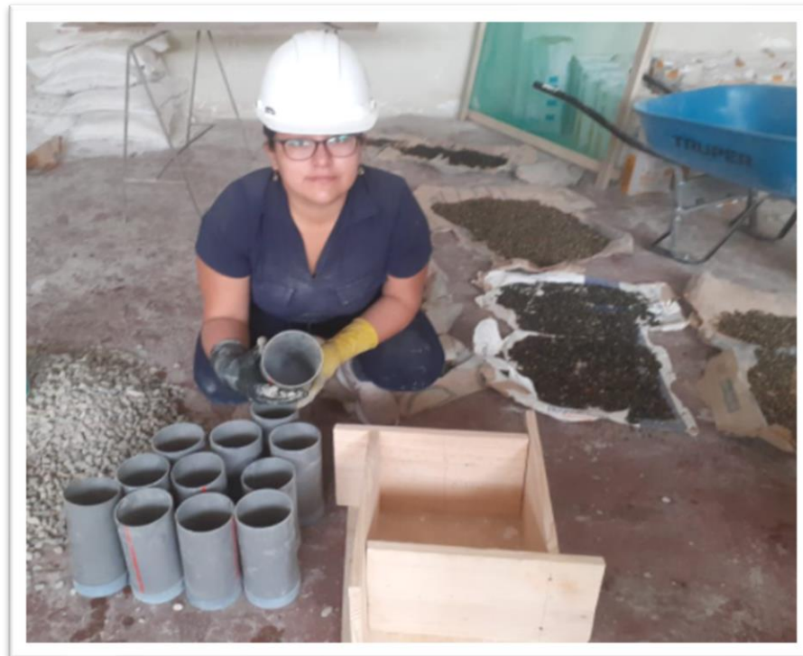
Figura 3: Encofrado para el prototipo de concreto permeable.
