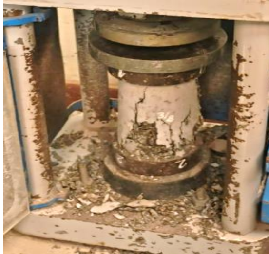
Figura 19. Falla de tipo tres del espécimen de 3/8”.
