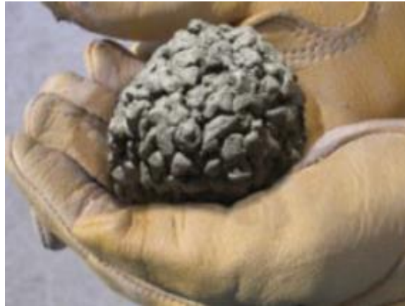
Figura 8 Concreto poroso con adecuada cantidad de agua.
