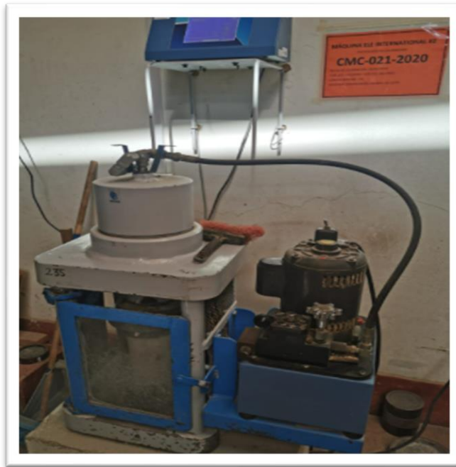
Figura 4: Máquina ELE Internacional #2, para la resistencia a la compresión de probetas
