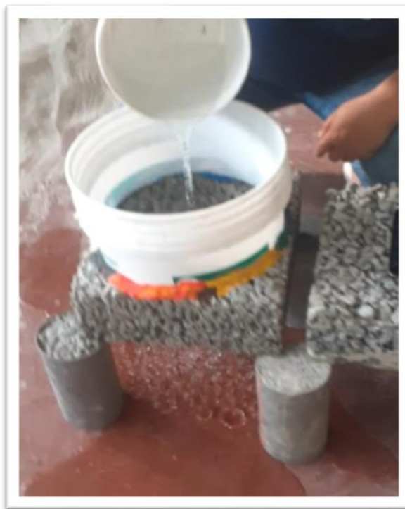
Figura 20. Ensayo de permeabilidad del concreto poroso
