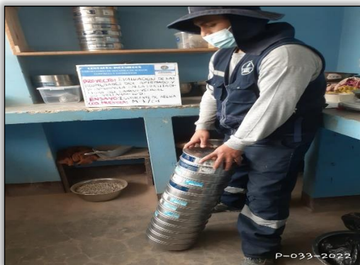
Foto N°09: Ensayo de granulometría.
