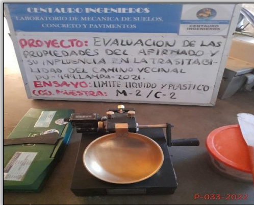
Foto N°07: Cuchara de Casagrande, para la evaluación de Limites.
