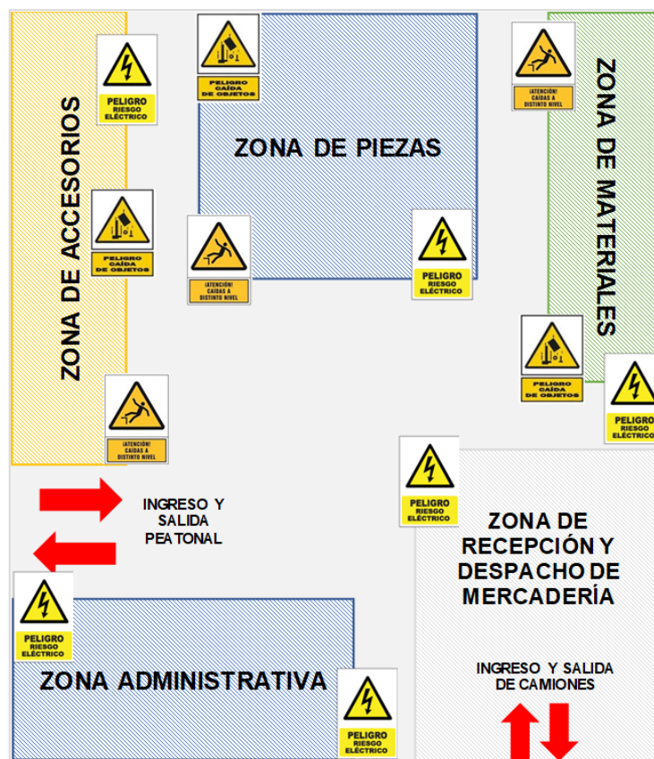
Figura 9. Señalización de los lugares de peligro
