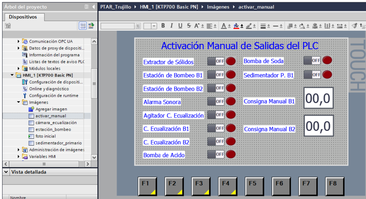
Figura 37. Configuración de imagen de activación manual en HMI
