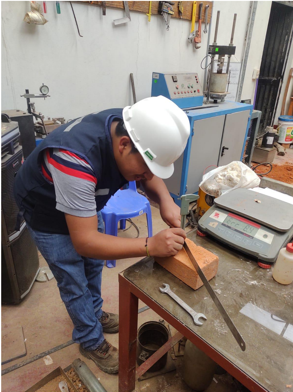
Prueba de alabeo de los ladrillos artesanales
