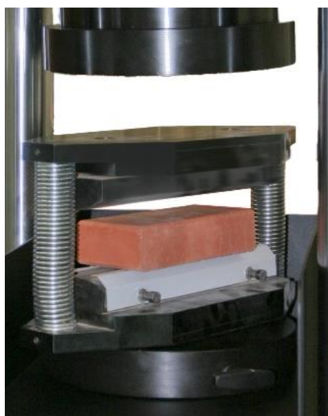
Figura 4. Resistencia a la compresión
