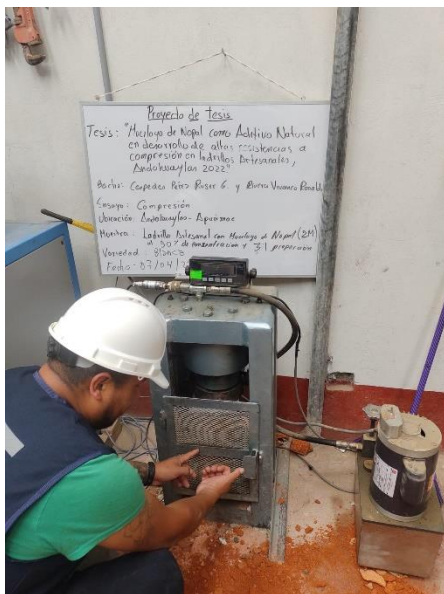
Prueba de resistencia a la compresión de los ladrillos artesanales con aditivo y sin aditivo
