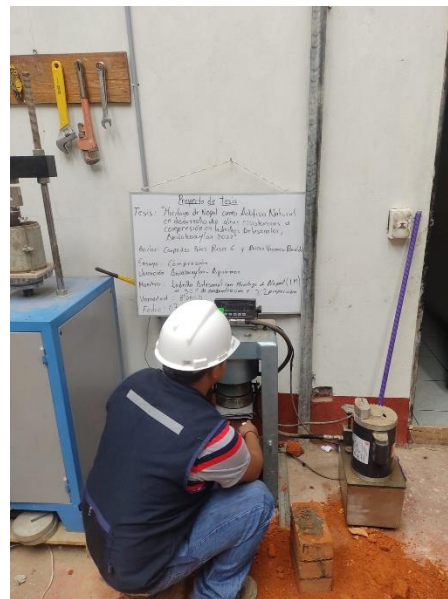
Prueba de resistencia a la compresión de los ladrillos artesanales con aditivo y sin aditivo
