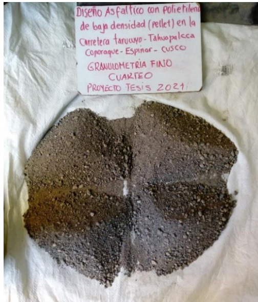
Figura 5 Cuarteo de Agregado Fino TN 3/8"
