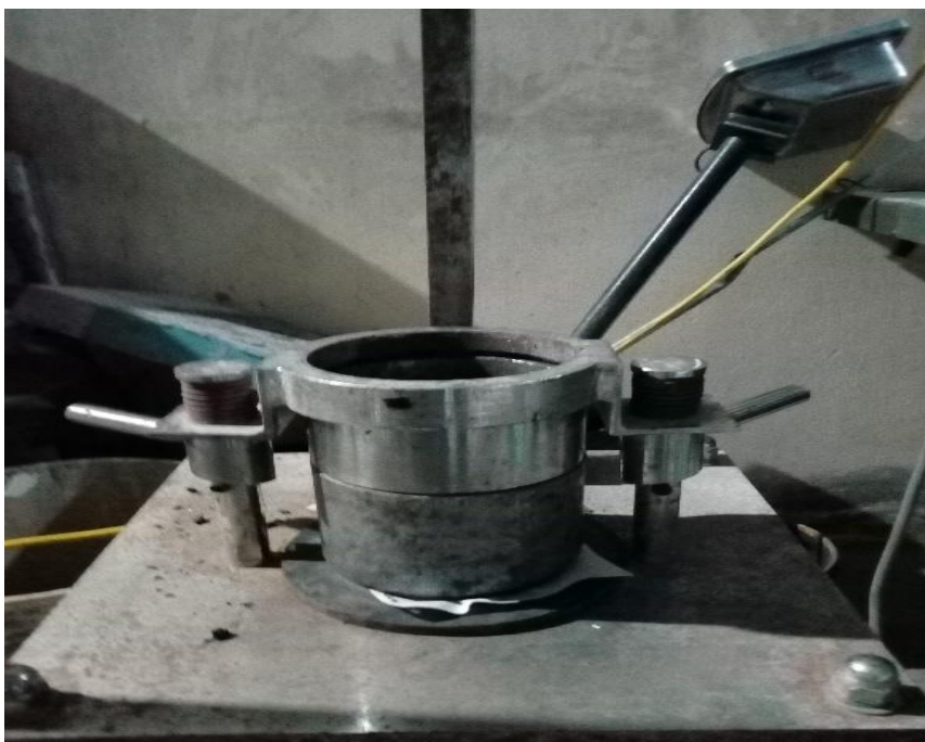
Figura 10 Molde de Briquetas de Asfalto
