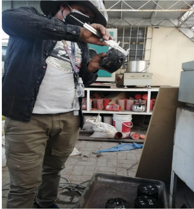
Figura 15 Lectura de Altura de las Briquetas.
