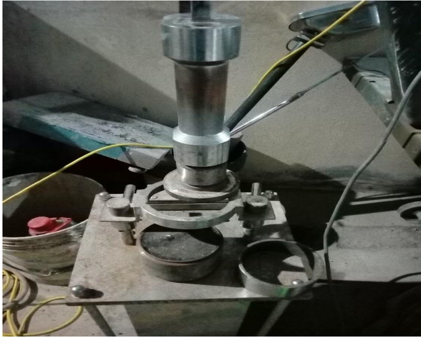
Figura 9 Cambio de Cara de Briquetas para Compactar
