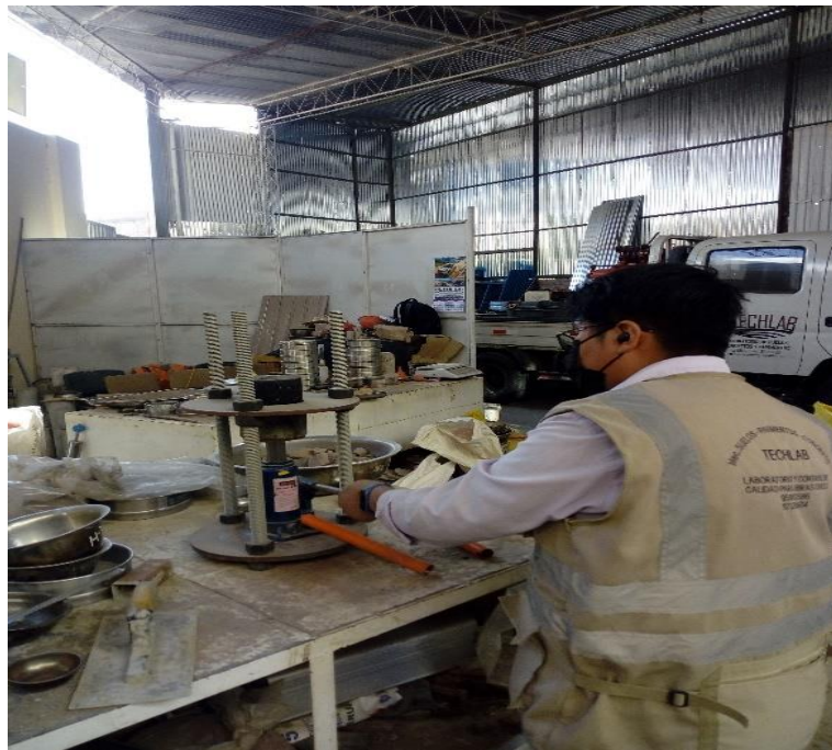
Figura 11 Extracción de las Briquetas del Molde.
