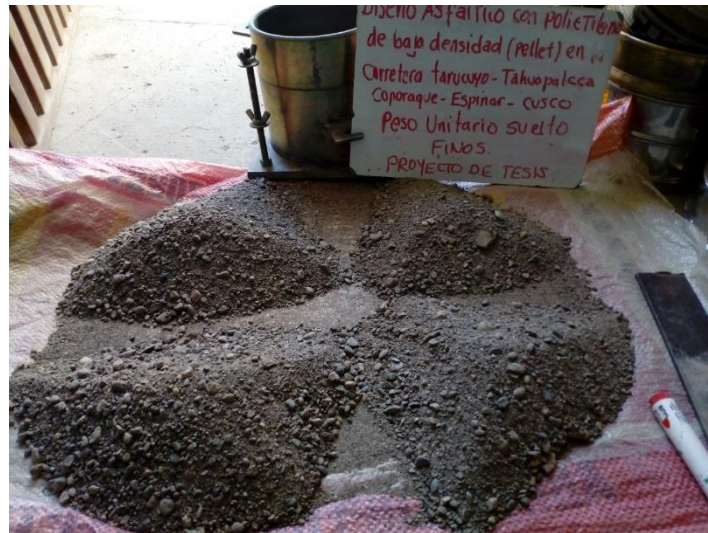
Figura 23 Cuarteo para Realizar el P.U.
