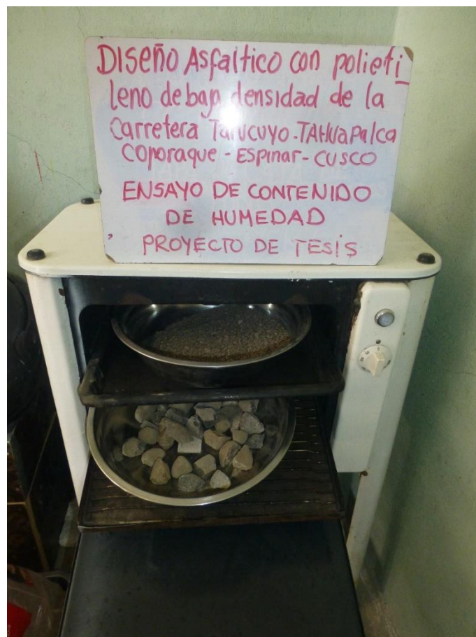
Figura 18 Ensayo de Contenido de Humedad.
