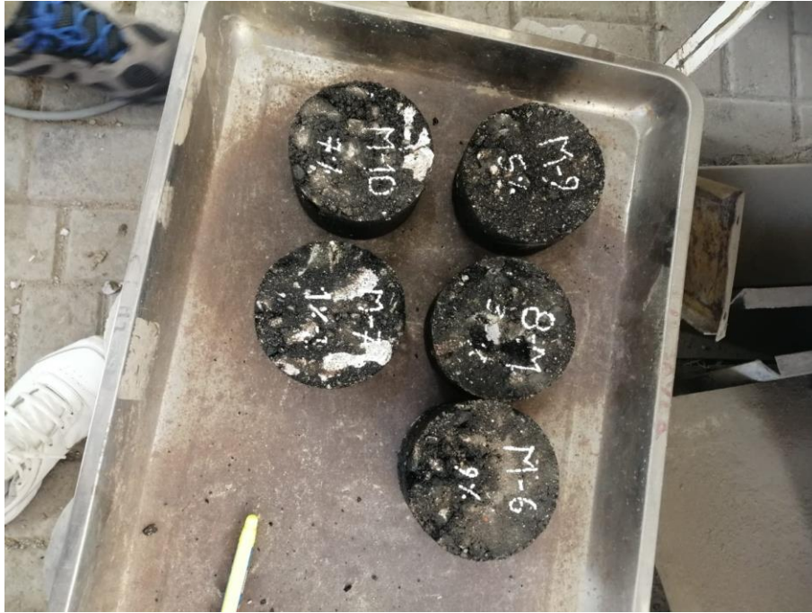
Figura 12 Muestras Extraídas para Tomar Lecturas de Volúmenes.
