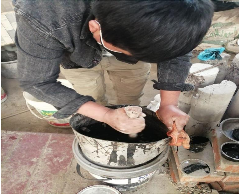
Figura 6 Homogenizando el Asfalto con el Agregado
