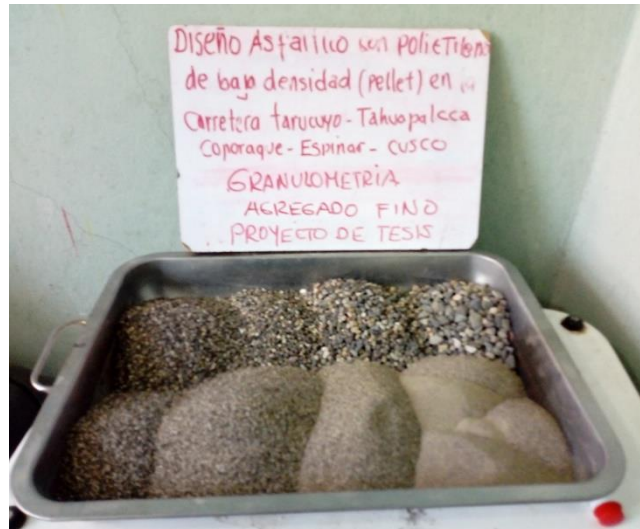
Figura 10 Gradación de Agregado Fino.
