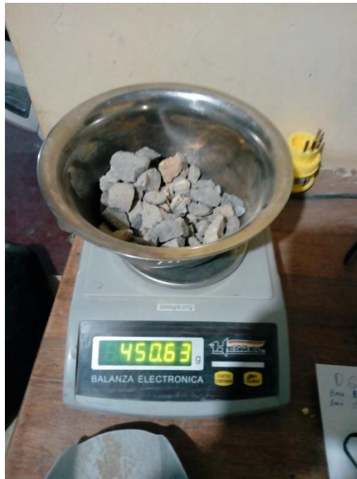
Figura 3 Peso de Agregado Grueso
