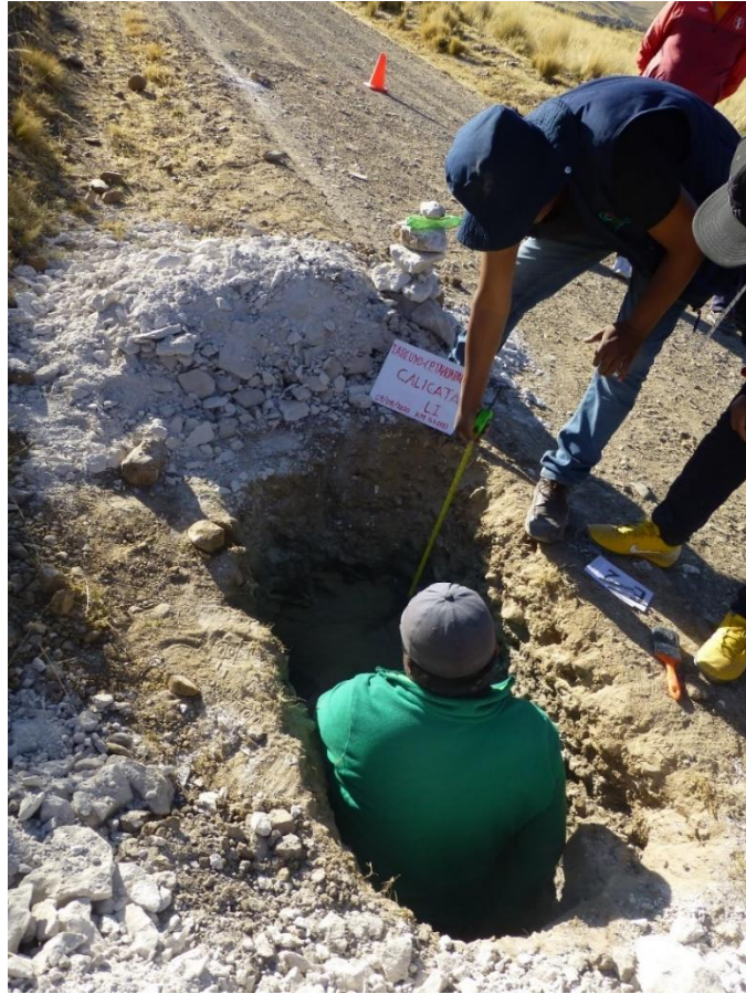
Figura 4 Midiendo las Potencias de los Estratos.
