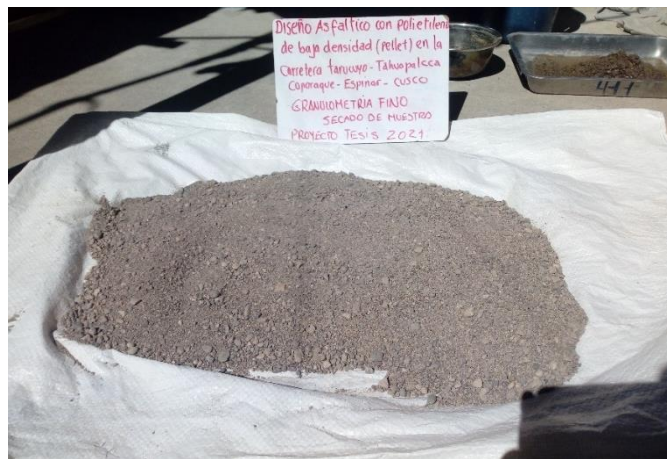
Figura 4 Seco de agregado fino TN 3/8"
