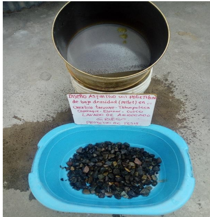
Figura 6 Lavado del Agregado Grueso por el Tamiz # 200.
