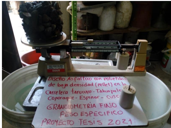
Figura 21 Peso Semiseco de Agregado Grueso
