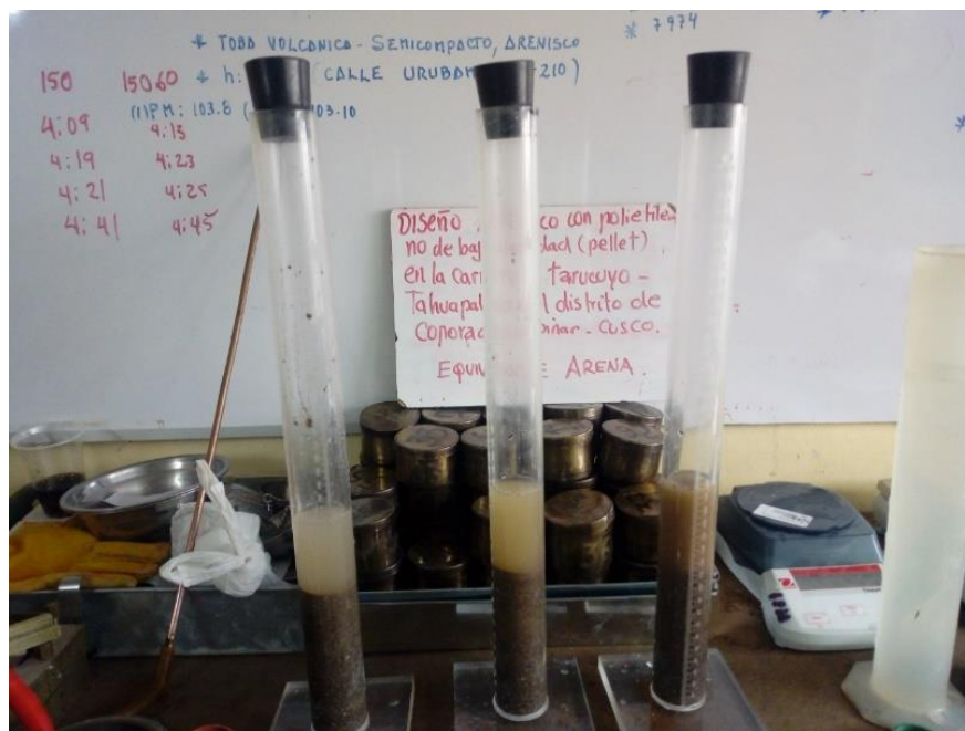
Figura 27 Saturación del Agregado Fino
