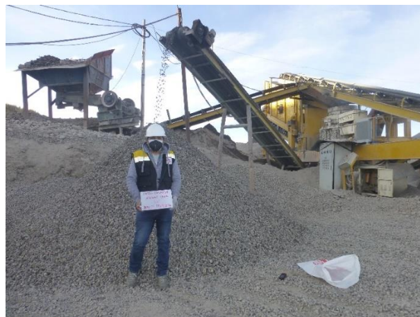
Figura 2 Muestreo de Agregado Grueso TN 3/4"
