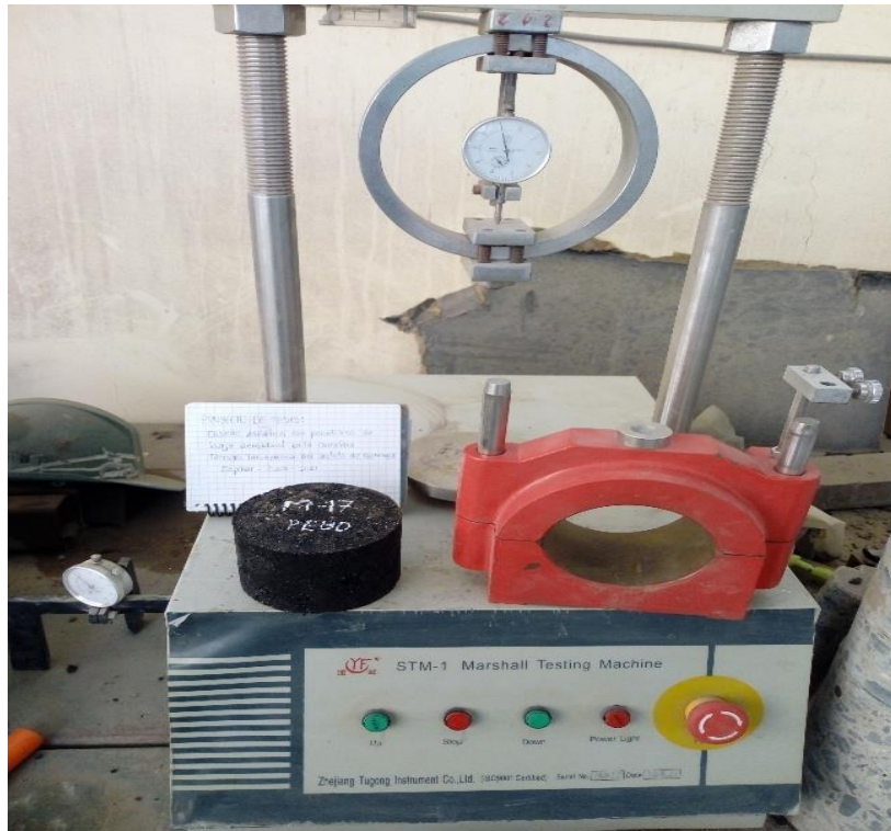
Figura 20 Muestra para ser Colocado en el Equipo Marshall
