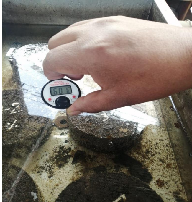
Figura 18 Toma de Temperatura al Baño María
