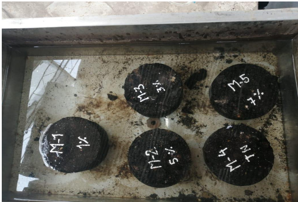
Figura 17 Briquetas Sumergidos para Baño María.
