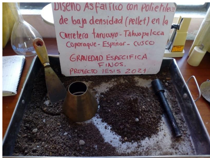
Figura 16 Humedad Óptima para Ensayo de P.E.
