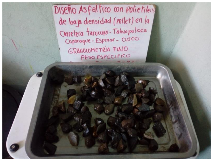
Figura 22 Semisecado de Agregado Grueso para P.E.
