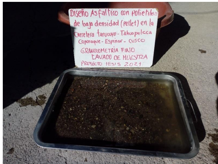
Figura 7 Lavado del agregado fino por el tamiz # 200.
