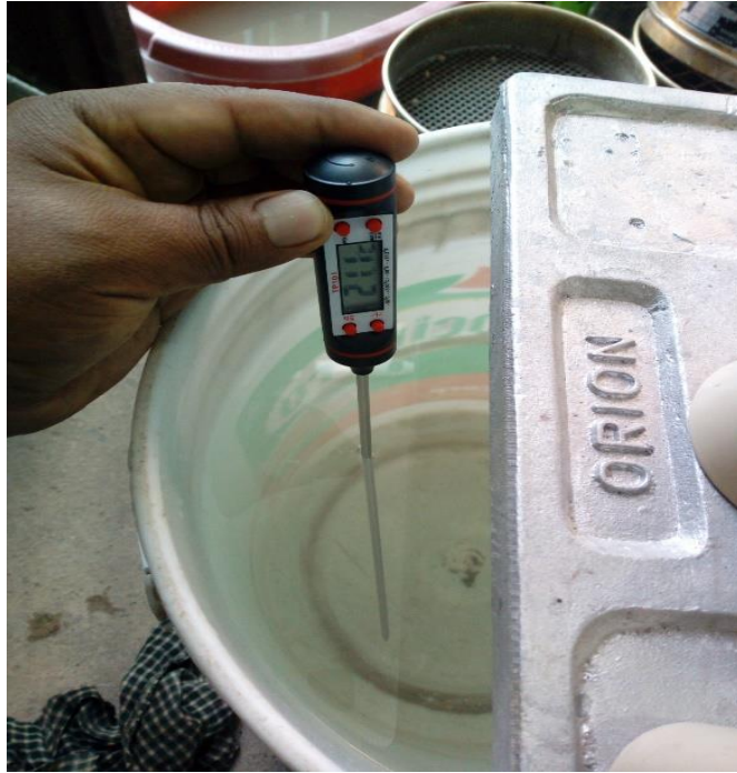
Figura 19 Toma de T° para P.E. de Agregado Grueso.
