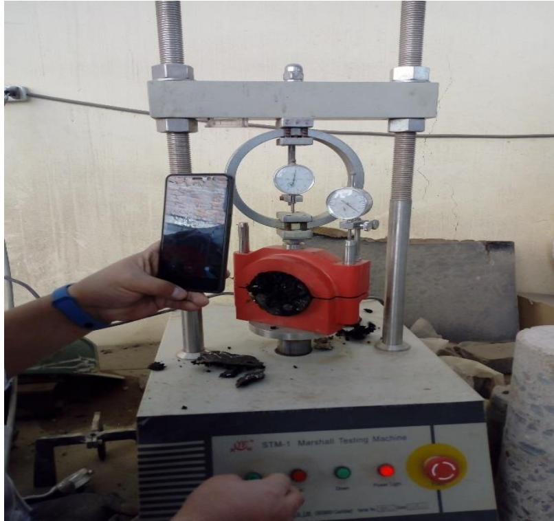
Figura 22 Equipo Marshall Realizando el Ensayo de Estabilidad y Flujo.
