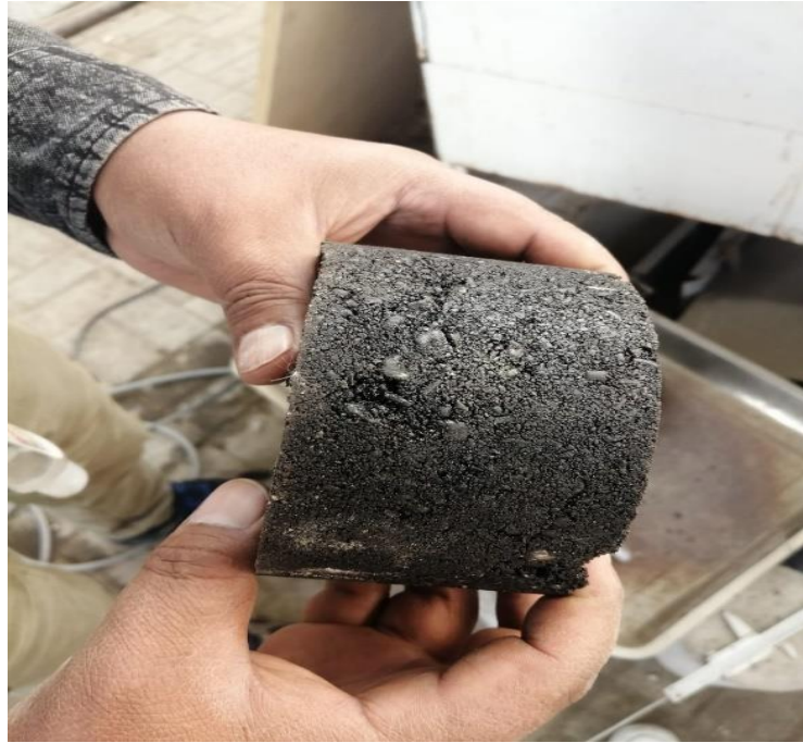
Figura 13 Verificación de las Características de la Briqueta.
