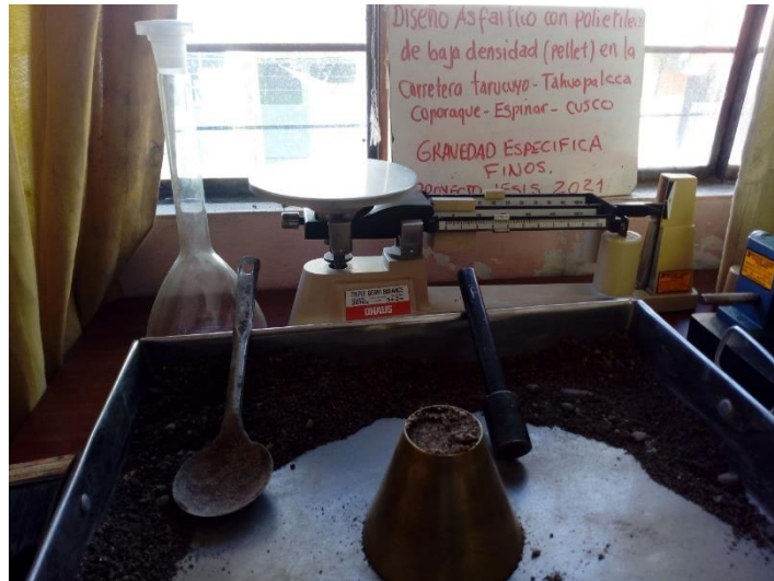
Figura 15 Ensayo de Cono para Humedad Óptima para P.E. Finos
