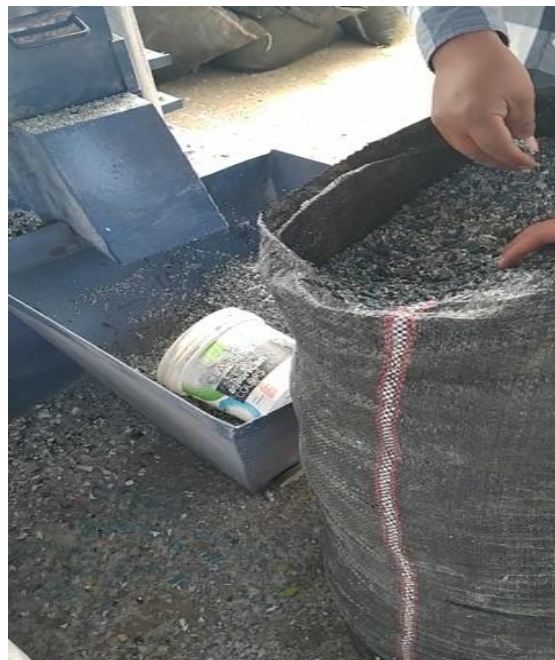
Figura 35 Molido del Polietileno de Baja Densidad
