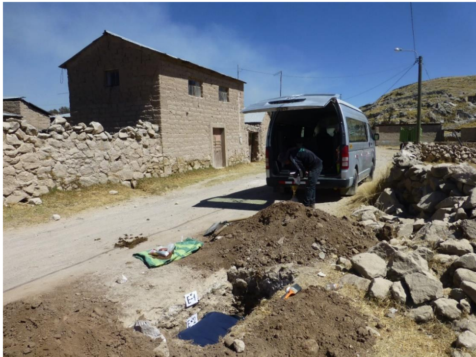
Figura 5 Apertura de Calicata para Proyecto de Tesis.
