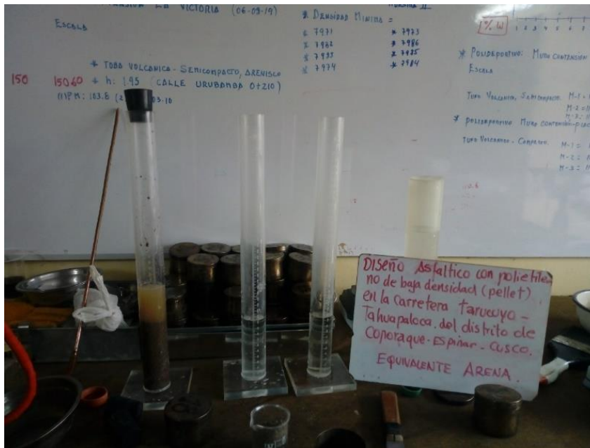
Figura 26 Ensayo de Equivalente Arena
