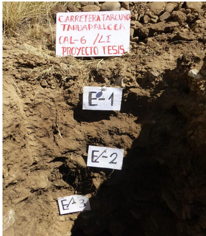
Figura 3 Calicata Mostrando los Estratos
