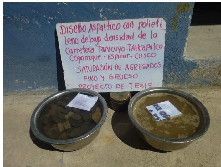
Figura 12 Saturación de los Agregados Grueso y Fino.
