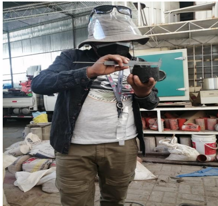
Figura 14 Lectura del Diámetro de la Briqueta.
