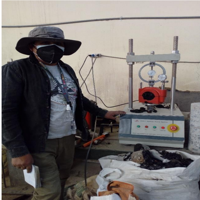
Figura 24 Tesista Realizando la Prueba Marshall.
