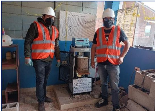
*Ensayo de Resistencia a la Compresión edad 14 días*
