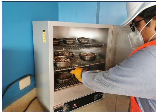
*Ensayo de Contenido de Humedad*
