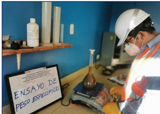
*Ensayo de Peso Específico*
