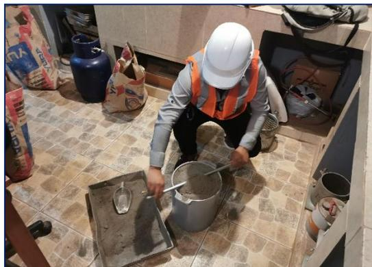
*Ensayo de Peso Específico*
