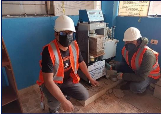
*Ensayo de Resistencia a la Compresión edad 7 días*
