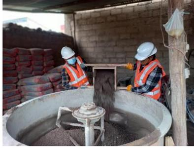
9. Una vez que los materiales se integraron de forma homogénea en la mezcladora se retiran para trasladar a la bloquetera que mediante sus moldes metálicos y la acción de bridado consigue acomodar y compactar el material homogenizado obteniendo así las bloquetas patrón y con adición de mascarillas de tres pliegues y protectores faciales
