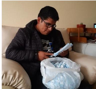
7. Se continuo tomando porciones de mascarillas y protectores faciales triturados para su adición en proporción de 1.5%,3.0%,4.5%,6.0% para la adición en unidades de bloques de concreto mediante el método de peso volumétrico en donde se pesaron cada porcentaje en volumen de adición
