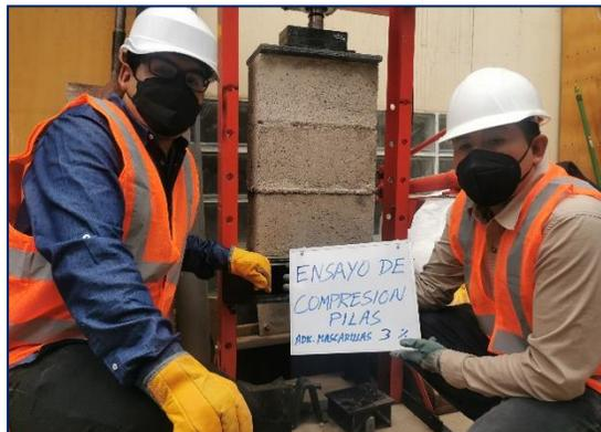
*Ensayo de Resistencia a la Compresión en muretes*
