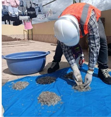
5. Una vez secado la mascarilla de tres pliegues se prosiguió a tomar muestras patrón al azar de mascarillas y guardados en envases de muestra, para su ensayo microbiológico
