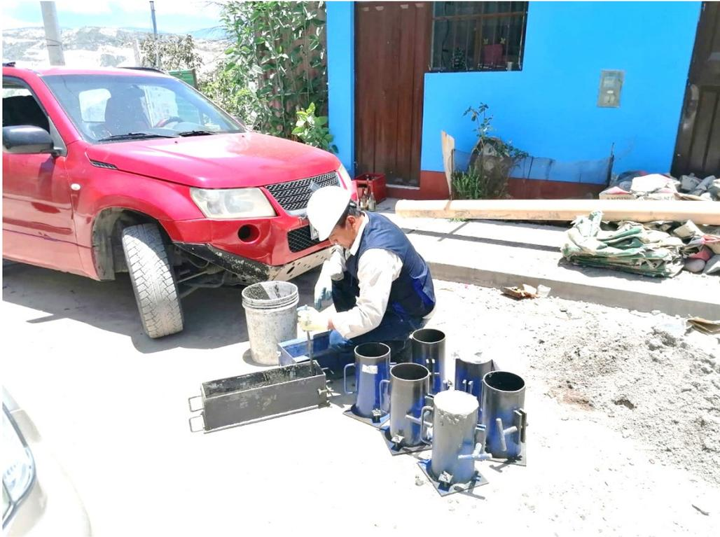
**Figura 73:** Compactado de vigas de concreto con FMC
