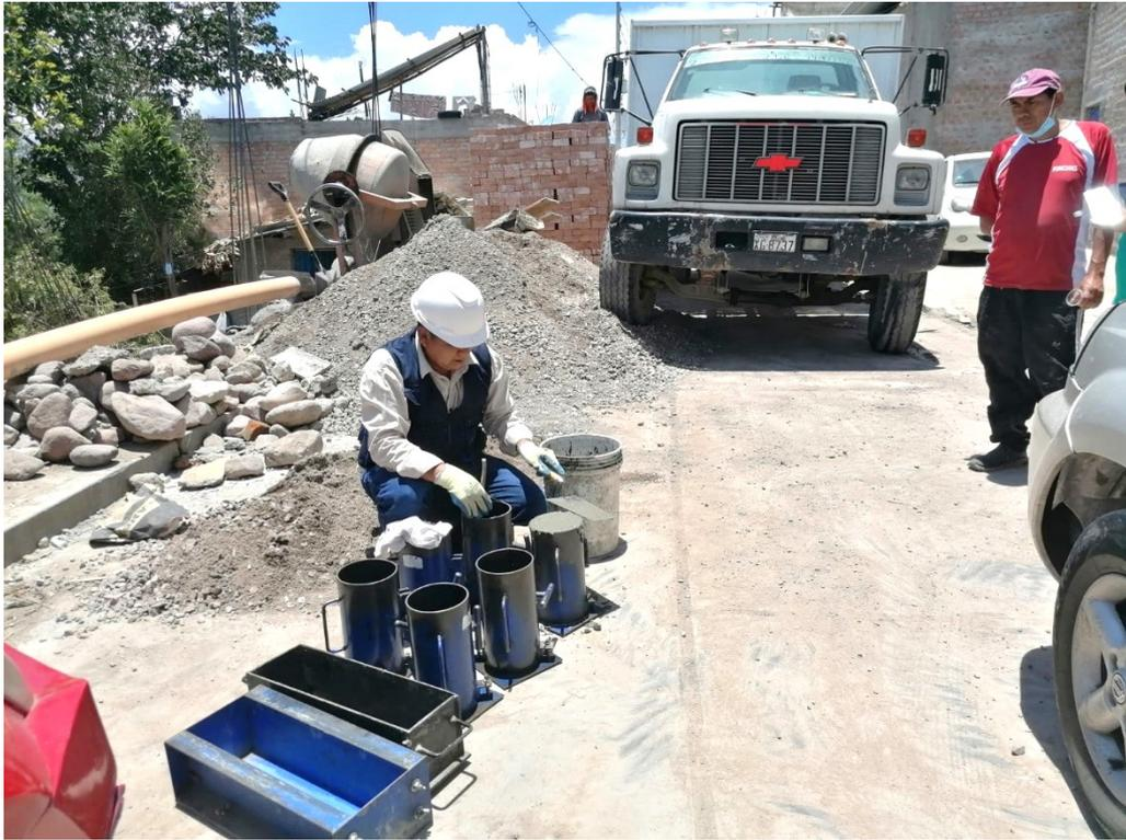
**Figura 71:** Preparación de testigos cilíndricos de concreto con FMC
