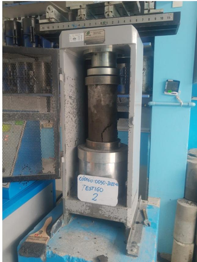
**Figura 19:** Ensayo de resistencia a la compresión axial a los 14 días
