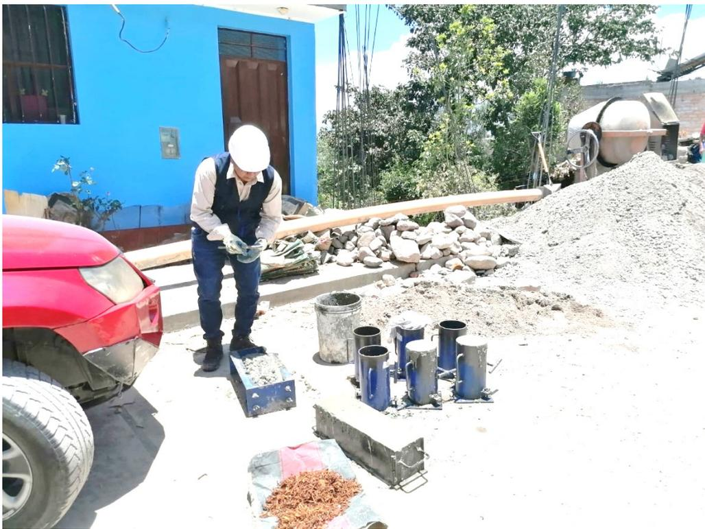
**Figura 72:** Preparación de vigas de concreto con FMC
