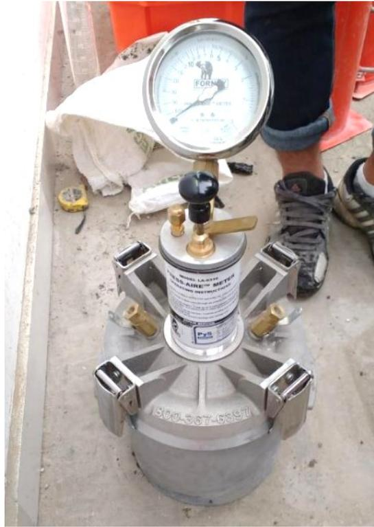
**Figura 69:** Ensayo de Contenido de aire
