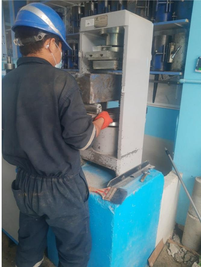
**Figura 28:** Ensayo de resistencia a la flexión a los 28 días
