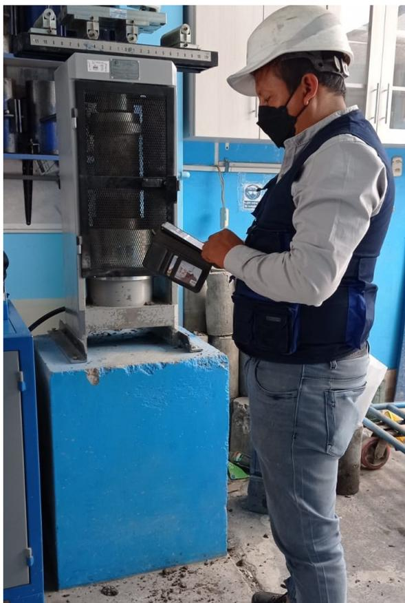
*Figura 21:* Ensayo de resistencia a la compresión axial a los 28 días
