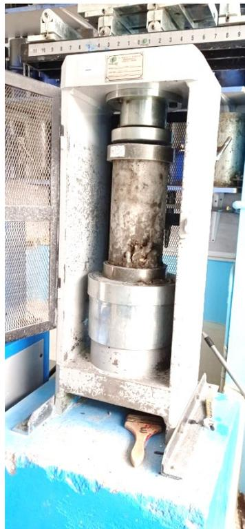
**Figura 76:** Ensayo de compresión en testigos de concreto a los 7 y 14 días con FMC
