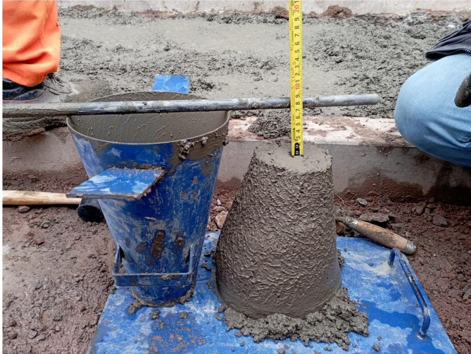
*Figura 09:* Ensayo de asentamiento del concreto
