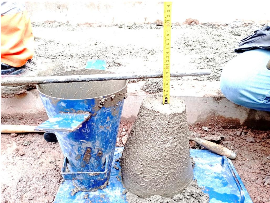
**Figura 68:** Ensayo de Slump
