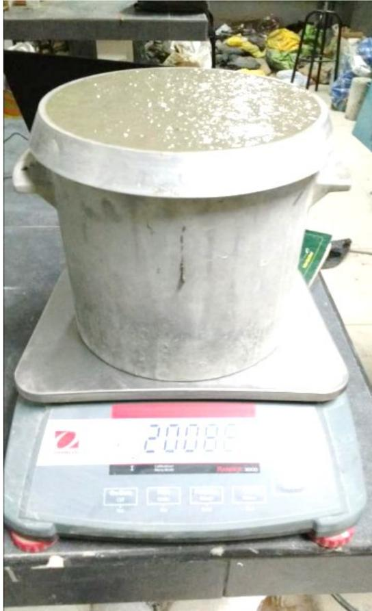
*Figura 13:* Ensayo de peso unitario del concreto
