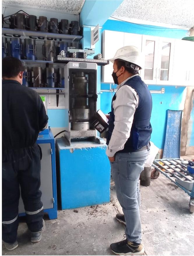
**Figura 17:** Ensayo de resistencia a la compresión axial a los 7 días
