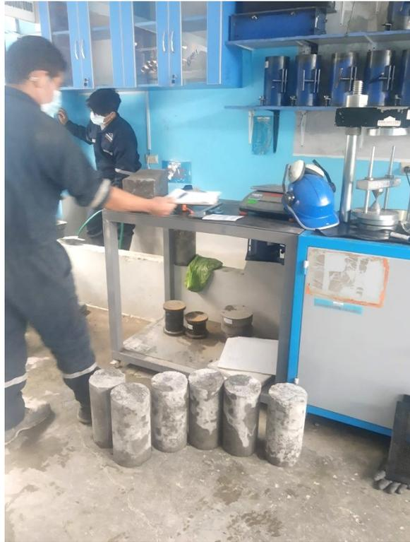
**Figura 75:** Ensayo de dimensionamiento de testigos y vigas de concreto con FMC
