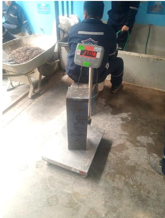
**Figura 74:** Pesado de vigas de concreto
