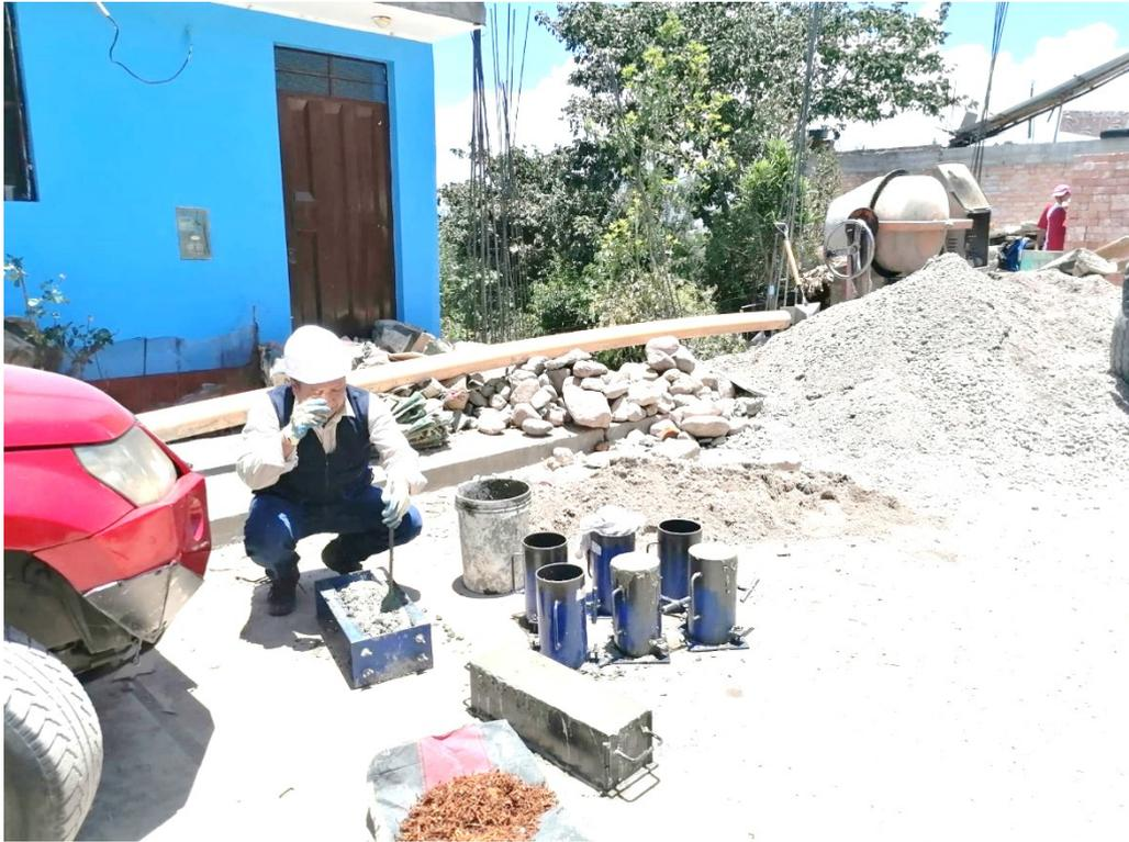
**Figura 67:** Adición de FMC al concreto
