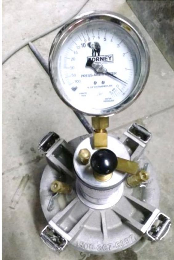
*Figura 15:* Ensayo de contenido de aire del concreto
