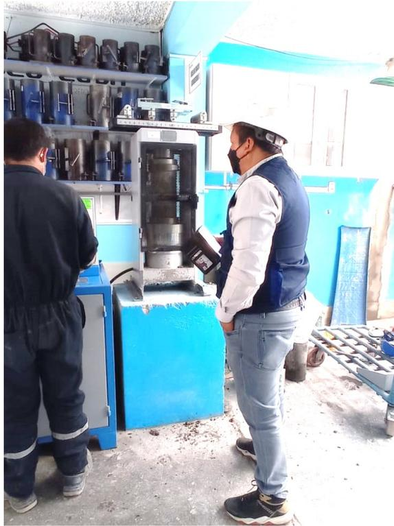
**Figura 77:** Ensayo de compresión en testigos de concreto con FMC a los 28 días
