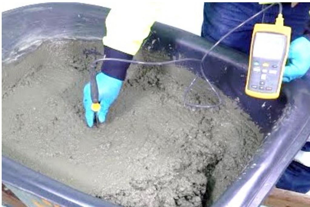
*Figura 11:* Ensayo de temperatura del concreto
