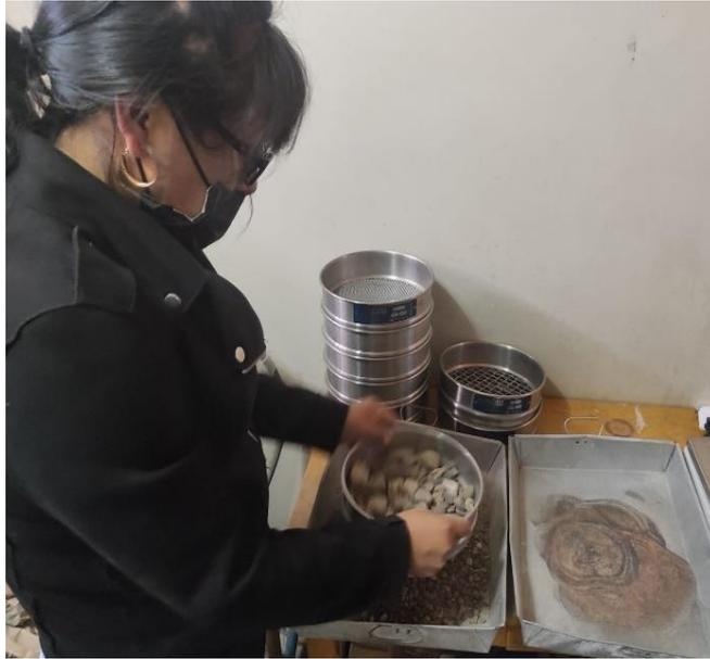
Fotografía 5. Pesado del agregado retenido en cada tamiz
