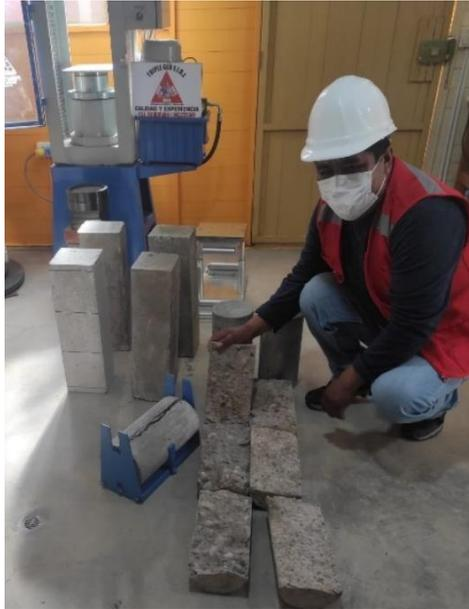
Fotografía 23. Muestras ensayadas a compresión diametral
