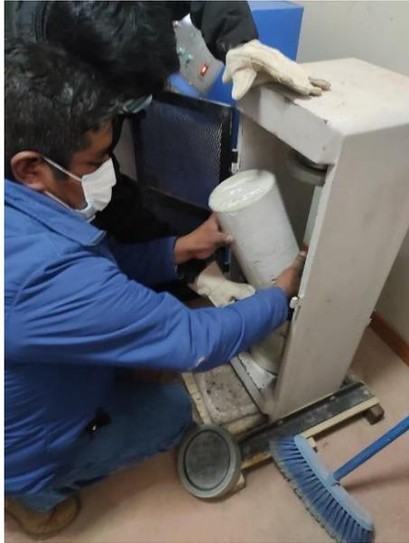
Fotografía 17. Ensayo a compresión rotura de probetas
