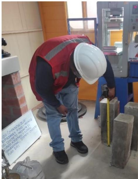
Fotografía 24. Toma de medidas de las viguetas para el ensayo de flexión
