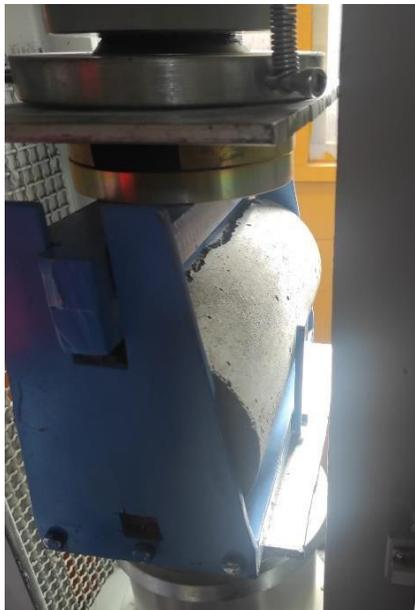
Fotografía 22. Rotura de muestra a compresión diametral
