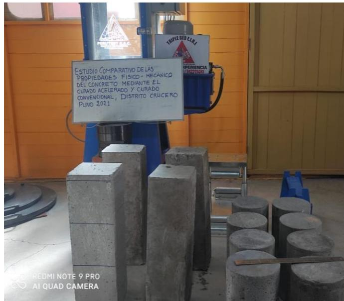
Fotografía 19. Muestras para ensayar a compresión diametral y flexión
