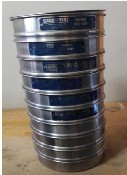
Fotografía 4. Tamizado del agregado
