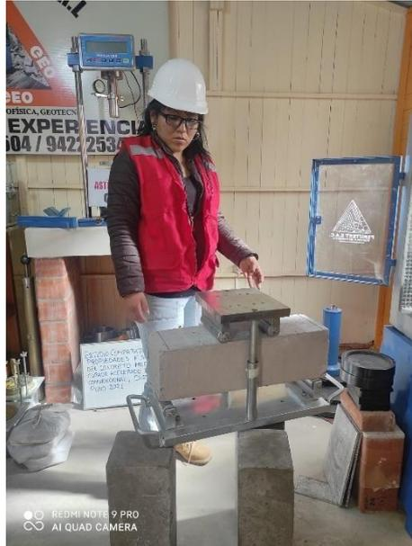
Fotografía 25. Vigüeta para el ensayo a flexión
