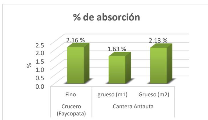
**Figura 14** porcentaje de absorción de las canteras Faycopata y Antauta
