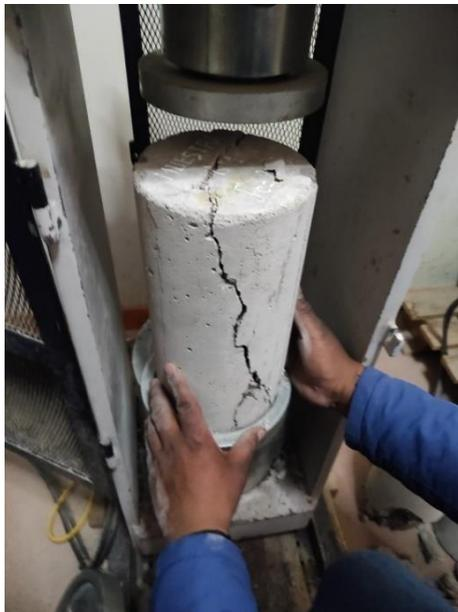
Fotografía 18. Muestra ya ensayada a compresión
