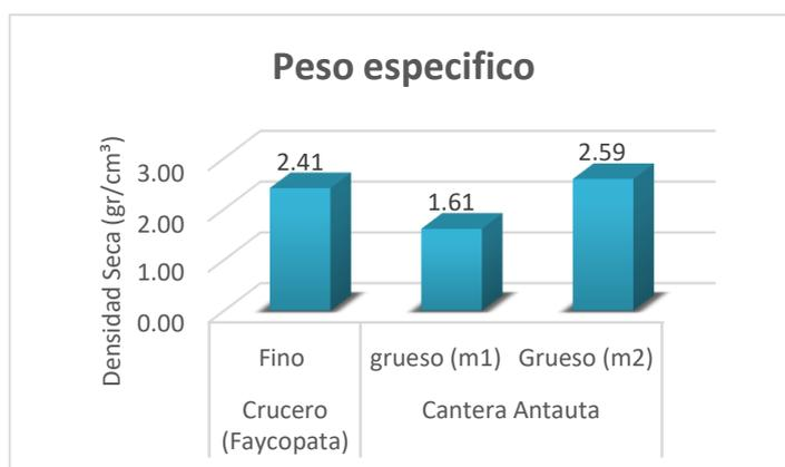
**Figura 13** Peso específico de las canteras Faycopata y Antauta
