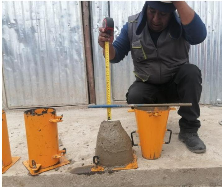
Fotografía 7. Prueba de asentamiento (slump)
