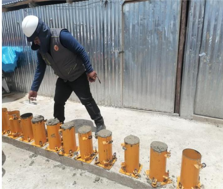
Fotografía 11. llenado y acabado de probetas de concreto
