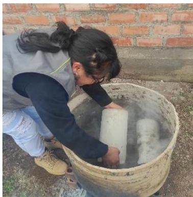
**Figura 8** Curado acelerado
