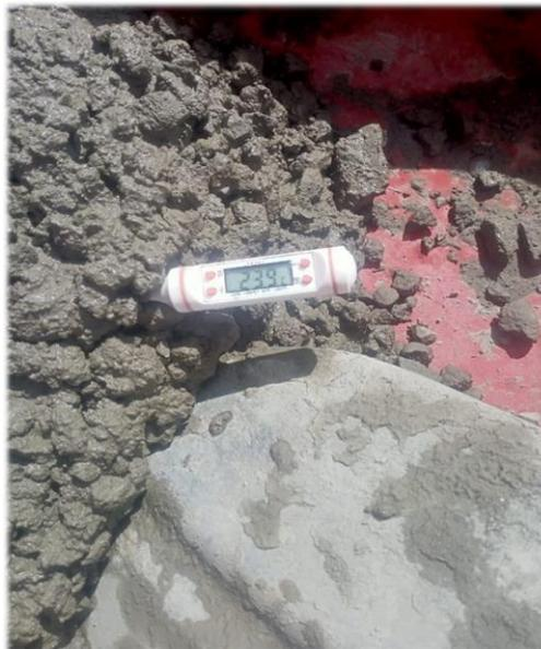
Fotografía 8. Toma de temperatura del concreto
