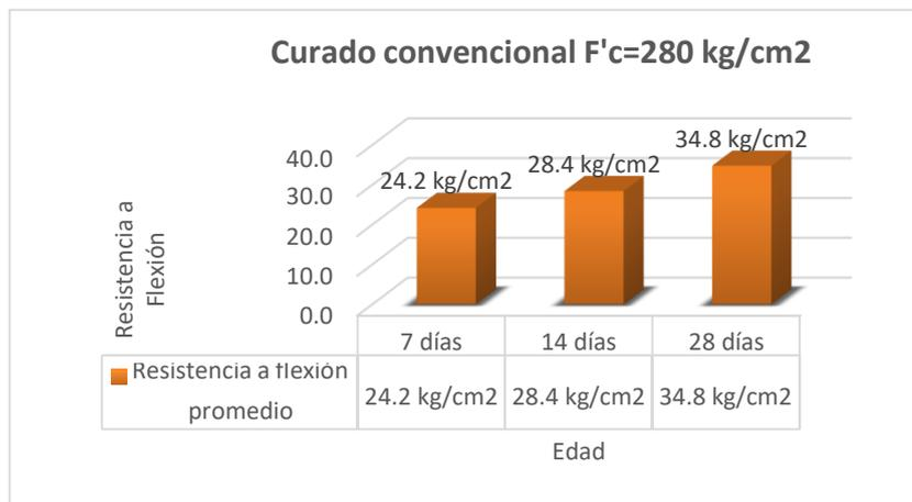
**Figura 44** Resistencia a la flexión a los 7, 14 y 28 días
