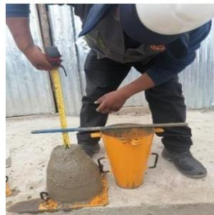
**Figura 6** Medición de asentamiento
