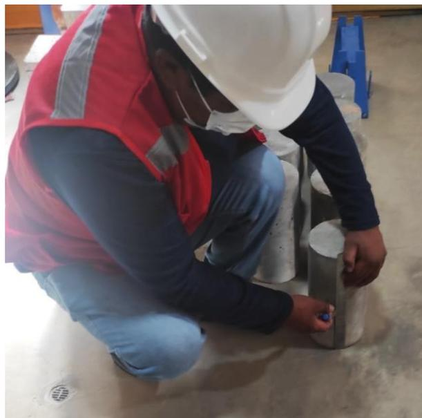
Fotografía 20. Toma de medidas de las muestras de concreto
