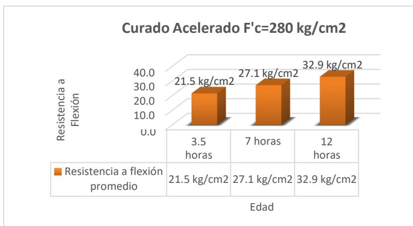
**Figura 45** Resistencia a la flexión a las 3.5, 7 y 12 horas
