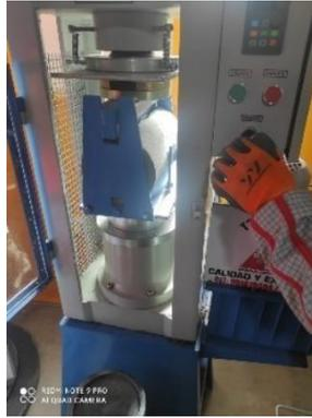
**Figura 10** Ensayo compresión diametral
