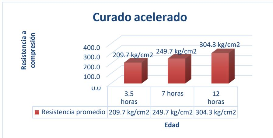
**Figura 23** Esfuerzo a la rotura a las 3.5, 7 y 12 horas
