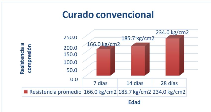
**Figura 24** Esfuerzo a la rotura a los 7, 14 y 28 días
