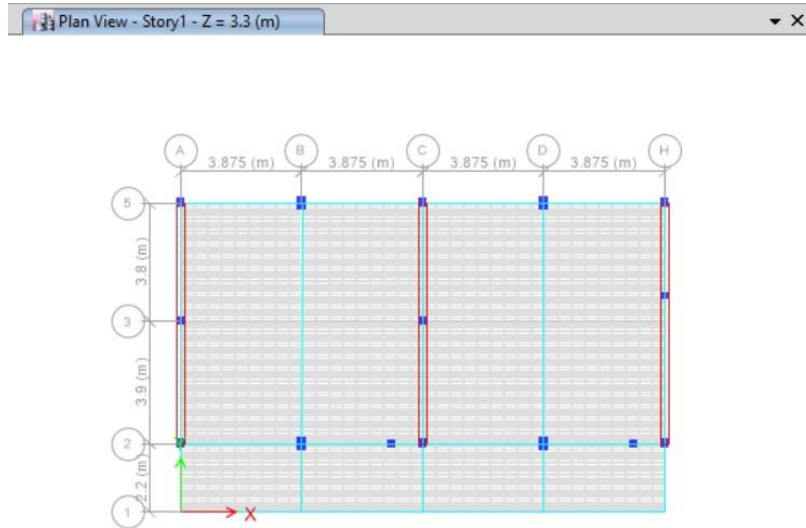
Figura 79: Planta de primer nivel en Etabs 2016.
