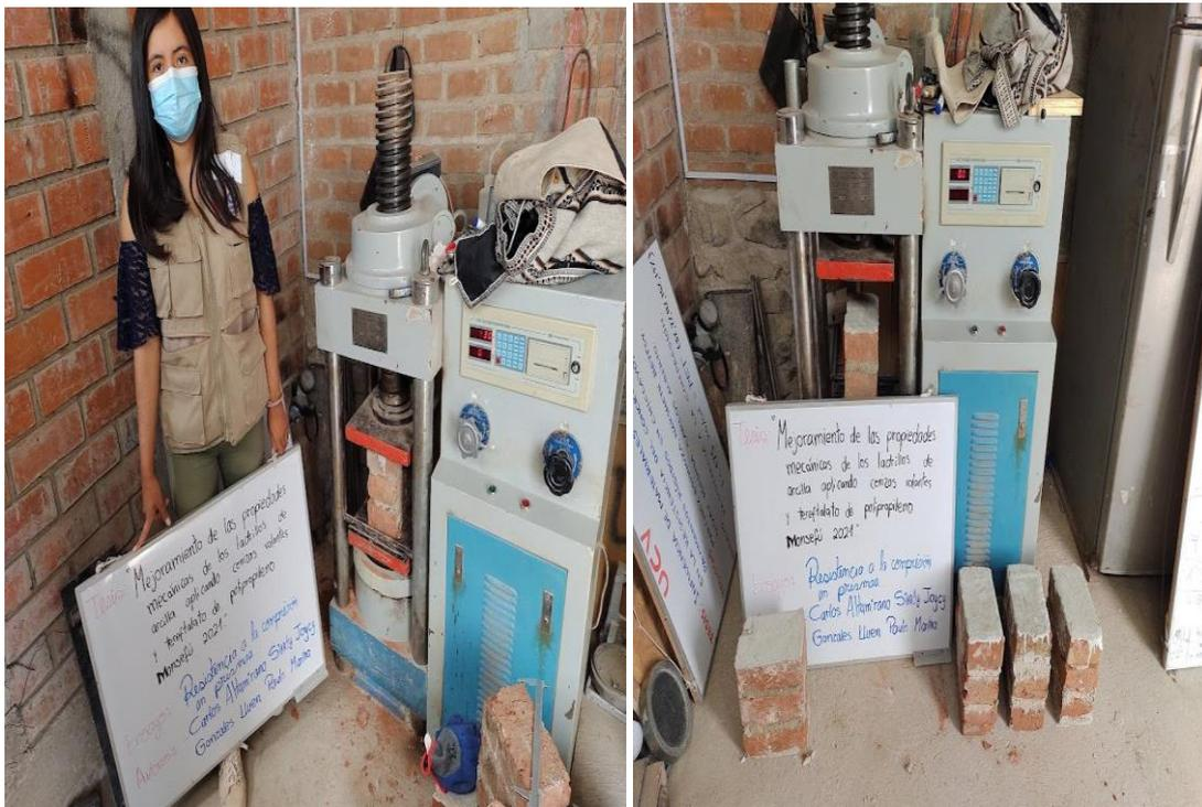
Descripción: Realización del ensayo de resistencia a la compresión en prismas
