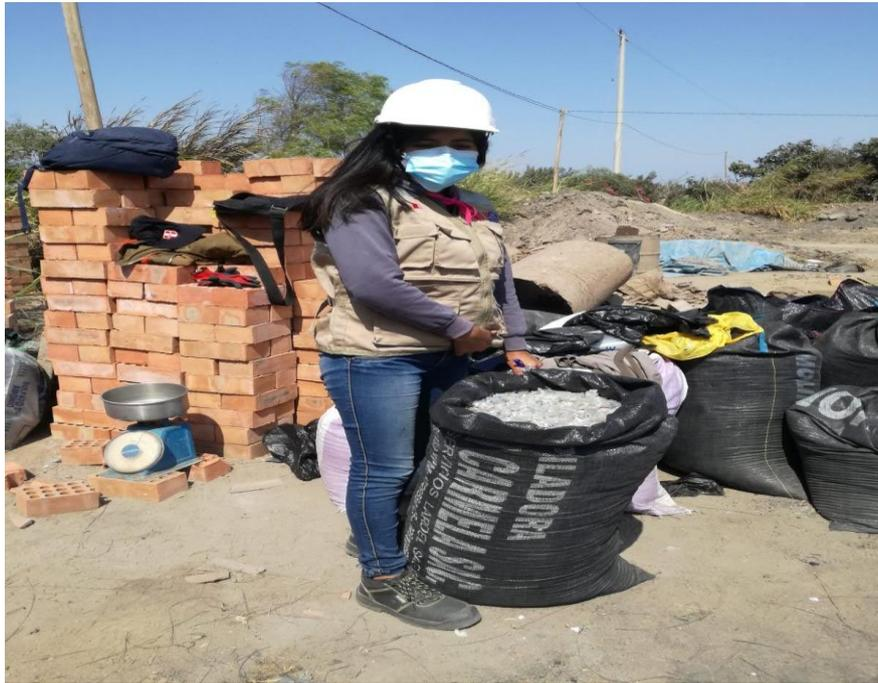
Descripción: En la figura podemos ver el PET triturado que fue utilizado en las mezclas a ensayar de los ladrillos de arcilla.
