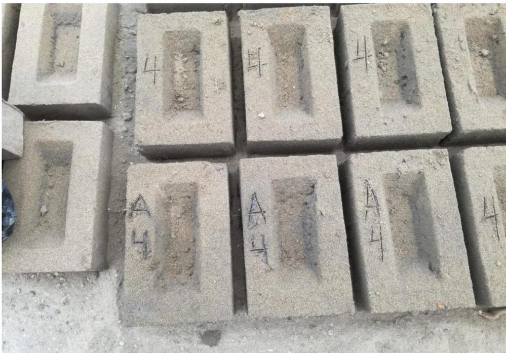
Descripción: En la figura podemos ver los ladrillos tipo A4 que contiene 6% de PET y 15% de cenizas volantes.
