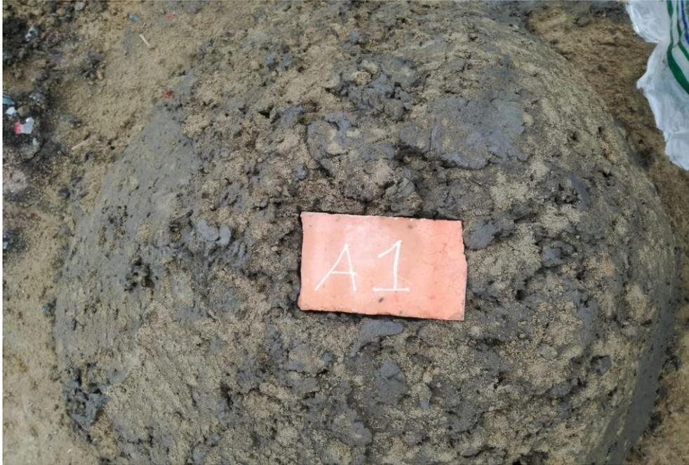
Descripción: En la figura podemos ver la mezcla A1 que contiene 3% de PET y 15% de cenizas volantes.
