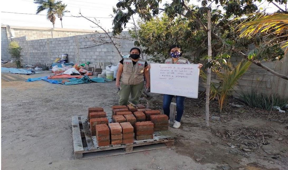
Descripción: En la figura podemos observar el secado de las pilas para posteriormente realizar el ensayo de resistencia a la compresión en prismas.
