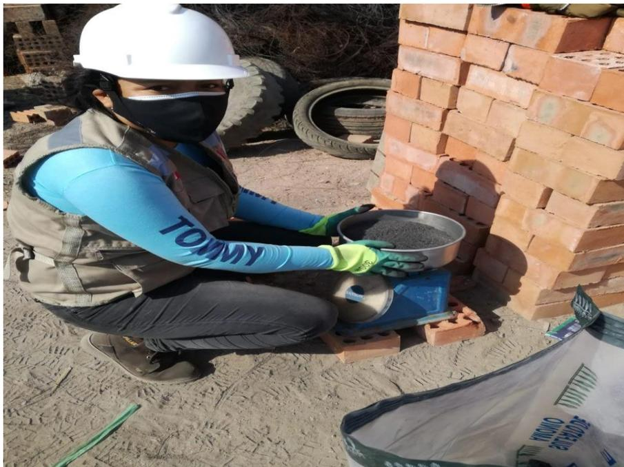
Descripción: En la figura podemos ver la ceniza volante que fue utilizado en las mezclas a ensayar de los ladrillos de arcilla.
