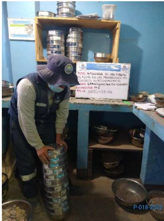
Fotografía 3. Granulometría de agregado fino
