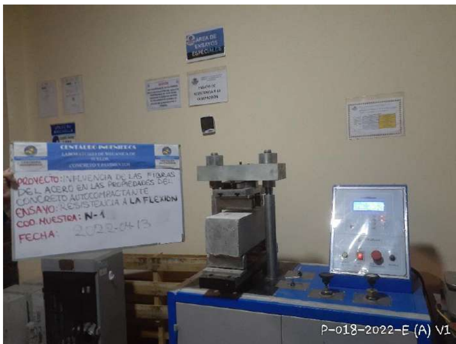
Fotografía 22. Ensayo de resistencia a flexión
