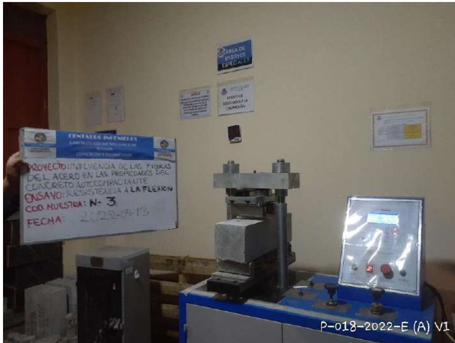
Fotografía 21. Ensayo de resistencia a flexión
