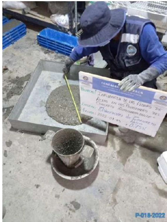
Fotografía 15. Prueba de extensión de flujo Fuente: Laboratorio Centauro Ingenieros.
