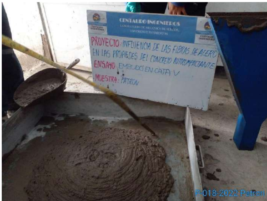
Fotografía 16. Prueba V-Funnel Fuente: Laboratorio Centauro Ingenieros.
