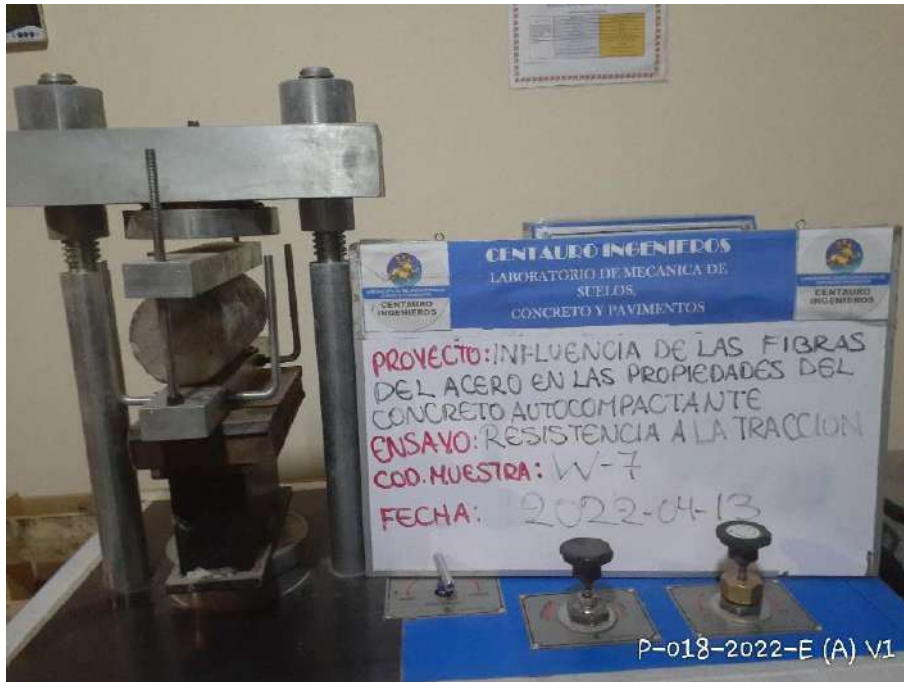
Fotografía 19. Ensayo de resistencia a tracción indirecta
