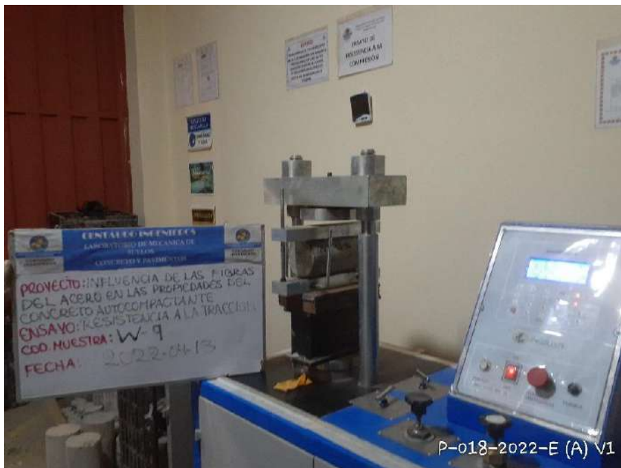
Fotografía 20. Ensayo de resistencia a tracción indirecta
