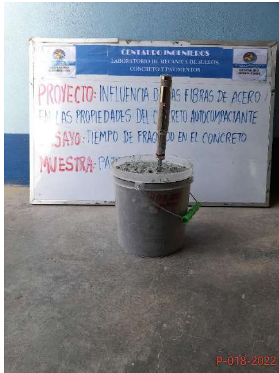
Fotografía 13. Ensayo de tiempo de fraguado
