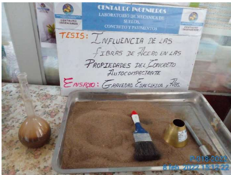
Fotografía 8. Gravedad específica y absorción
