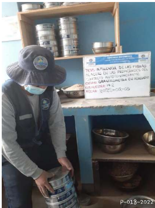
Fotografía 4. Granulometría de agregado grueso
