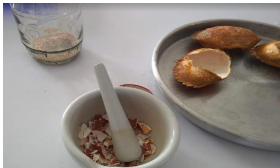
Figura 6. Molienda de los caparazones del camarón y tamizado
