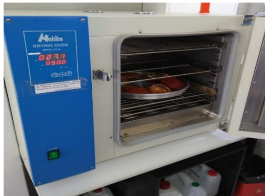
Figura 5. Secado en la estufa de los caparazones de cangrejo.
