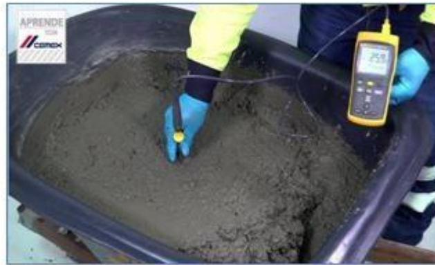
Figura 8. Ensayo para determinar la temperatura del concreto
