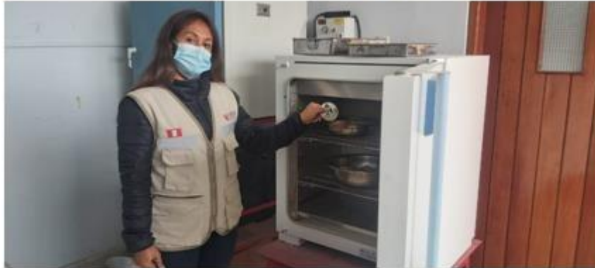
Figura 27. Determinación del contenido de humedad del agregado fino
