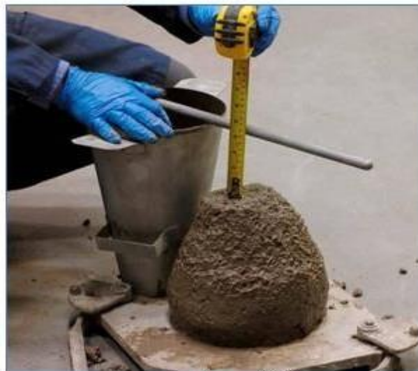
Figura 10. Asentamiento del concreto slump
