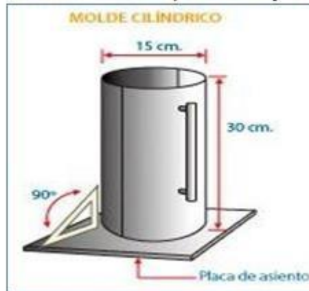
Figura 13. Probeta cilíndrica para ensayo de compresión
