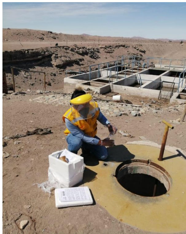
Figura 21 Toma de Muestra SST Ingreso a PTAR
