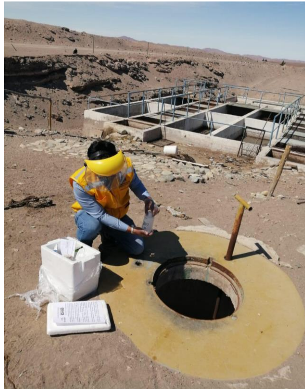
Figura 20 Toma de Muestra DQO Ingreso a PTAR Fuente: Propia
