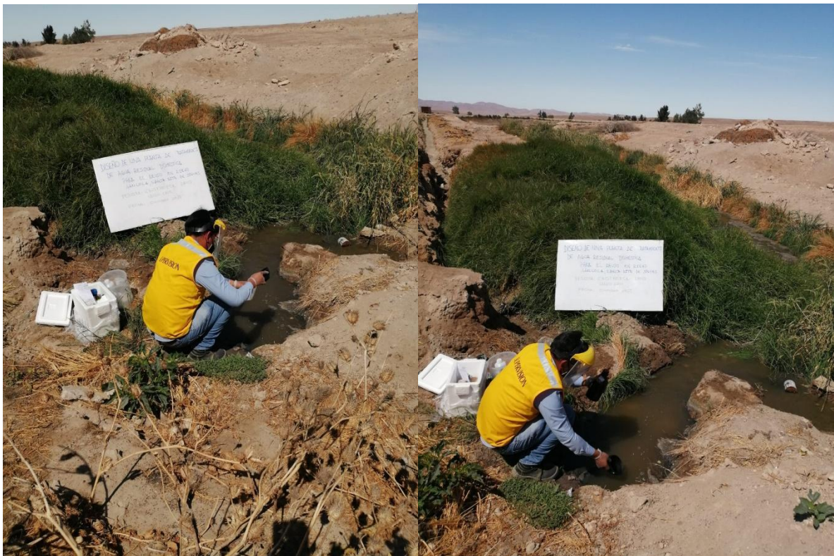
Figura 24 Toma de Muestra DQO Salida de PTAR
