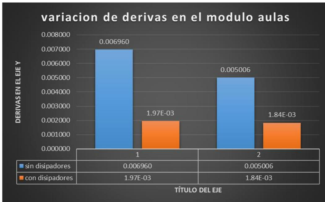
Figura 34. Variación de las derivas con los sistemas de protección sísmicas y sin ellas, Módulo Aulas, en el eje Y con 71.76 % de reducción.
