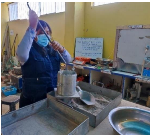
Varillado del agregado
