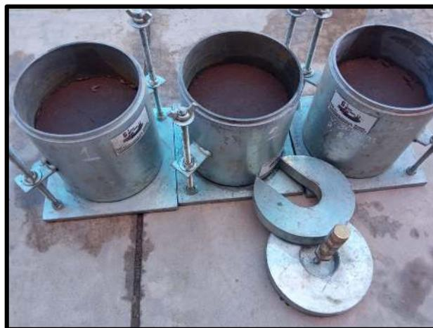
Preparación de la muestra para el ensayo de penetración.
