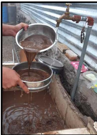
**Figura 15.** Tamizado por el lavado de material fino.
