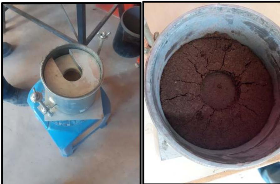
Estado de las muestras después del ensayo de penetración.
