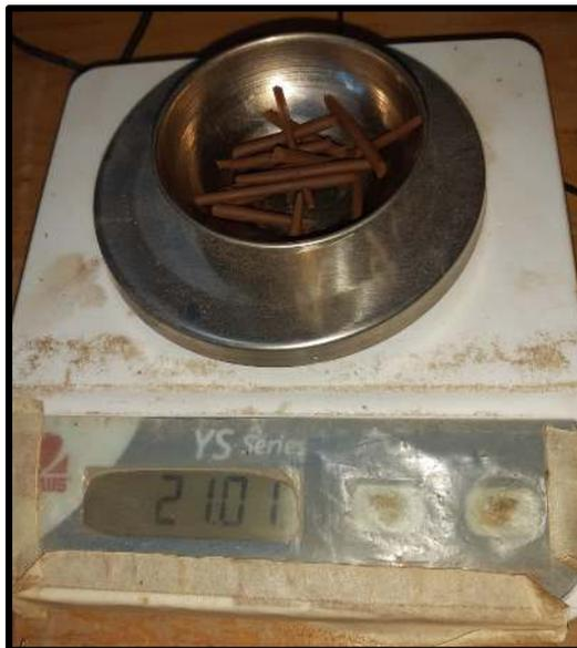
Pesaje de la muestra que paso del estado plástico al semisólido.
