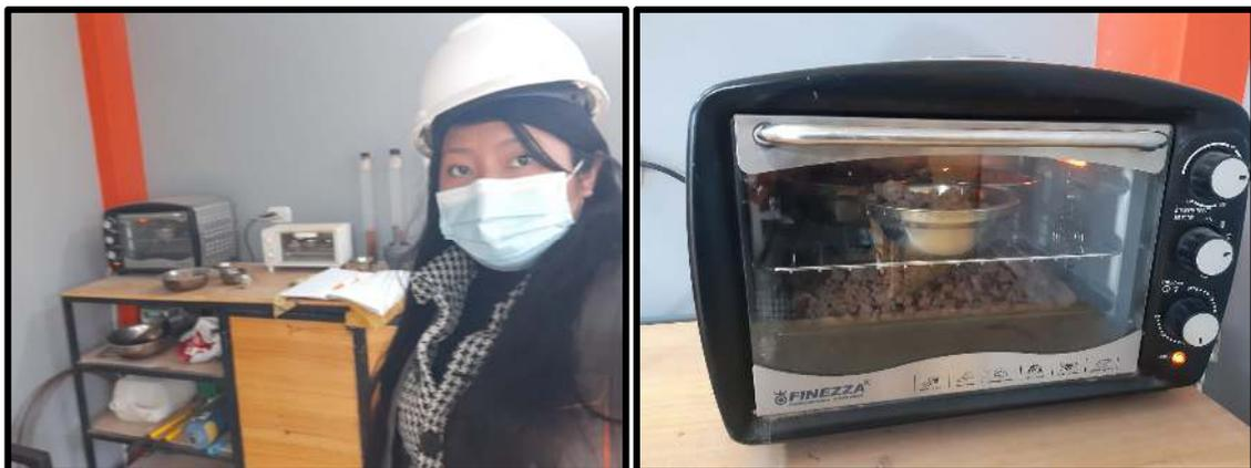
Secado de las muestras mediante la adición de calor brindado por el horno.
