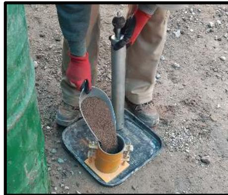
Preparación de la muestra e instrumentos para el ensayo de Proctor Estándar.
