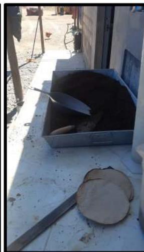
Instrumentos y muestra para el ensayo del CBR.
