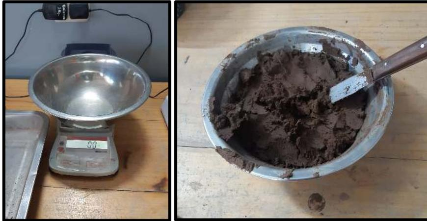
Equipo y muestra de suelo para el análisis de limite plástico.
