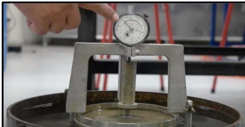
**Figura 8.** *Trípode de expansión para CBR con dial.*
