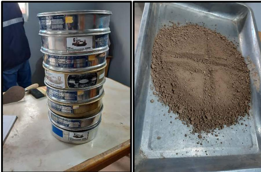
Equipos y muestra para el análisis granulométrico.
