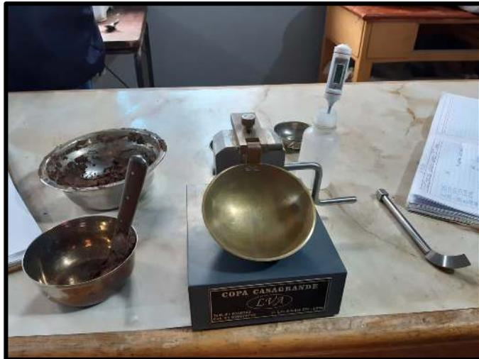
Materiales utilizados para los ensayos de límites de consistencia.
