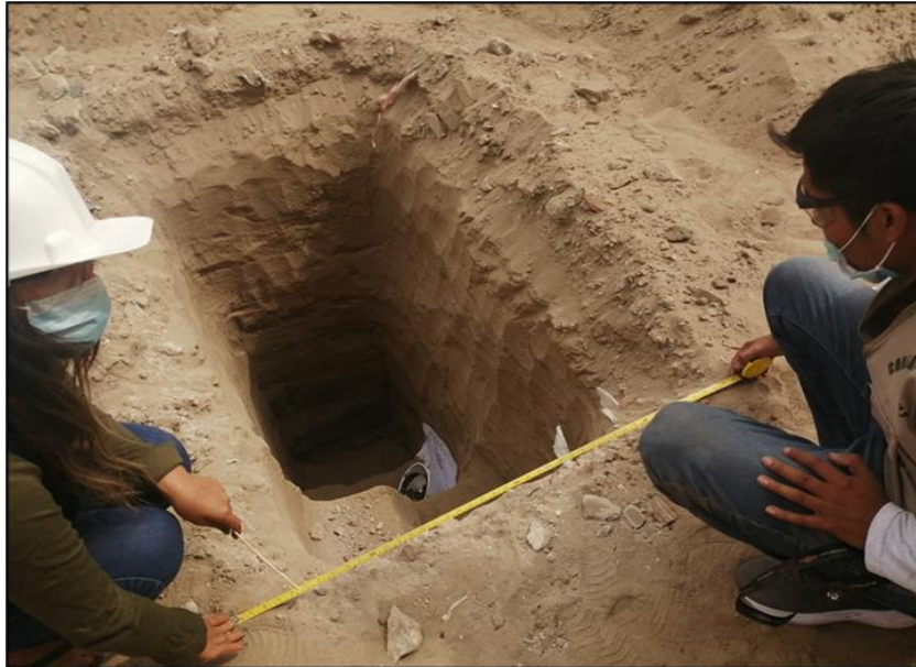
Figura 7. Verificación de las dimensiones de la calicata antes de la extracción de muestras de suelos.
