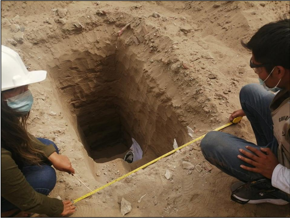
Fotografía 1. Medición de las dimensiones de la calicata.
