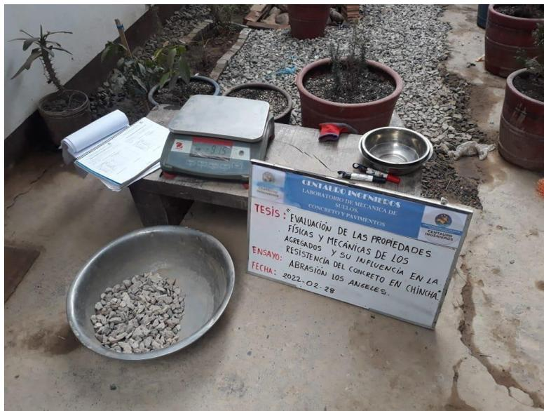
Foto N° 10.- Fotos del Ensayo Abrasión de los ángeles
