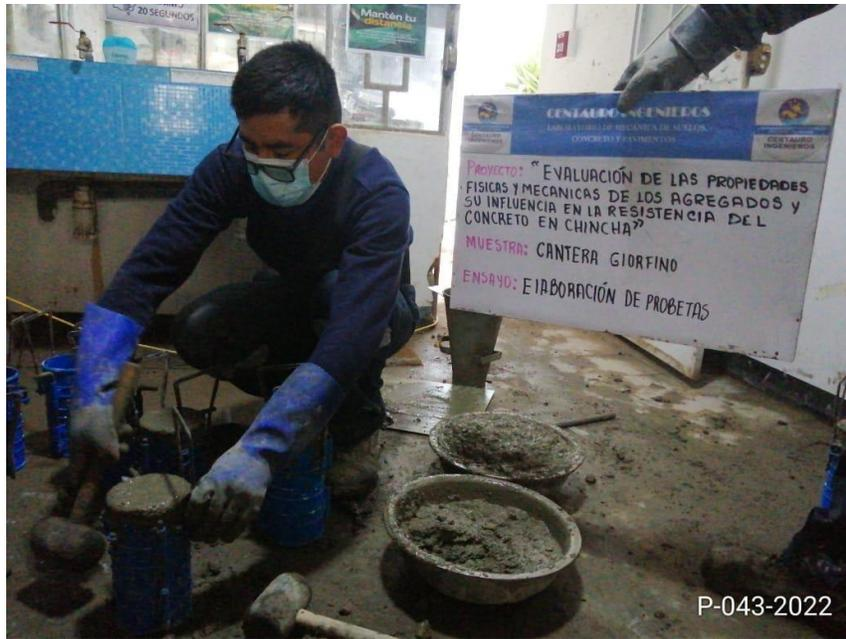
Foto N°19.- Elaboración de Probetas.
