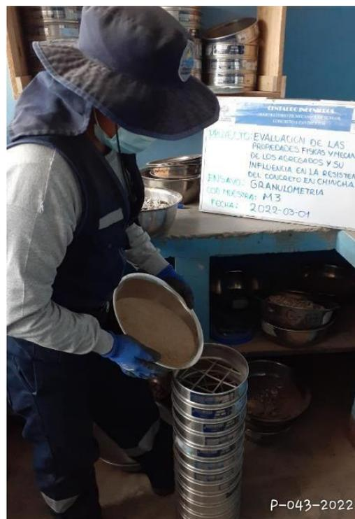
**Foto N°12.-** Análisis Granulométrico en la Cantera Bonifacio- Agregado Fino.
