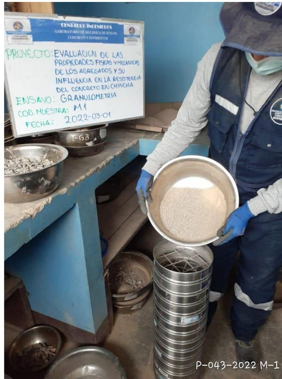
**Figura 20.- Análisis Granulométrico en la Cantera Guior Fino-Agregado Fino.**
