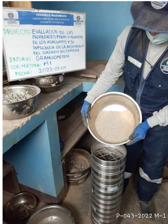
**Foto N°11.-** Análisis Granulométrico en la Cantera Guior Fino-Agregado Fino.
