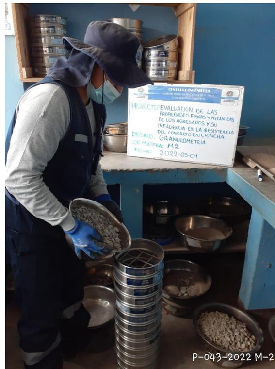
Figura 22.- Análisis Granulométrico en la Cantera Guior Fino-Agregado Grueso.
