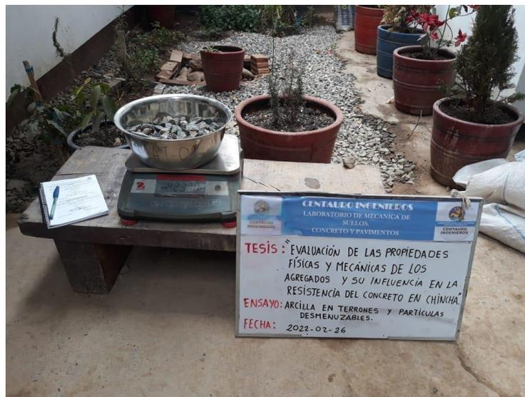
Figura 14.- Fotos del Ensayo arcilla en terrones y partículas Desmenuzables
