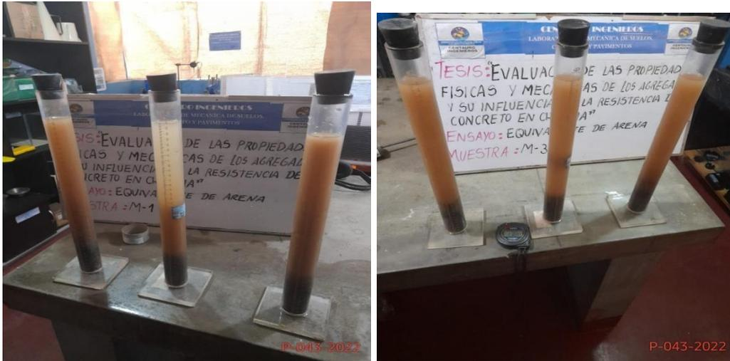
Foto N° 09.- Fotos del Ensayo Equivalente de arena para la Canteras Guior Fino(M-1) y Bonifacio (M-3)
