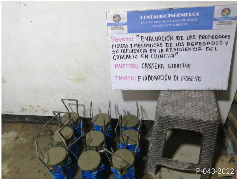
Foto N°20.- Elaboración de Probetas.
