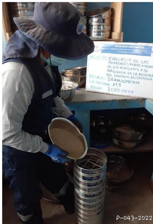
**Figura 21.- Análisis Granulométrico en la Cantera Bonifacio- Agregado Fino.**
