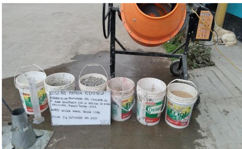
Fig. 25: Proceso de diseño mezclas con y sin adición de alambre #8.
