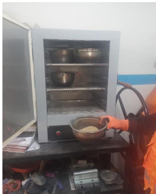
Fig. 14: Horno usado en el secado de los agregados.
