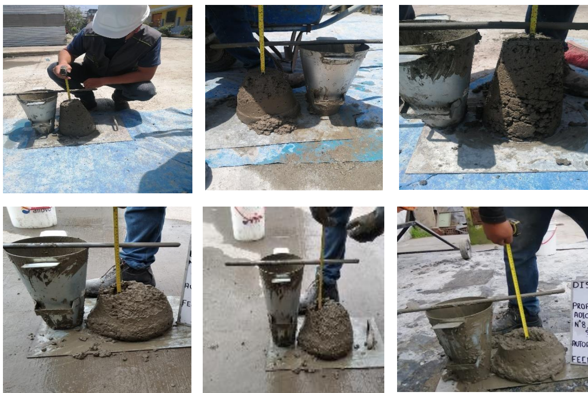
Fig. 32: Toma de datos SLUMP para diferentes diseños de mezclas de concreto.
