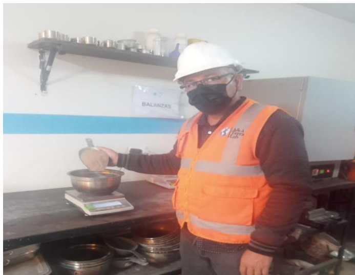
Fig. 22: Se pesan los materiales detenidos en cada malla.
