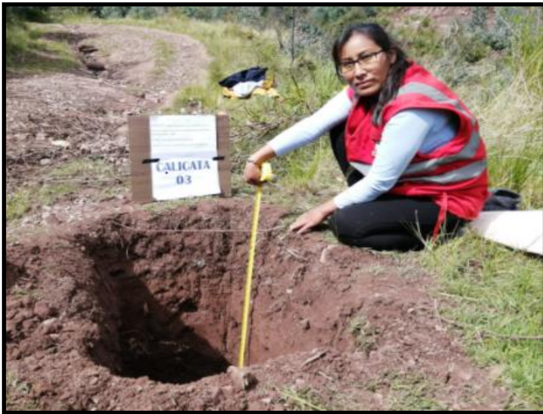
Excavación de la calicata 03, en la progresiva 2+500
