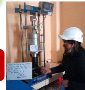
Ensayo de CBR
