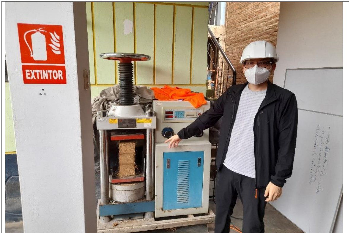
Fotografía 43. Compresión pilas adobe con 4% de Plumas de pollo
