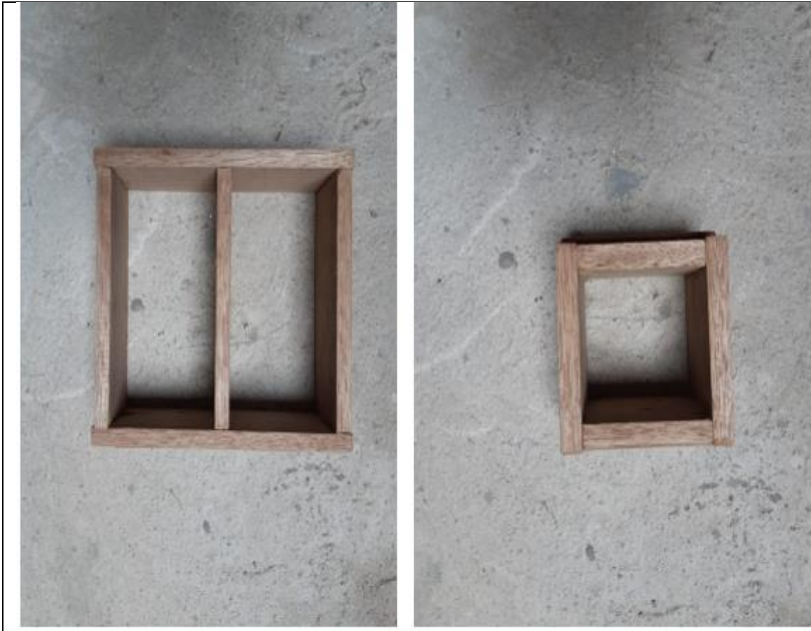
Fotografía 6. Molde de adobe rectangular de 0.12*0.24*0.11 m, Molde de adobe cubico de 0.10*0.10*0.10 m
