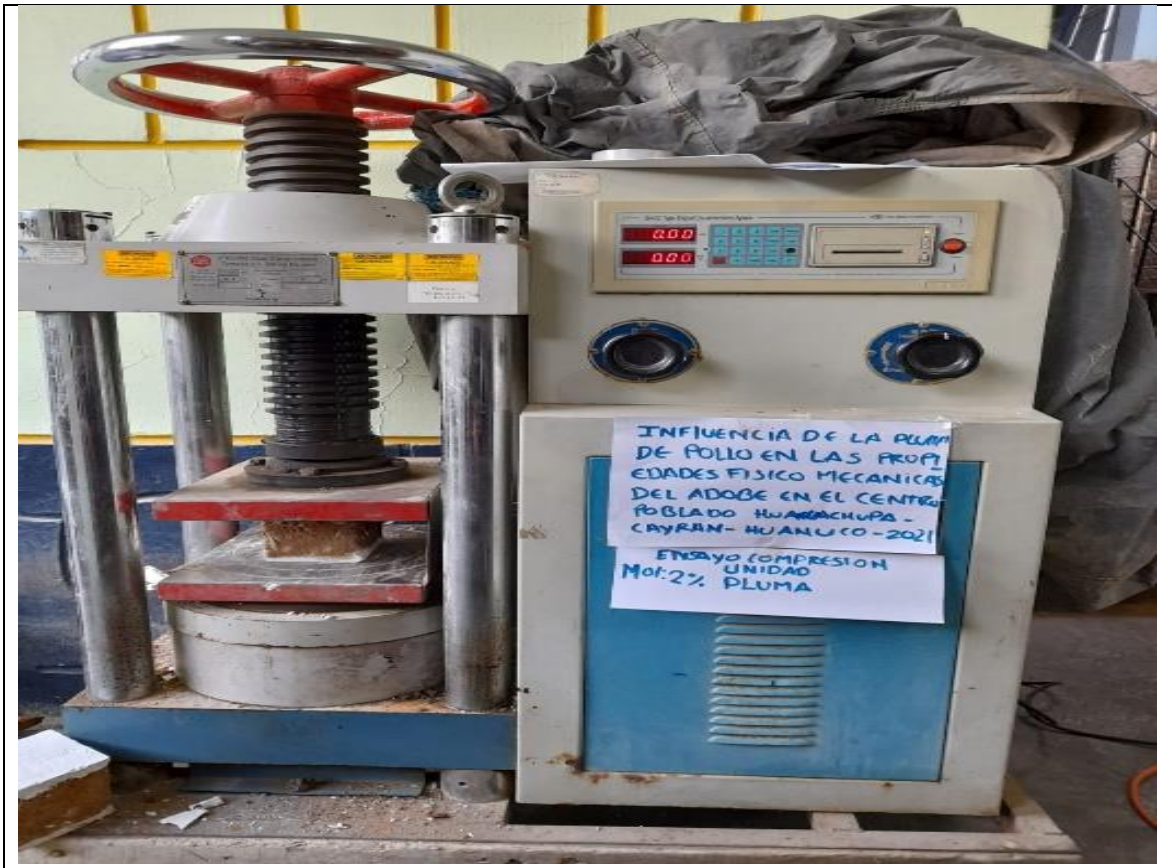
Fotografía 32. Ensayo compresión unidad 2%pluma
