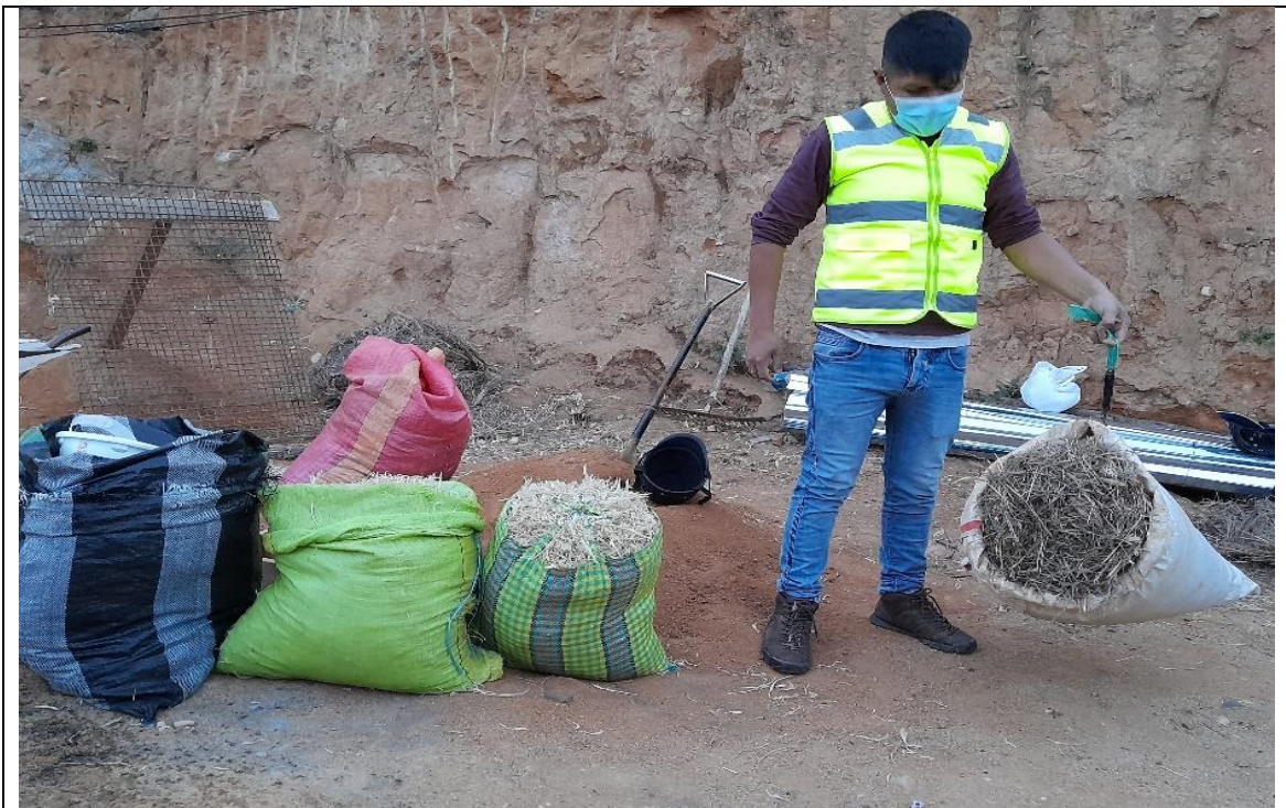
Fotografía 12. Pesaje de la paja 2 % en función a su peso, Muestra 4 patrón
