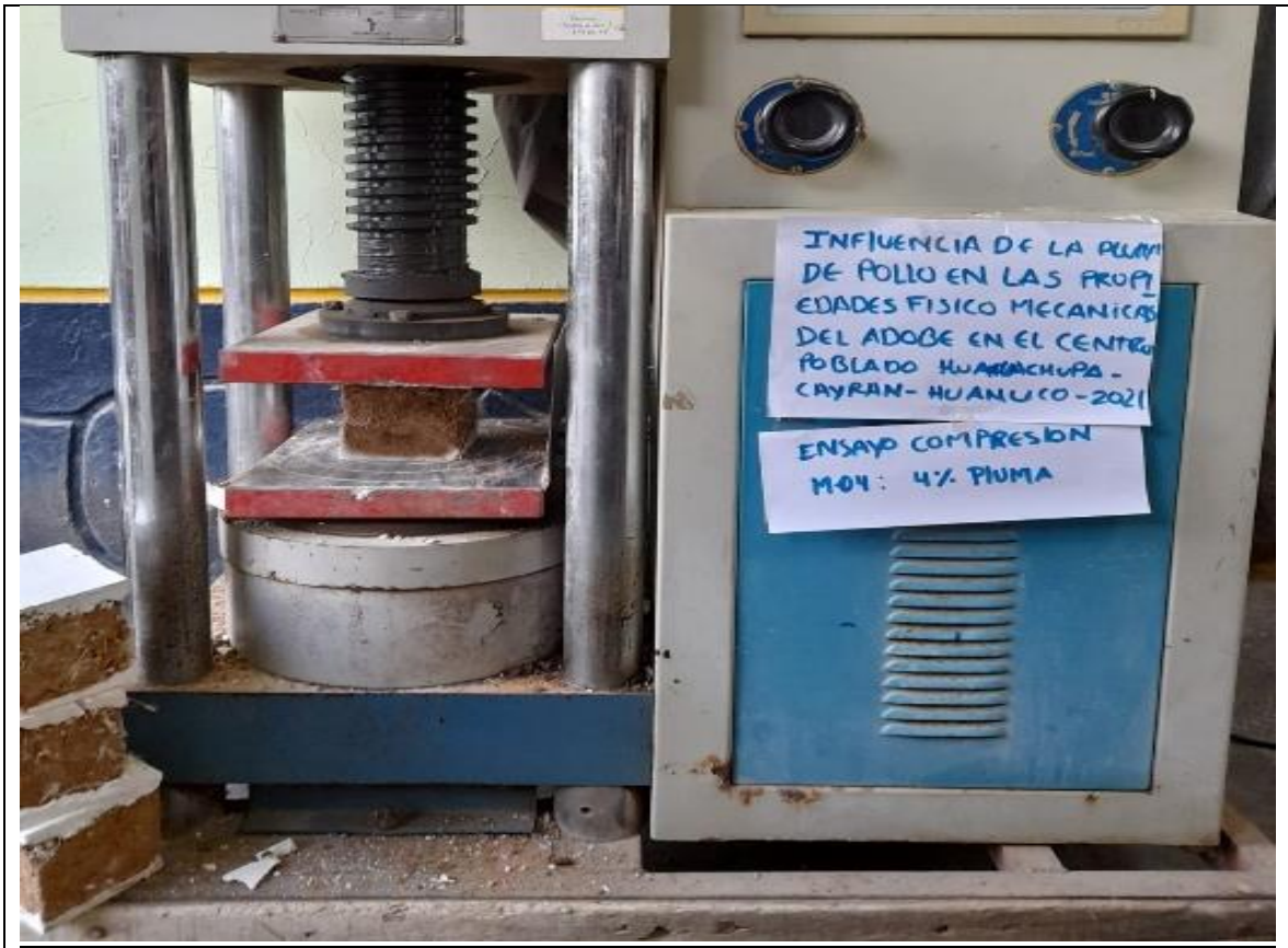
Fotografía 34. Ensayo compresión unidad 4%pluma
