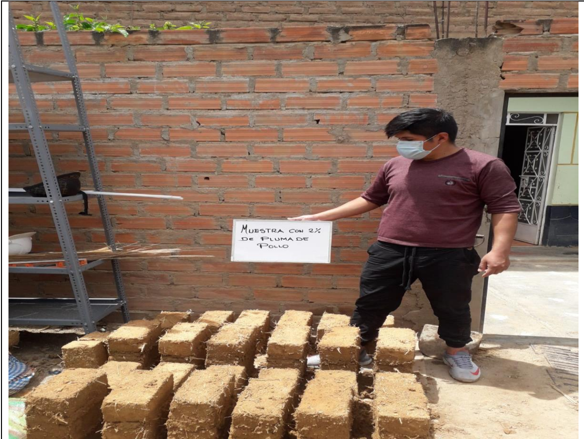
Fotografía 24. Muestra con 2 % de plumas de pollo
