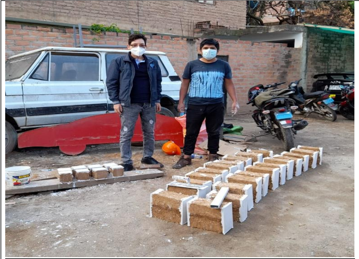
Fotografía 30. Muestras con 4, 3, 2 % de plumas de pollo y 2 % de paja, para ensayo tracción Mortero
