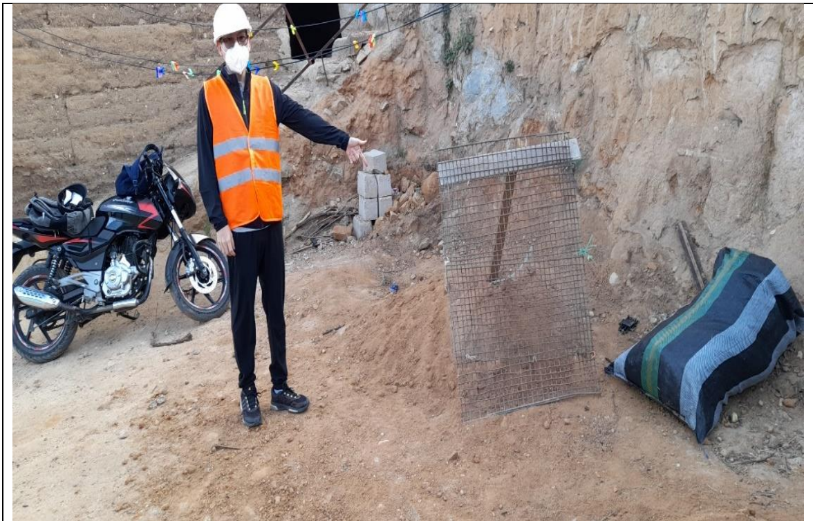
Fotografía 6. Molde de adobe rectangular de 0.12*0.24*0.11 m, Molde de adobe cubico de 0.10*0.10*0.10 m
