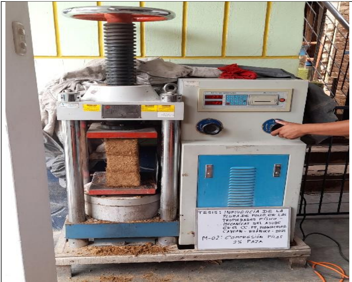
Fotografía 40. Compresión pilas adobe con 2% Paja
