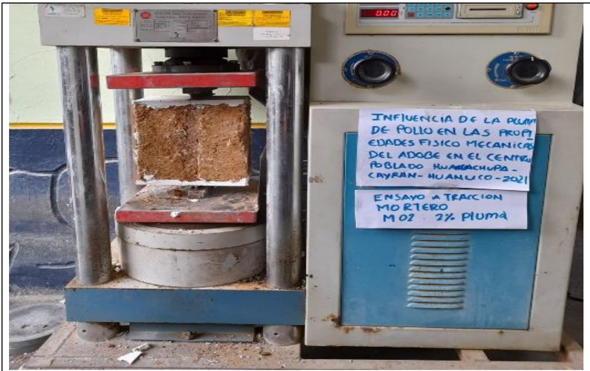
Fotografía 37. Ensayo a tracción mortero 2% pluma
