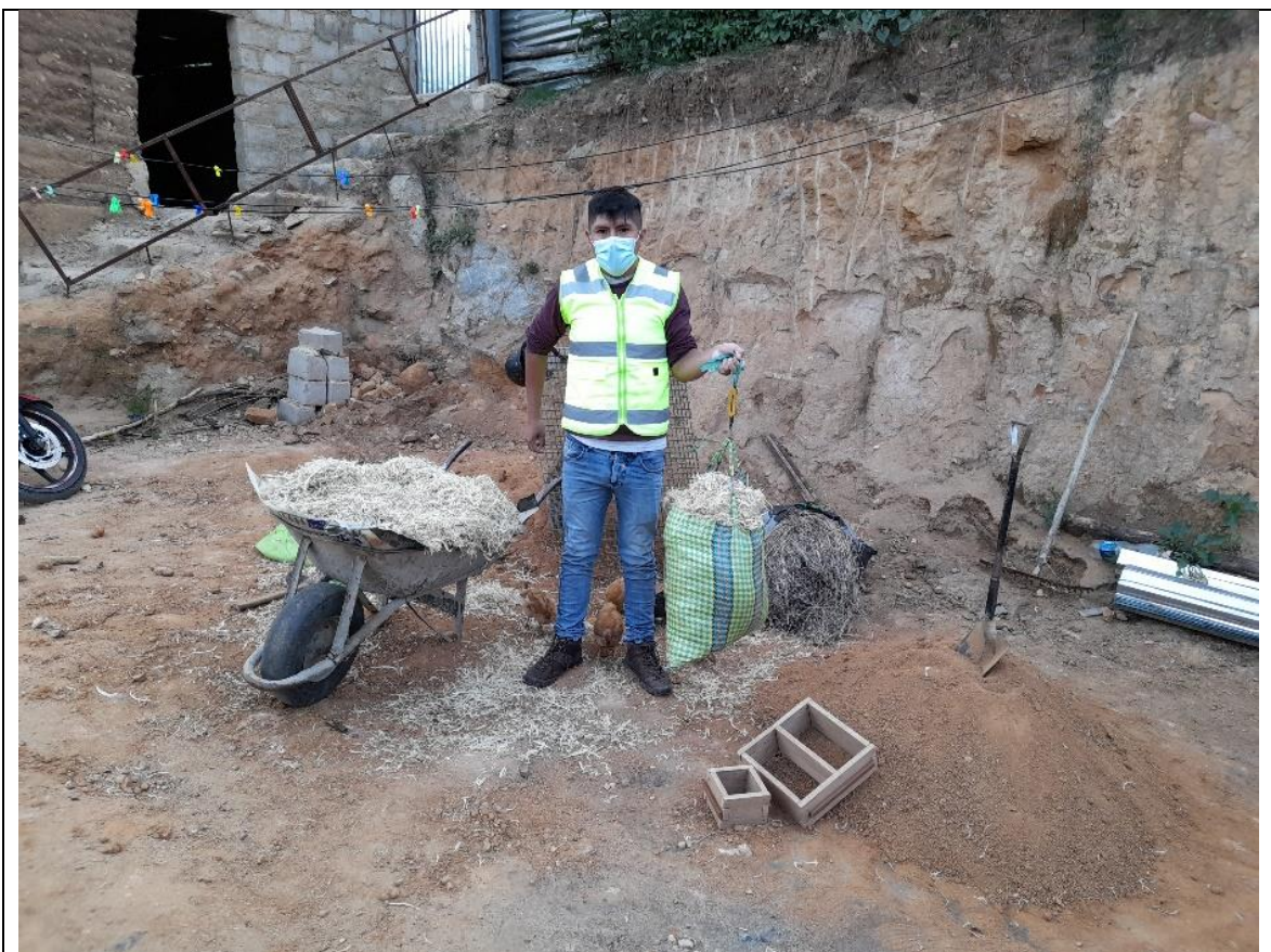
Fotografía 9. Pesaje de la plumas de pollo 2 % en función a su peso, Muestra 1
