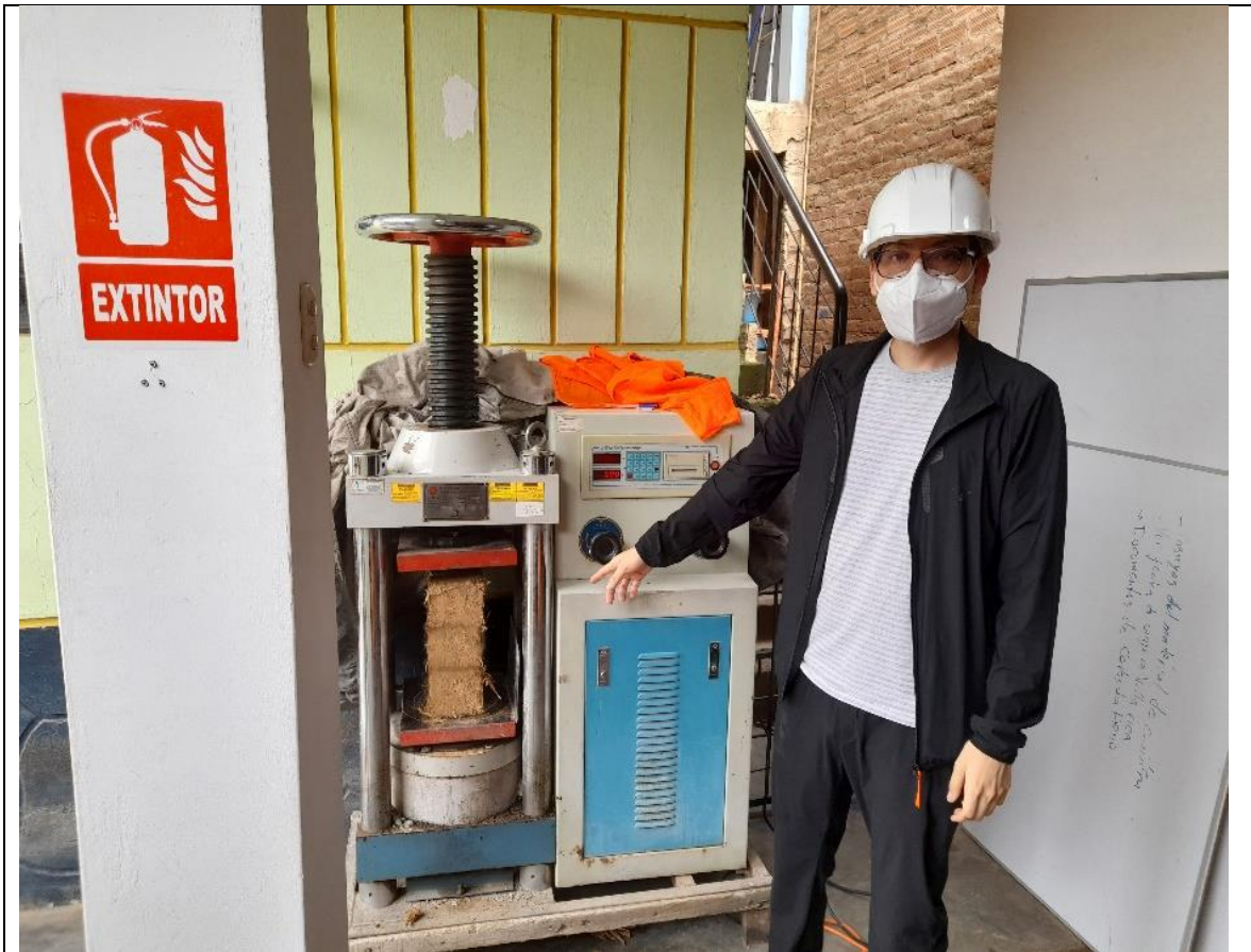
Fotografía 42. Compresión pilas adobe con 3% de Plumas de pollo
