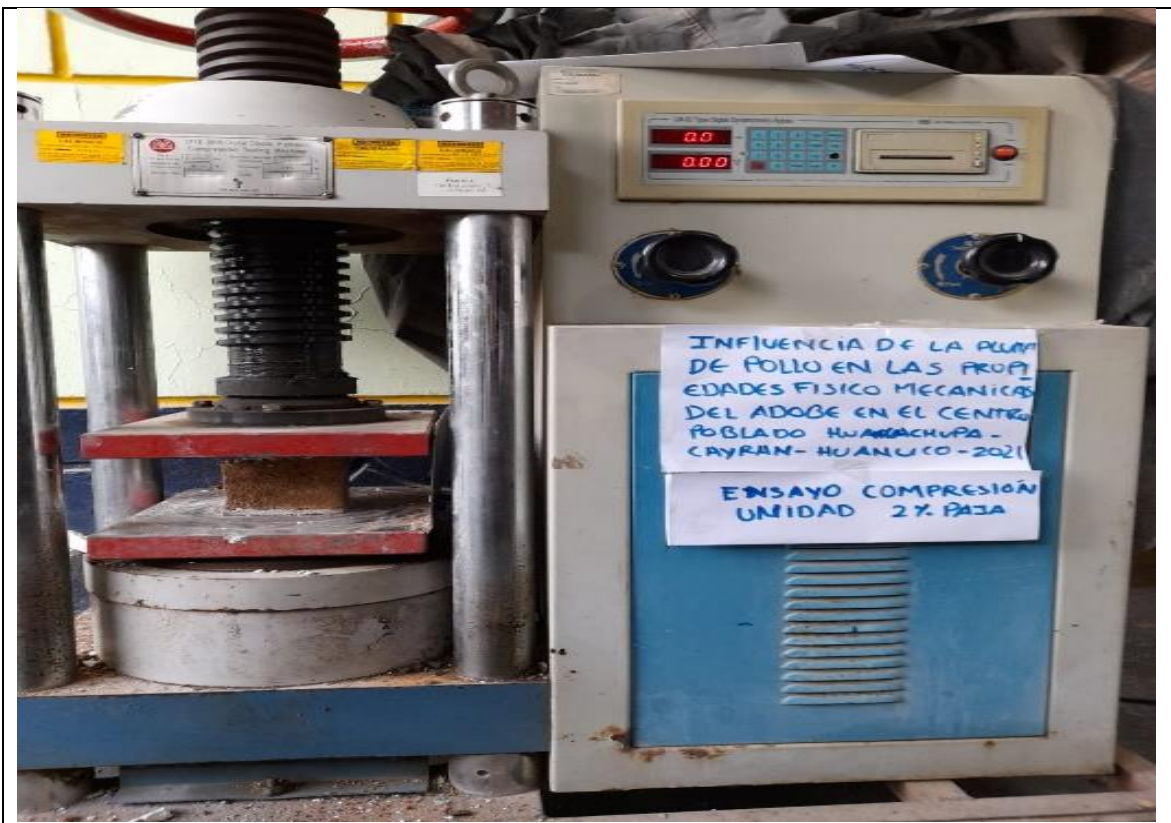
Fotografía 31. Ensayo compresión unidad 2% paja
