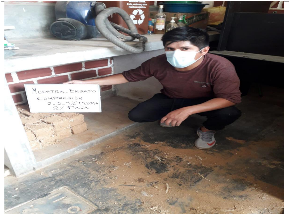
Fotografía 28. Muestras con 4, 3, 2 % de plumas de pollo y 2 % de paja, para ensayo compresión cúbico
