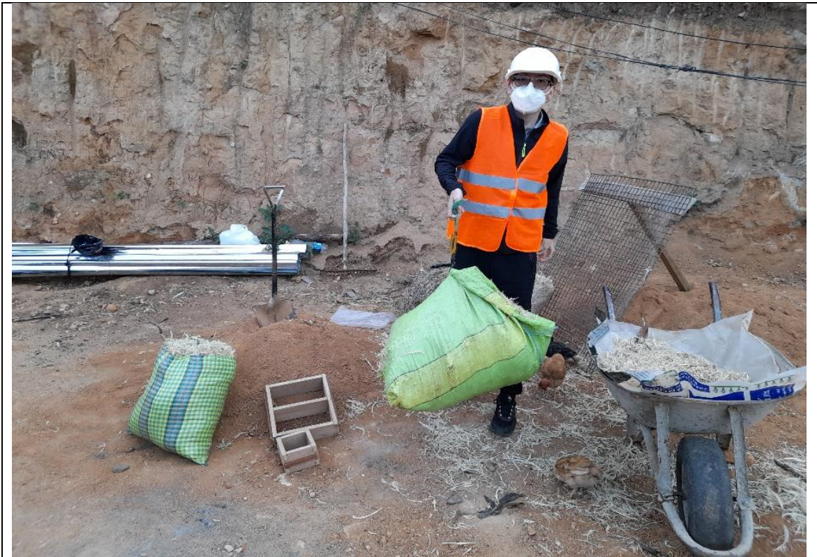
Fotografía 10. Pesaje de la plumas de pollo 3 % en función a su peso, Muestra 2
