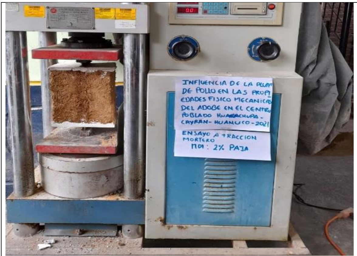
Fotografía 35. Ensayo a tracción mortero 2% paja
