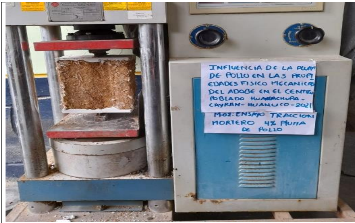
Fotografía 39. Ensayo a tracción mortero 4% pluma
