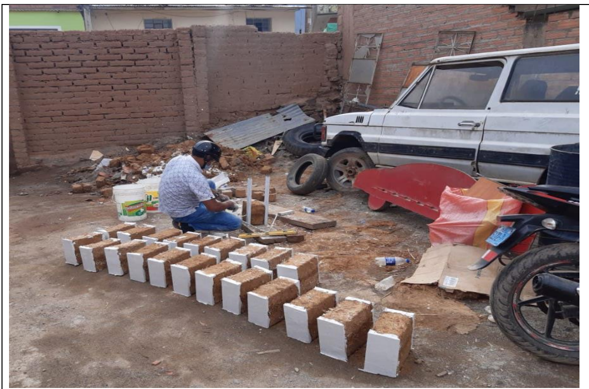
Fotografía 29. Muestras con 4, 3, 2 % de plumas de pollo y 2 % de paja, para ensayo tracción Mortero
