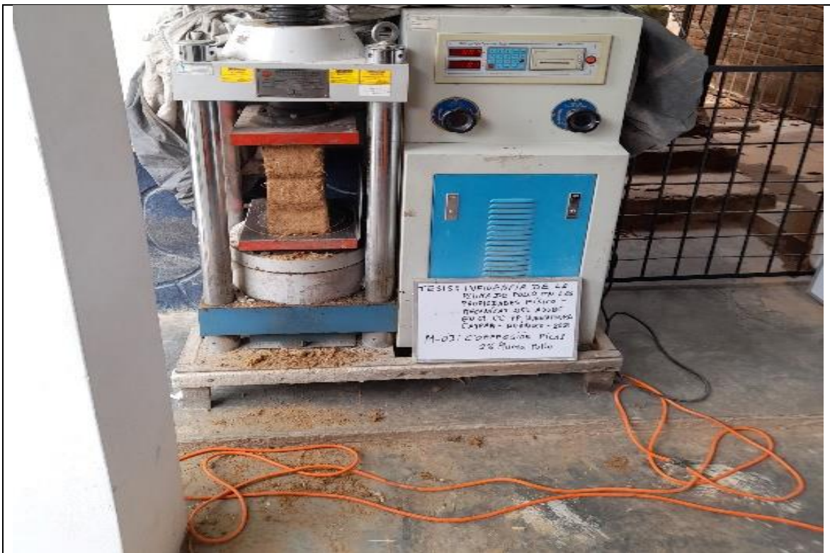
Fotografía 41. Compresión pilas adobe con 2% de Plumas de pollo4
