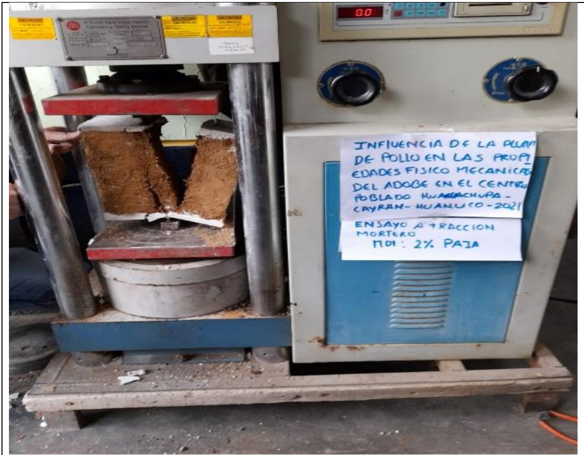
Fotografía 36. Ensayo a tracción mortero 2% paja
