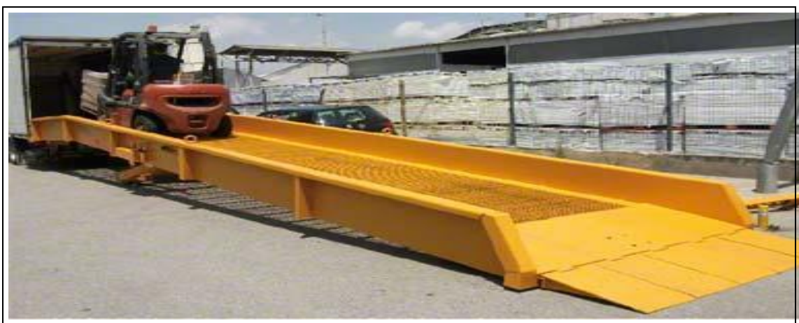
Figura 5. Rampa metálica para acceder al camión
