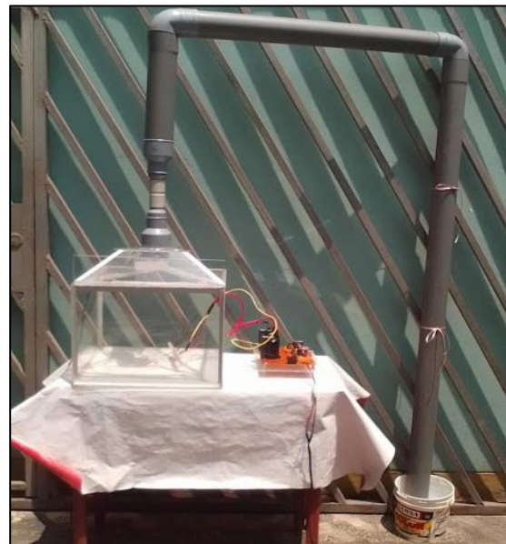
FOTO N°8: Armado del Reactor de plasma de barrera dieléctrica.
