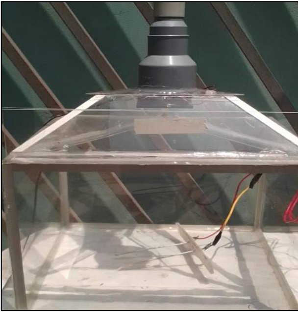
FOTO N°5: Cabina del reactor donde se coloca en la parte superior un ventilador y un tubo de salida de los contaminantes.
