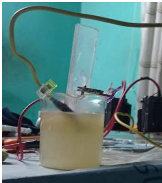
FOTO N°10: se coloca un electrodo dentro del agua y el otro al borde del agua sin tocarla.
