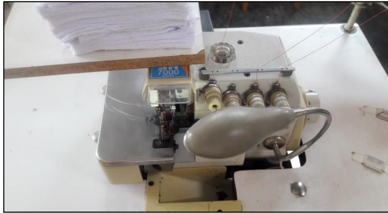
Figura 31. Puesto de trabajo de las operaciones: pegado de manga y cerrado de costados
