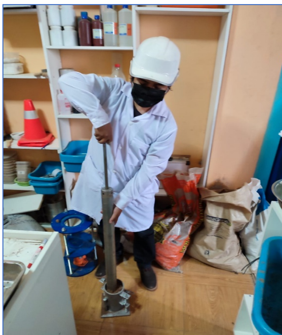
Figura 27: Compactación de molde a diferente energía de compactación.
