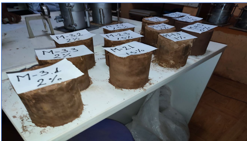
Figura 34: Testigos con dosificaciones al 0%, 1%, 1.5% y 2%
