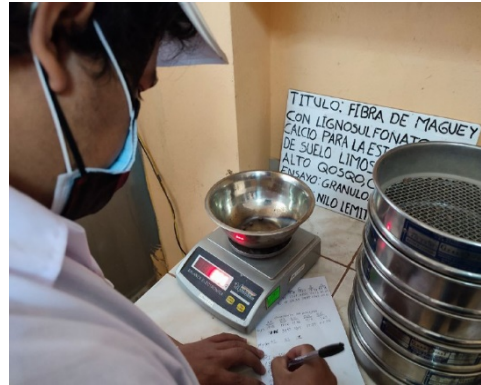
Figura 17: Registro de la cantidad de suelo que pasó por cada malla.
