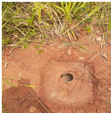
Figura 11. Medición de la permeabilidad del suelo in-situ tramo 02
