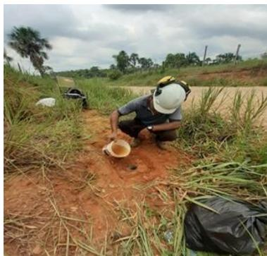
Figura 10. Medición de la permeabilidad del suelo in-situ tramo 01
