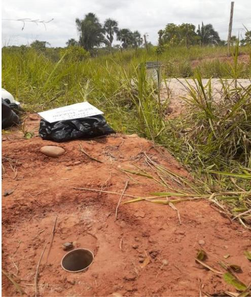
**TOMA N° 09:** Se muestra el ensayo in situ de permeabilidad del suelo de la calicata N° 02 en la progresiva 7+000
