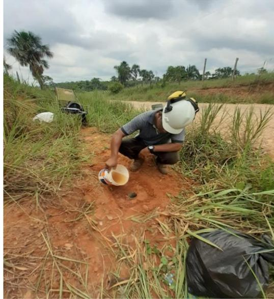
**TOMA N° 10:** Se muestra el ensayo in situ de permeabilidad del suelo de la calicata N°03 en la progresiva 10+000
