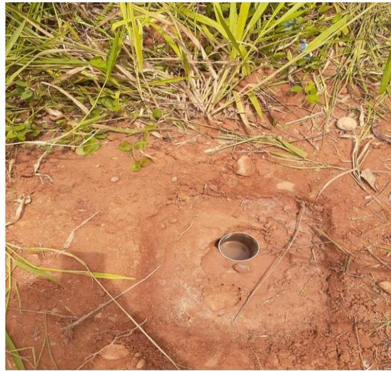
**TOMA Nº 08:** Se muestra el ensayo in situ de permeabilidad del suelo de la calicata Nº 01, en la progresiva 3+000
