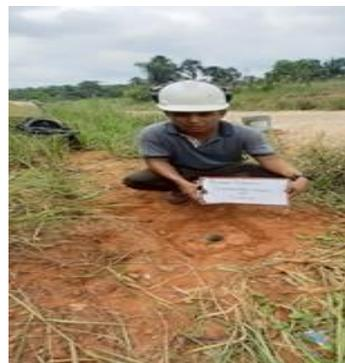
Figura 12. Medición de la permeabilidad del suelo in-situ tramo 03
