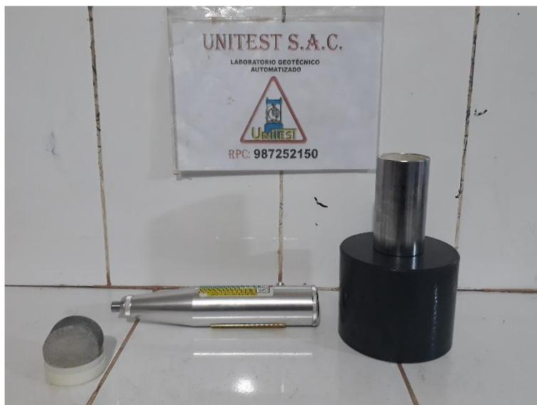
Figura 16: Equipo de esclerometría con la piedra abrasiva y el yunque de calibración.
