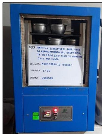
Ensayo de Contenido de Humedad.
