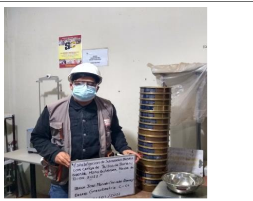
Fotografía 8. Ensayo de granuometria
