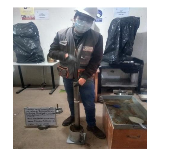
Fotografía 9. Ensayo de proctor modificado
