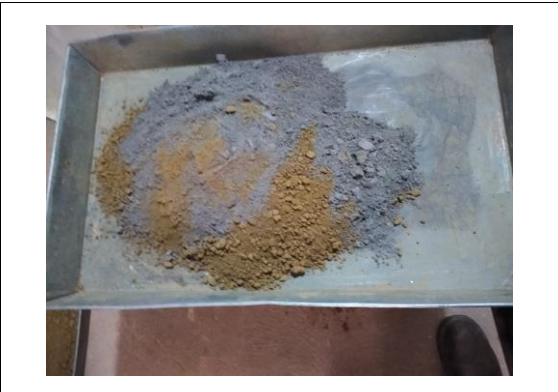
Fotografía 7. Mezcla de ceniza de tallo de banano con el suelo patron.
