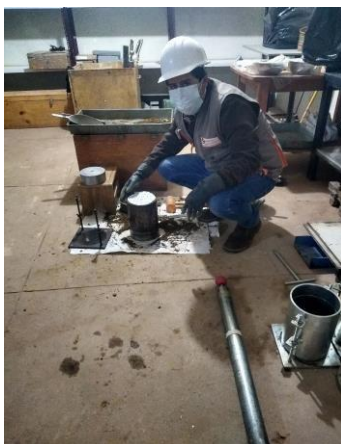
Figura 38. Ejecución de ensayo CBR
