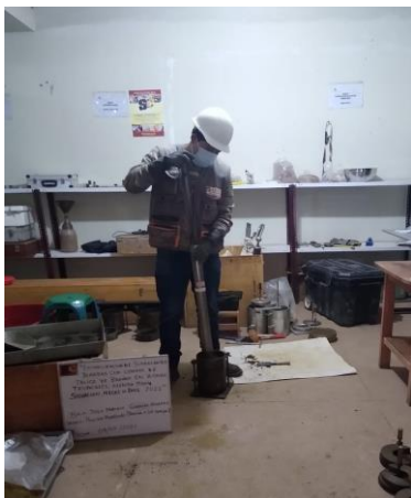
Figura 35. Compactación de material ensayo Proctor modificado
