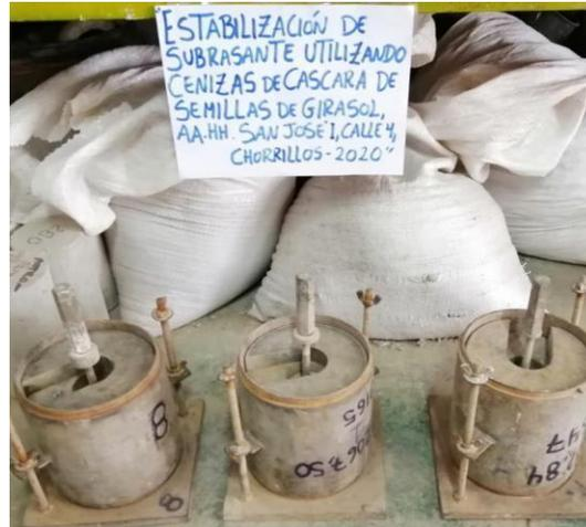
**Figura 11:** Ensayo de CBR
