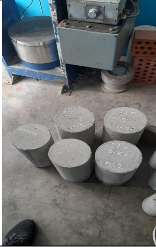
se aprecian los testigos de concreto
