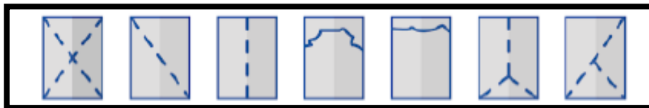
Figura N°19: Tipos de rotura del ensayo a compresión.
