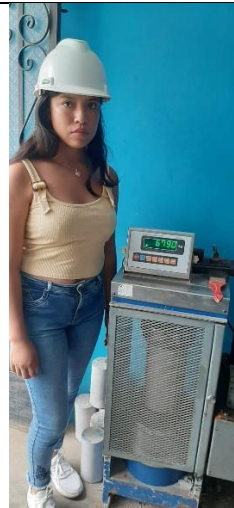
ingresamos el testigo de concreto para realizar la prueba
