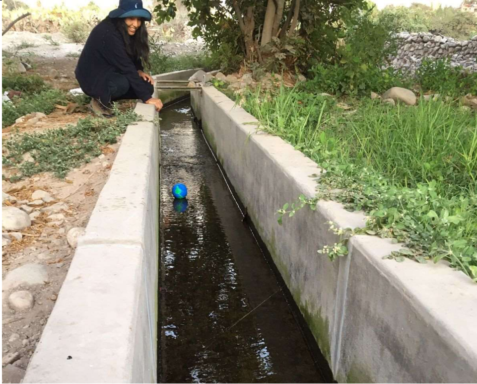
Visita a campo: Método de la boya para el cálculo de la velocidad del fluido.
