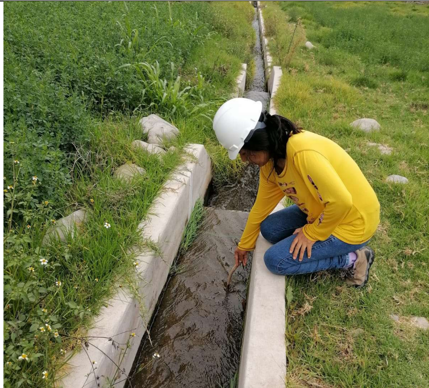
Visita a campo: Medición de altura de caudal en el primer punto, que se encuentra metros de aguas abajo del ingreso de 02 caudales.
