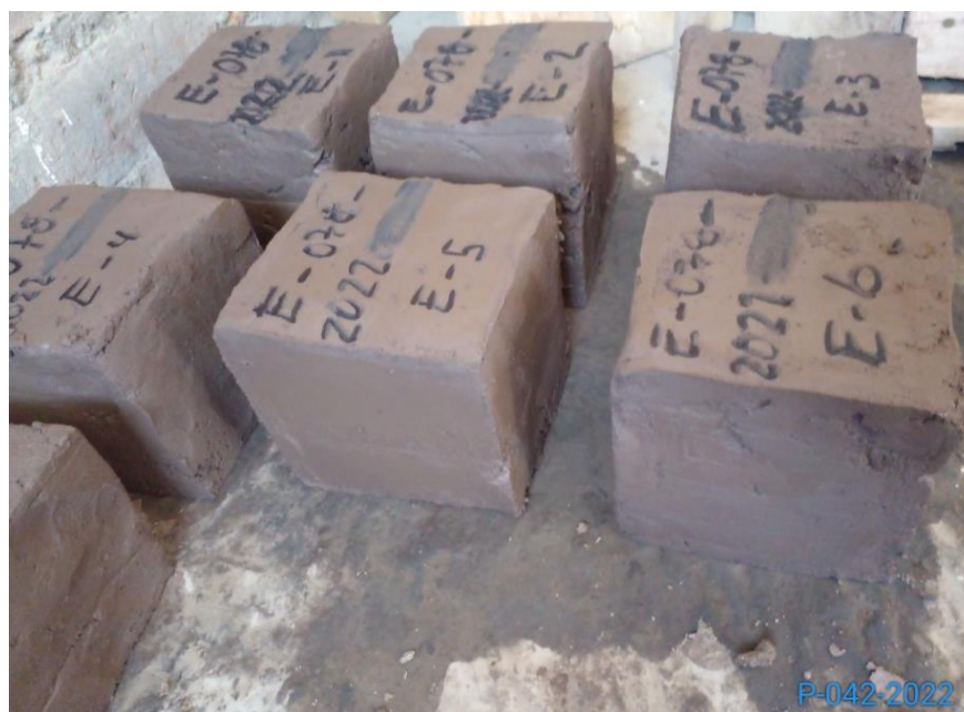
FIGURA N° 24: Elaboración de las muestrs de adobe.
