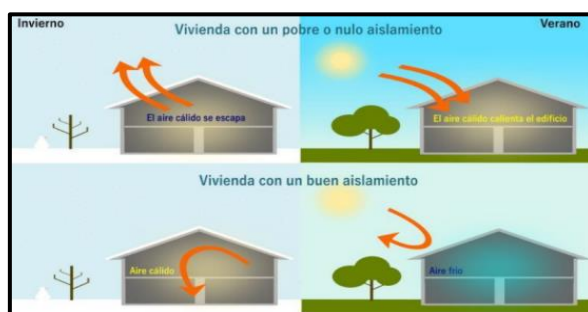
Figura 4. Comportamiento frio calor (con o sin aislamiento)
