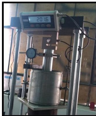
Figura 30. Ensayo de CBR.
