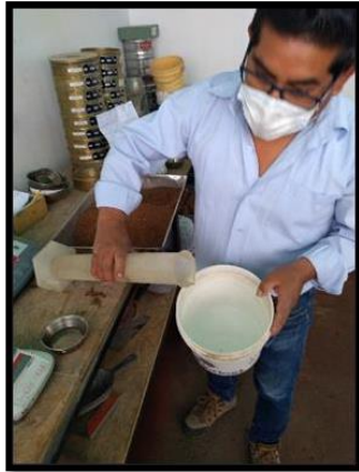
Figura 25. Mezcla del aditivo Stabl Soil con el agua.
