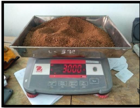
Figura 21. Pesado de la muestra.
