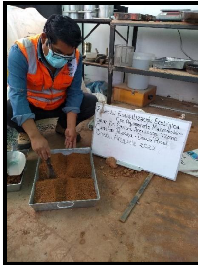
Figura 16. Cuarteo de la muestra de suelo.
