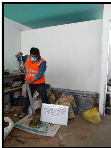
Figura 23. Compactación de la muestra.
