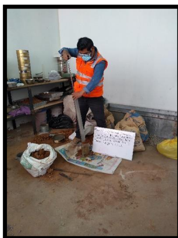
Figura 27. Compactación del suelo dosificado.
