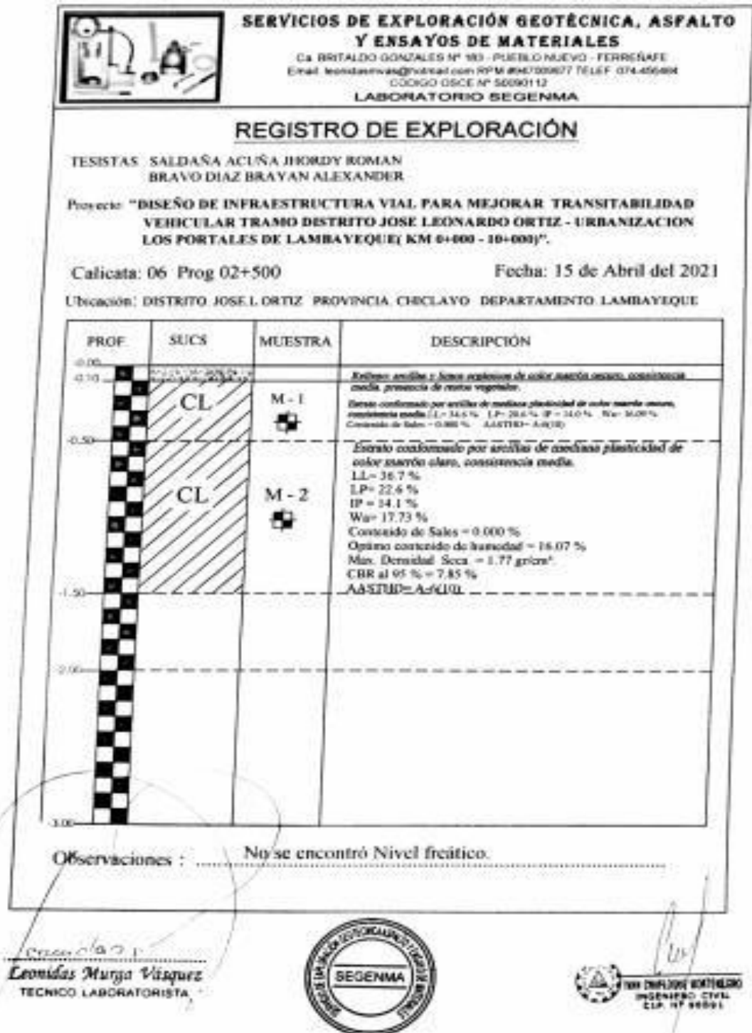
Instrumento 44.- Resultado del perfil estratigráfico de la calicata número 6.
