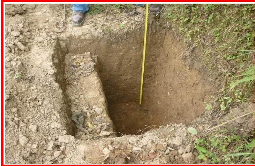
Figura 35.Registro del perfil del suelo en calicata C3.
