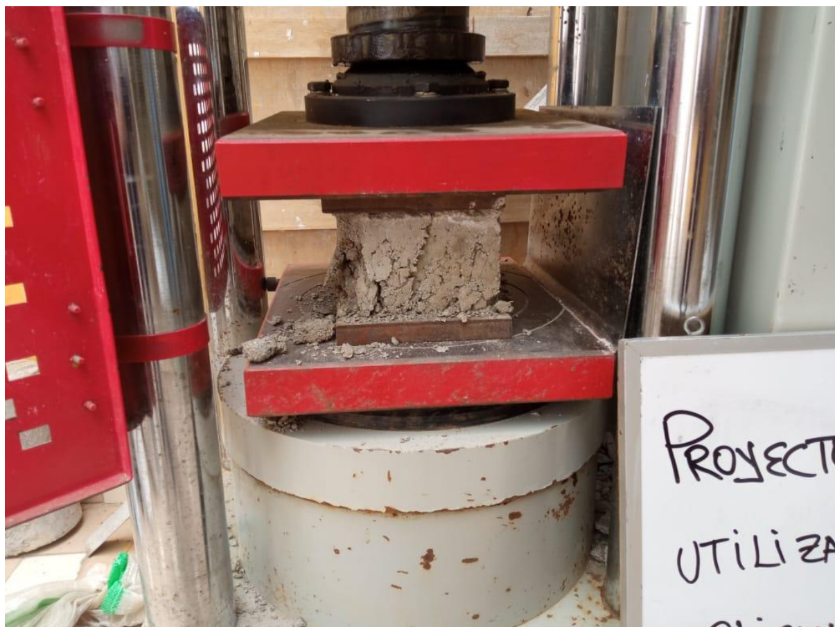
Fotografía 13: fractura de ladrillo de M2
