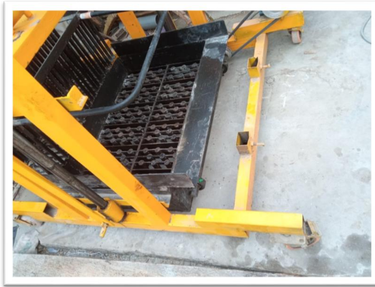
Ilustración 9: Máquina ponedora de ladrillo
