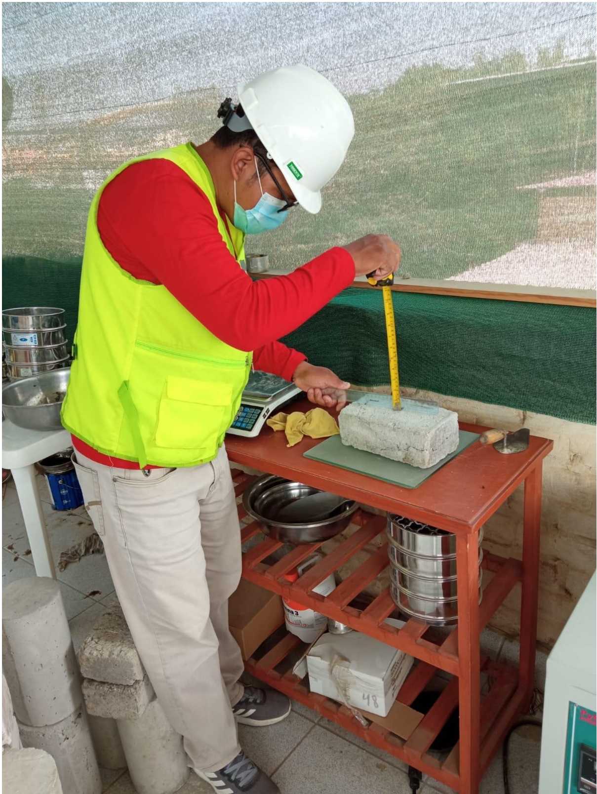
Fotografía 19: Ensayo de variación dimensional
