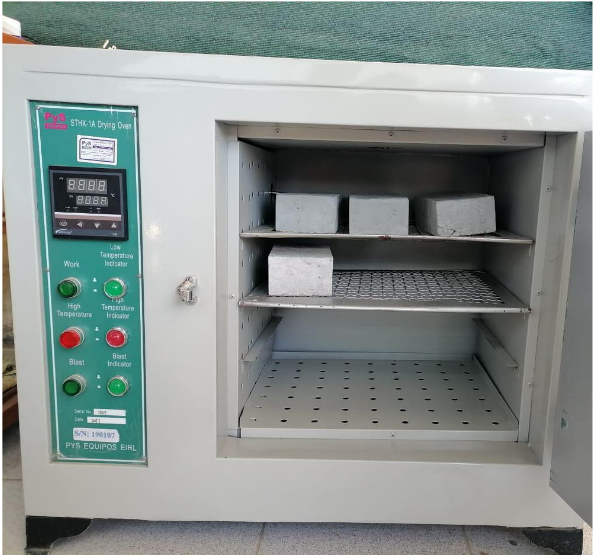
Fotografía 18: Secado de unidades para el % de humedad
