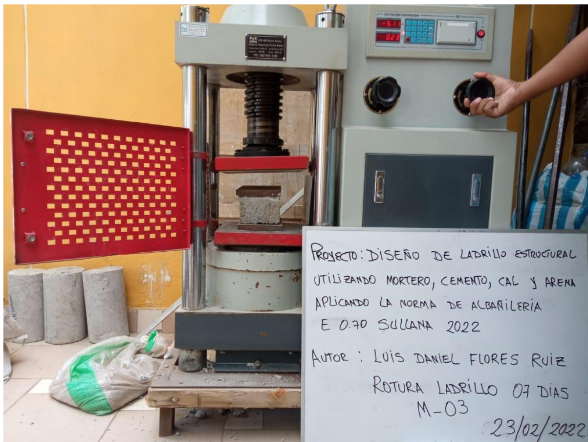
Fotografía 11: Ensayo de resistencia a la compresión a M3
