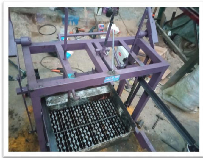
Ilustración 7: Máquina ponedora de ladrillo
