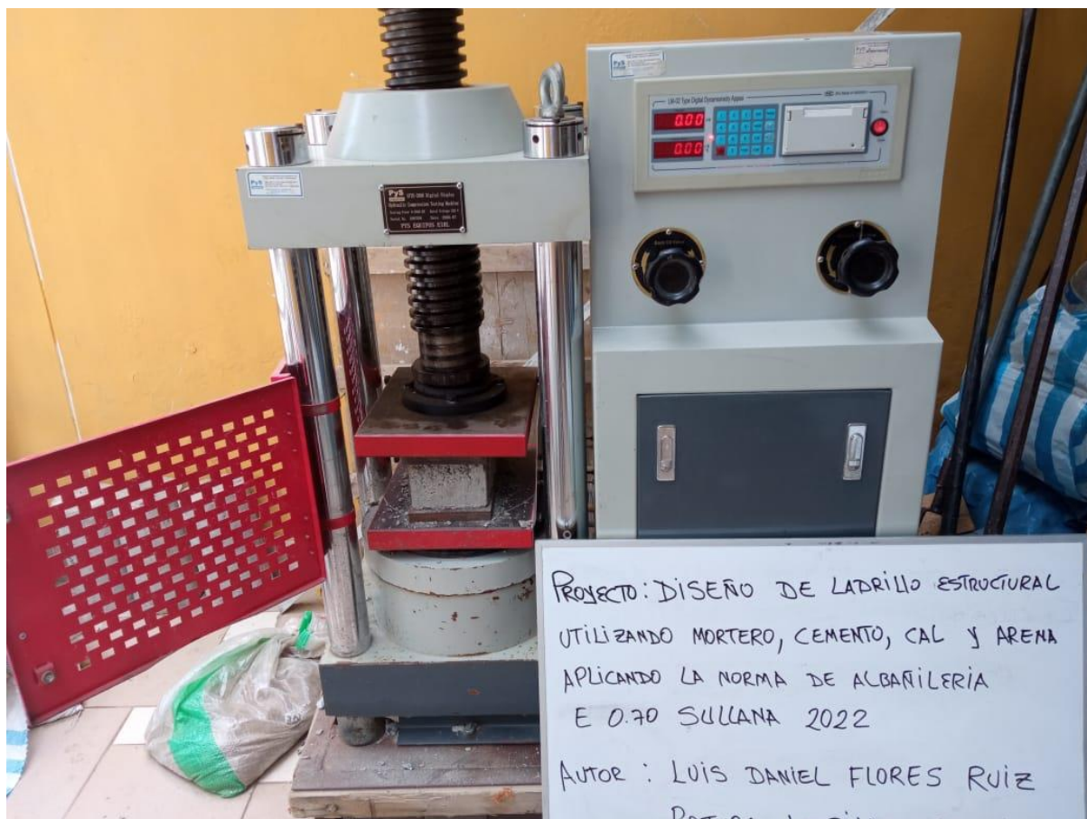
Fotografía 10: Ensayo de resistencia a la compresión a M2
