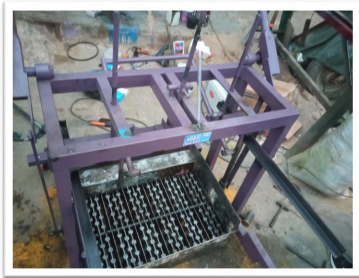
Ilustración 3: Máquina ponedora de ladrillo
