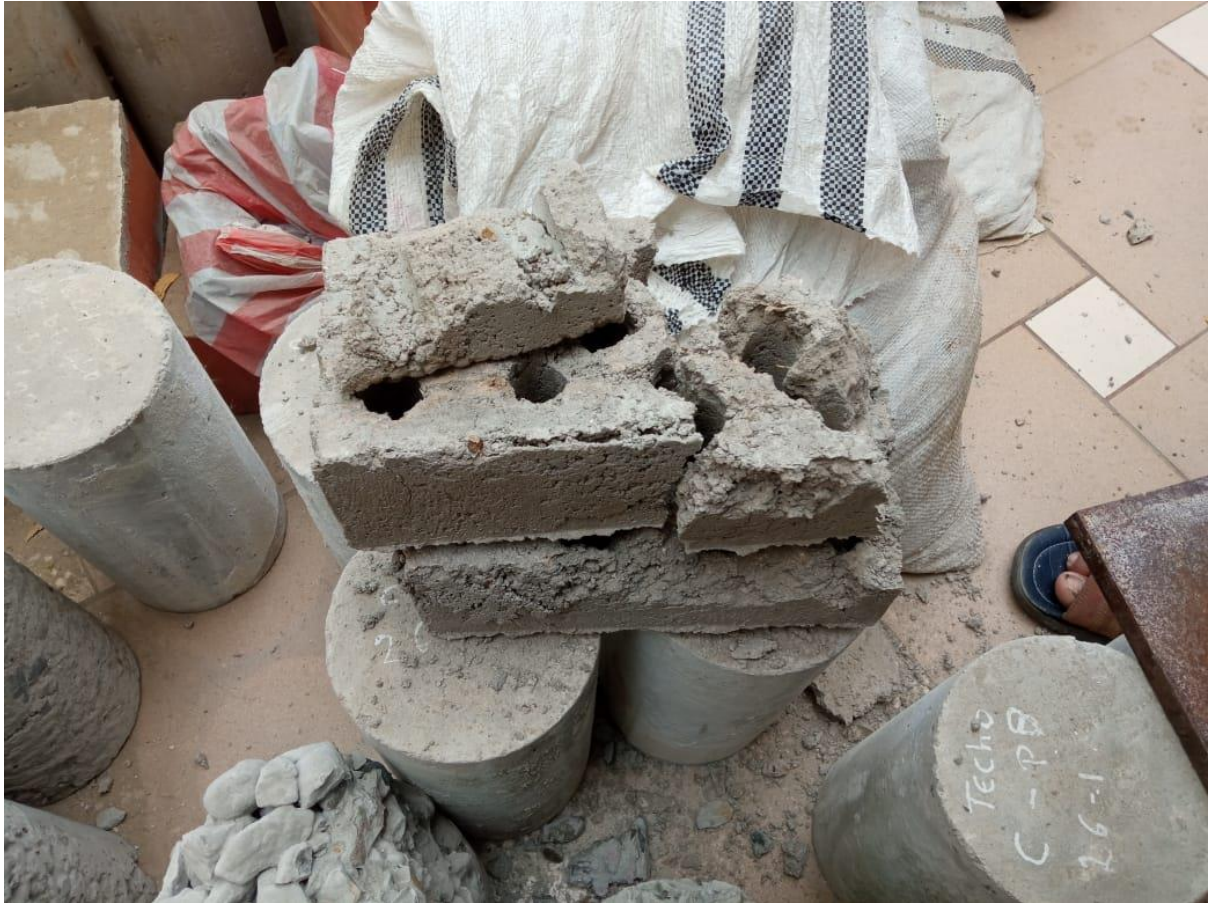
Fotografía 12: fractura de ladrillo de M1
