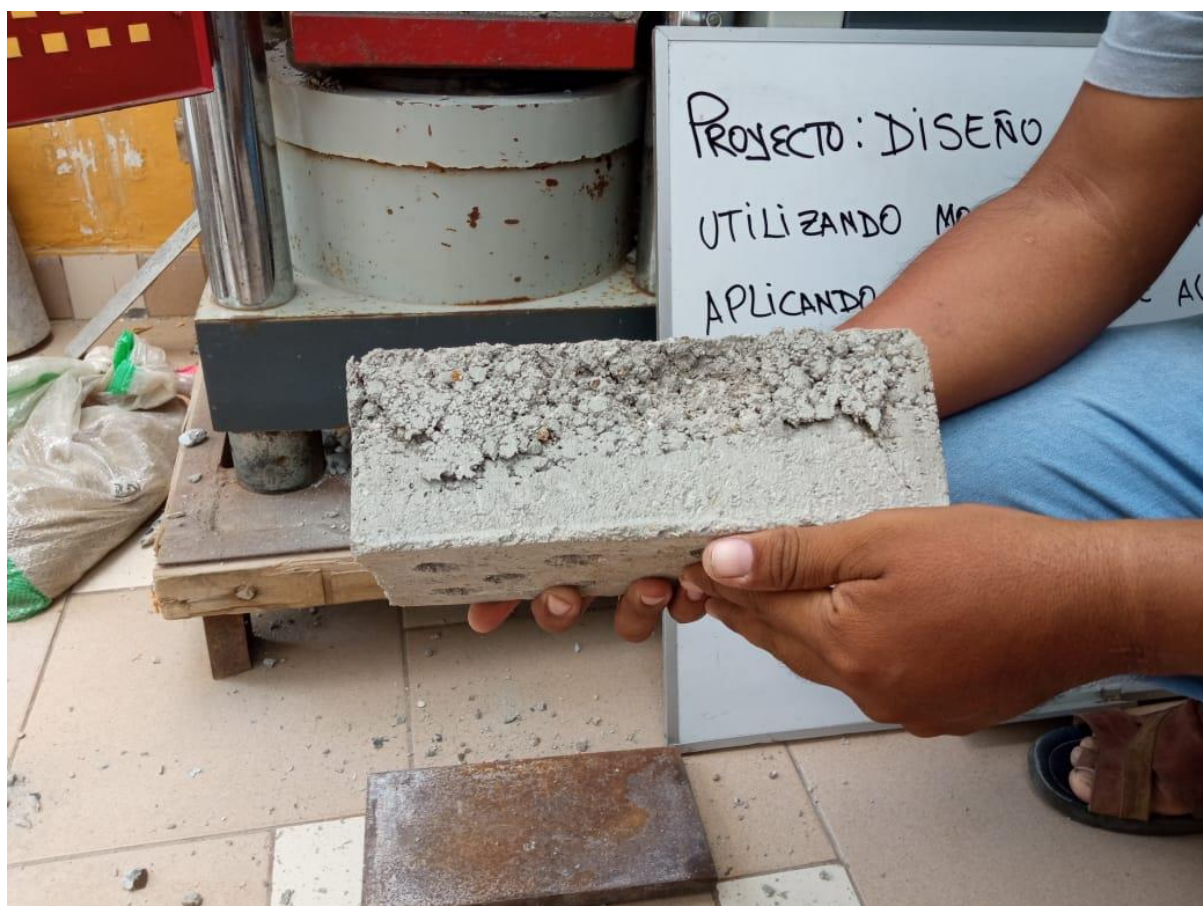
Fotografía 14: fractura de ladrillo de M3
