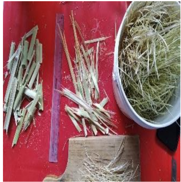
IMAGEN N°12: Retiro de hiladas de carrizo con un grosor aproximadamente de 3mm.
