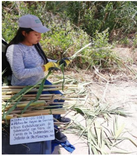
IMAGEN N°9: Se observa el retiro de hojas de carrizo.
