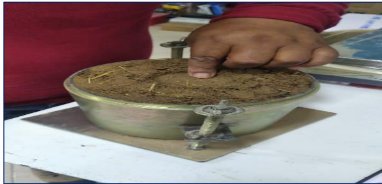
Figura 40: Muestra de suelo con adición de fibra resultante de ensayo CBR
