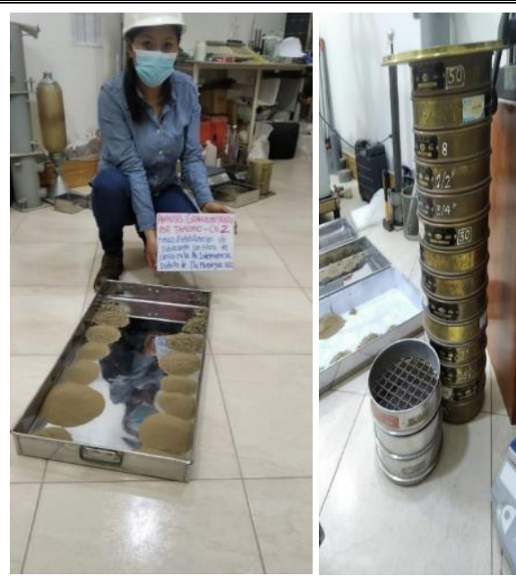
IMAGEN N° 16: Análisis granulométrico de C-02 en laboratorio de mecánica de suelos.
