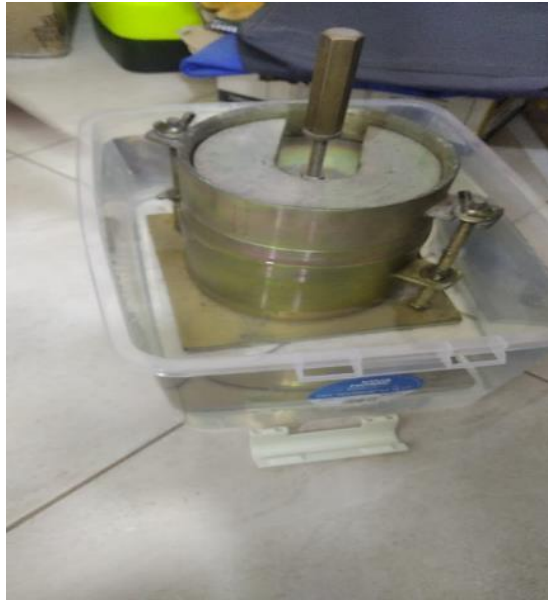
IMAGEN N°25: Molde de 6" de la muestra de suelo con la fibra de carrizo sumergido en agua.
