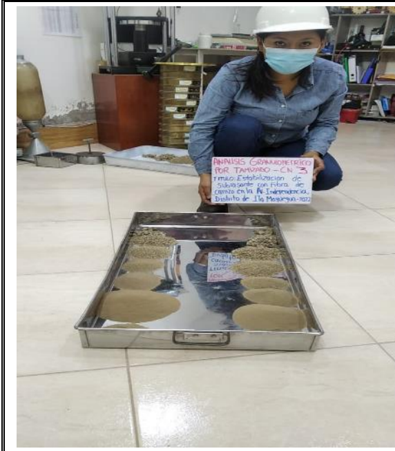
IMAGEN N°17: Análisis granulométrico de C-03 en laboratorio de mecánica de suelos.
