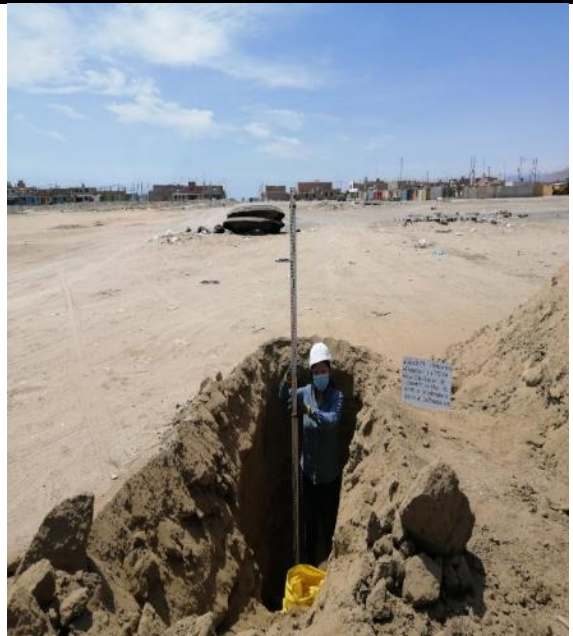
IMAGEN N°4: Se observa los estratos, altura y muestra del suelo de la excavación de la calicata 04
