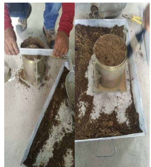
IMAGEN N°24: Enrasado y limpieza de molde de proctor modificado.
