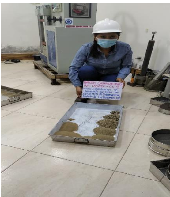
IMAGEN N°15: Análisis granulométrico de C-01 en laboratorio de mecánica de suelos.
