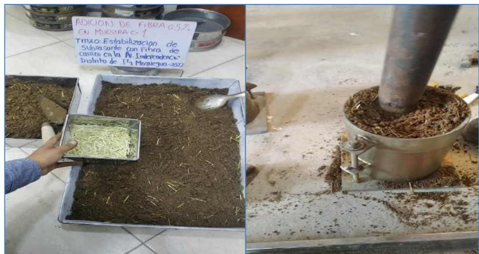
Figura 17: Ensayo de proctor modificado
