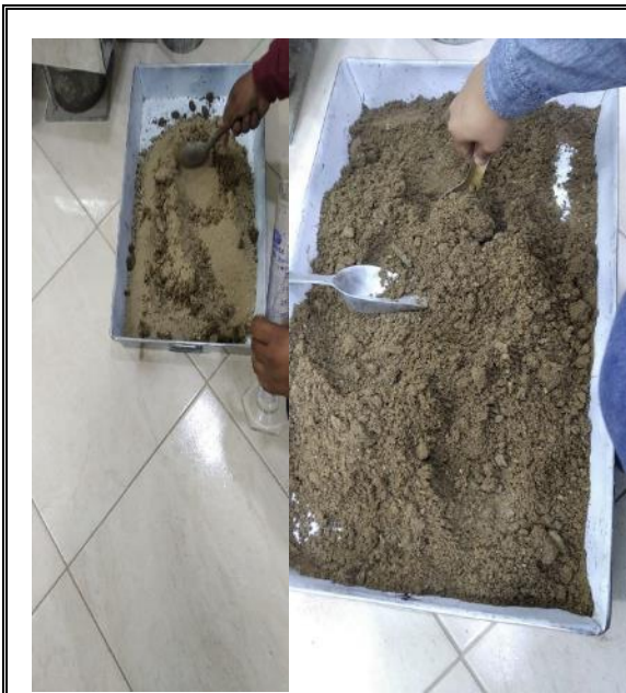
IMAGEN N°19: Contenido de humedad en las muestras de suelo natural
