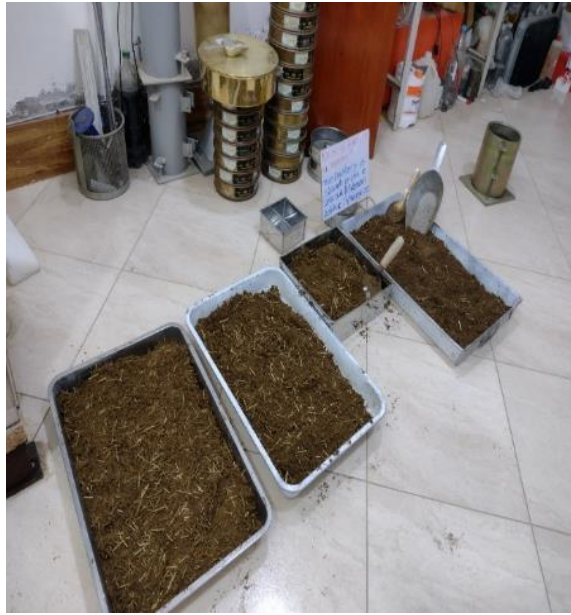
IMAGEN N°21: Dosificación de 0.5%, 1%, 1.5% y 2% de fibra de carrizo en suelo natural.
