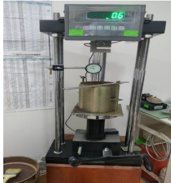
IMAGEN N°26: Ensayo de CBR en la prensa hidráulica.
