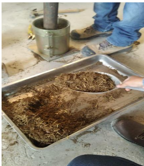
IMAGEN N°23: Llenado de muestra de suelo combinado con la fibra de carrizo en el molde de 6''
