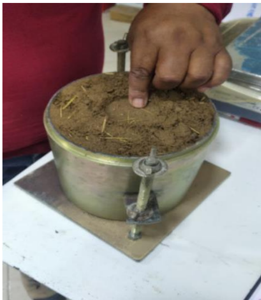
IMAGEN N°27: Obtención de CBR del molde con la muestra de suelo con adición de fibra de carrizo.
