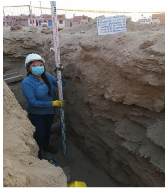
IMAGEN N°2: Se observa los estratos, altura y muestra del suelo de la excavación de la calicata 02
