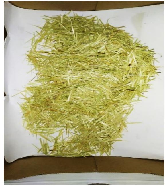
IMAGEN N°14: Obtención de la fibra de carrizo de 25 mm.
