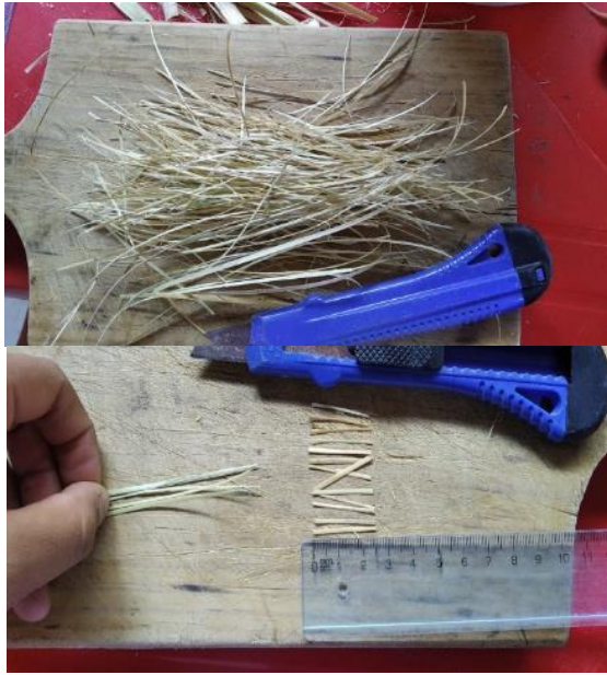
IMAGEN N°13: Corte de las hiladas de carrizo a una longitud de 25 mm.
