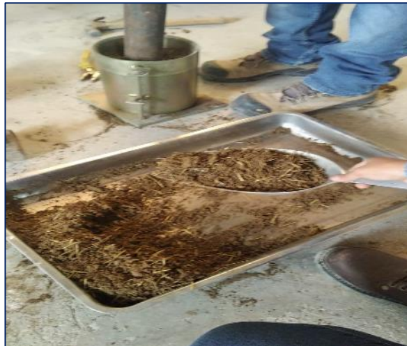
Figura 45: Compactación de suelo con adición de fibra de carrizo
