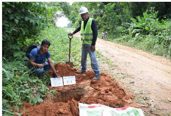
Figura 3.1 Excavación y toma de muestra C-1 Fuente: Propia elaboración
