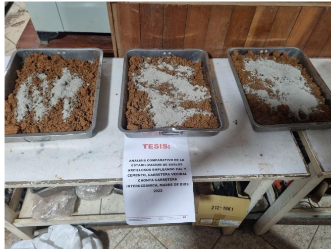
Figura 3.10 Adición de cemento 2%, 4% y 6%, a la muestra de terreno natural
