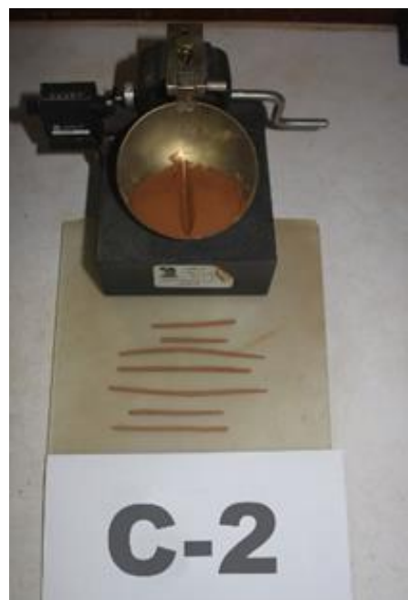
Figura 3.6 Determinación del límite líquido y límite plástico C - 2 Fuente: Propia elaboración
