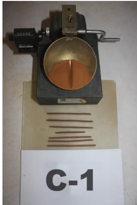
Figura 3.5 Determinación del límite líquido y límite plástico C - 1 Fuente: Propia elaboración
