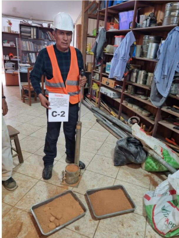
Foto N°05 Ensayo de Proctor Modificado
