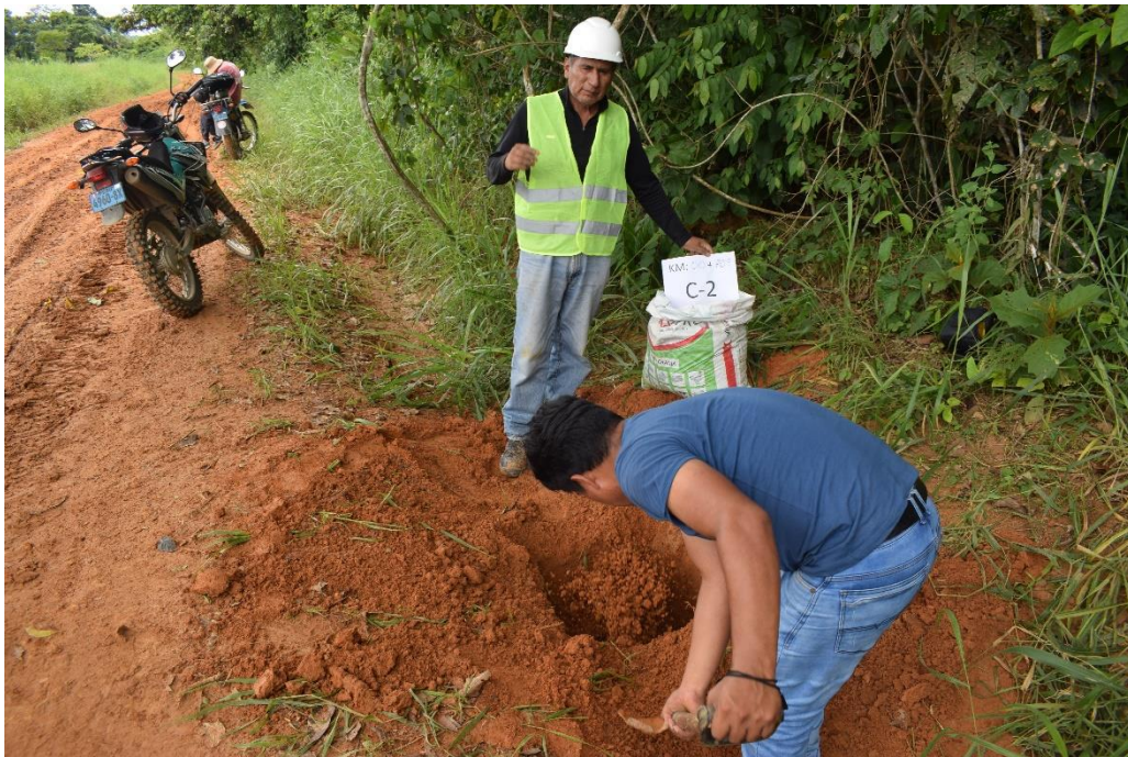
Foto N°02 Tomando muestra del terreno natural
