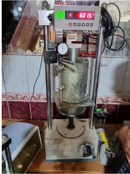
Figura 3.8 Prueba de penetración para la determinación del CBR Fuente: Propia elaboración
