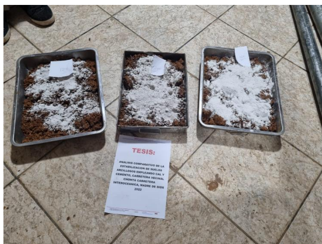
Figura 3.9 Adición de 2%, 4% y 6% de cal a la muestra de terreno natural Fuente: Propia elaboración
