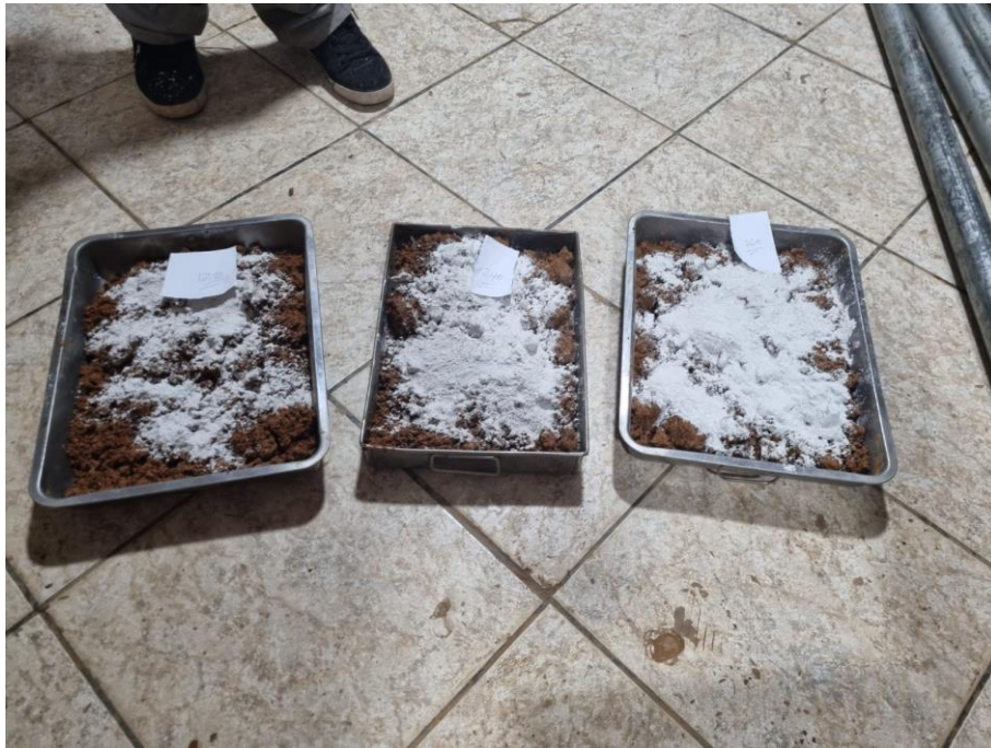
Foto N°07 Adición de Cal 2%, 4% y 6%
