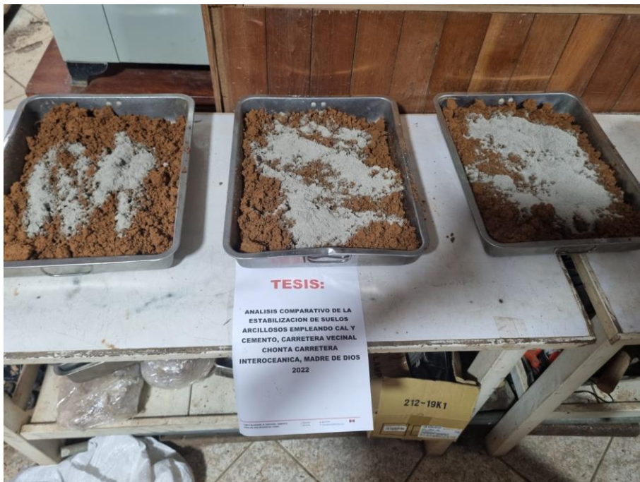
Foto N°08 Adición de Cemento 2%, 4% y 6%
