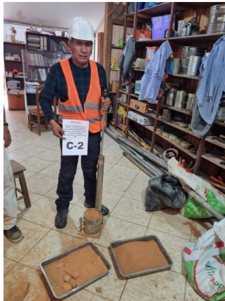
Figura 3.7 Ensayo de Proctor modificado Fuente: Propia elaboración
