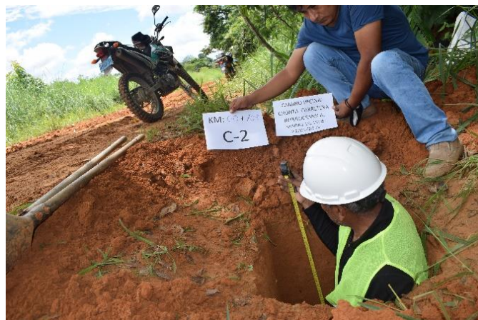
Figura 3.2 Excavación y toma de muestra C – 2 Fuente: Propia elaboración
