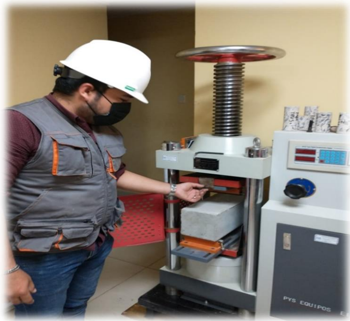
Probetas prismáticas – prueba de flexión.
