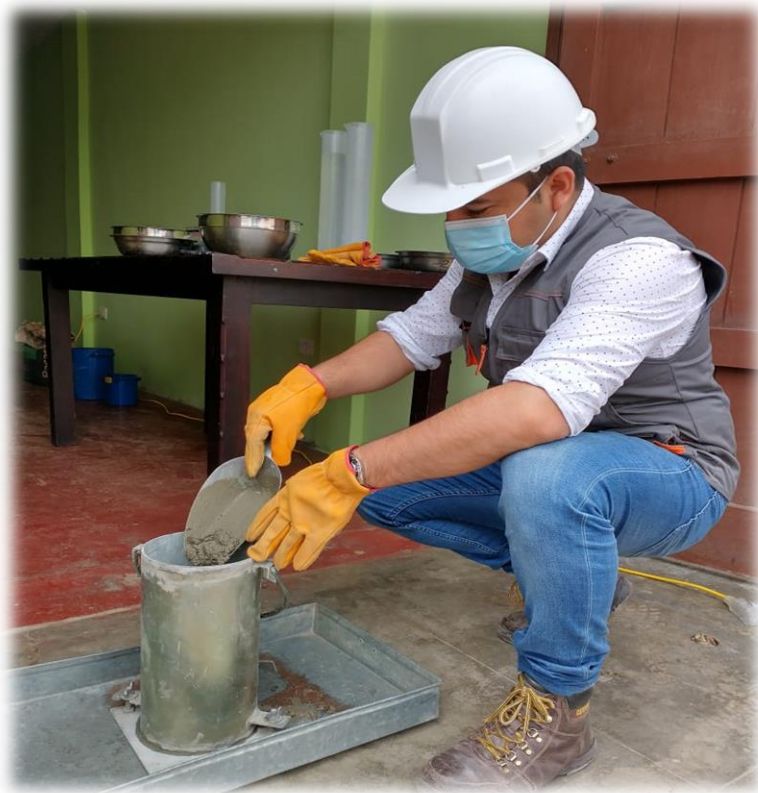
Elaboración de probetas de concreto patrón.
