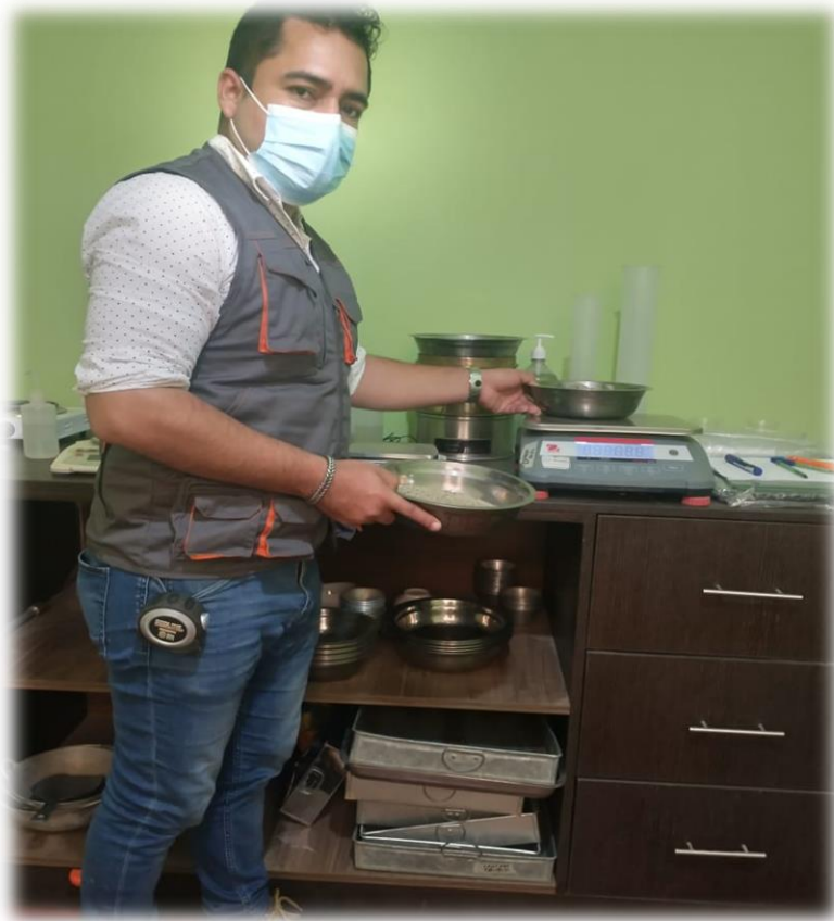
Pesado de agregado convencional.
