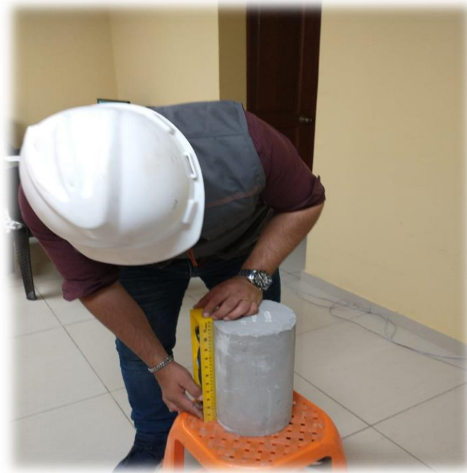
Probetas cilíndricas – toma de medida de la altura.
