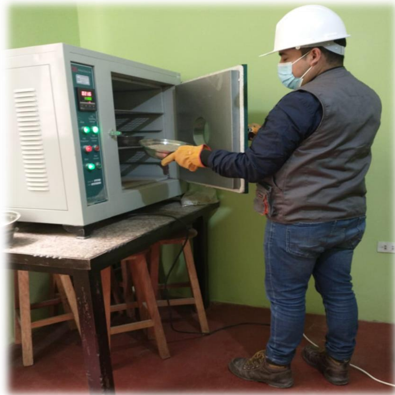
Ingresando muestra de agregado fino al horno, para eliminar la humedad.
