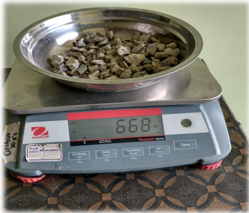
Pesado del concreto reciclado para la elaboración del concreto de reemplazo.
