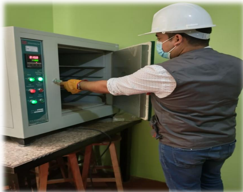
Retirando agregado fino y grueso del horno despues de 24 horas.
