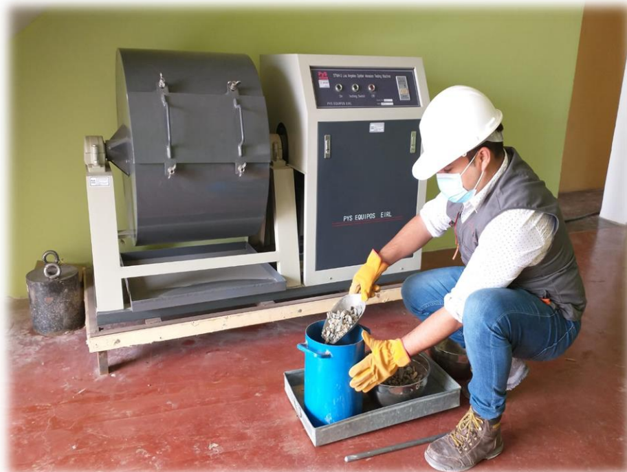
Compactación del agregado grueso convencional
