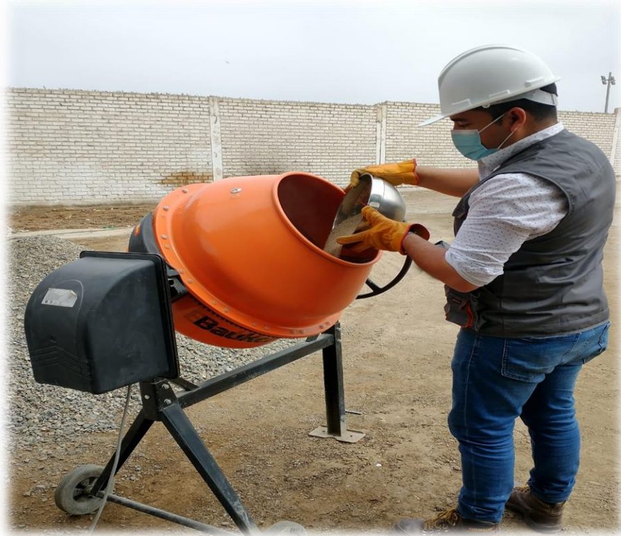
Elaboración de concreto patrón.
