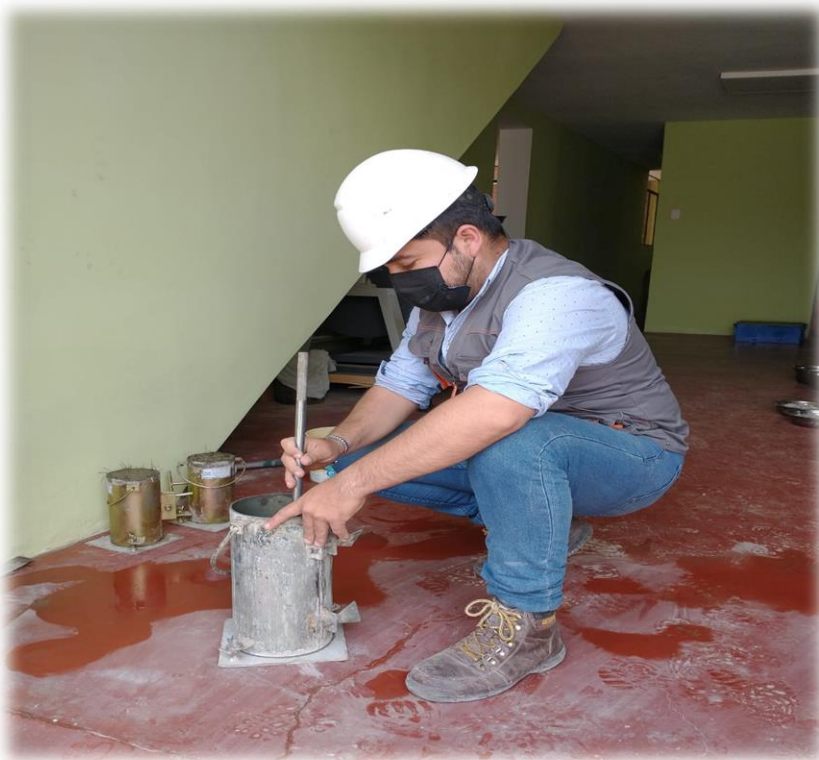
Chuseado de concreto con agregados de reemplazos.
