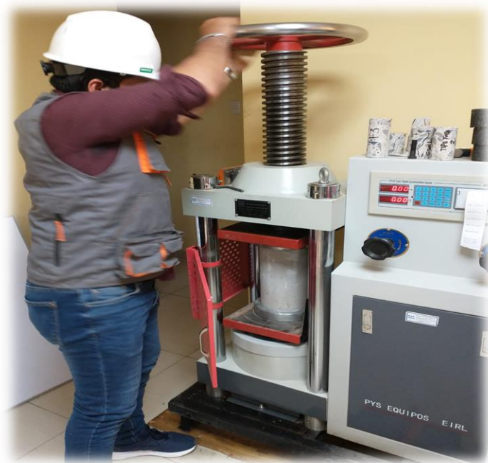
Probetas cilíndricas – prueba de compresión.
