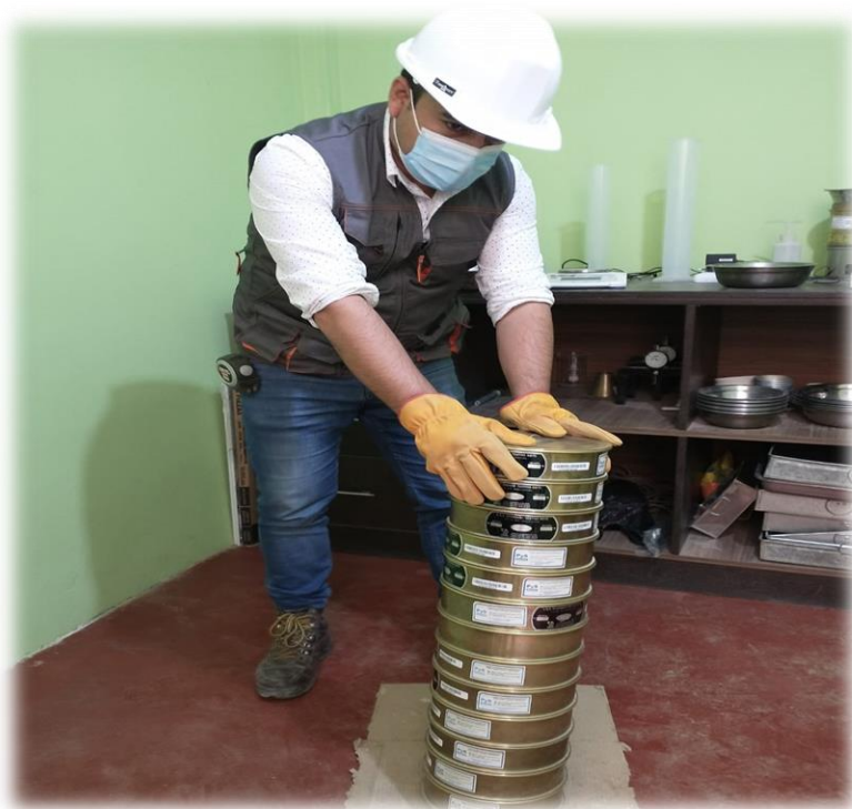
Sarandeo del agregado grueso por todas las mallas.
