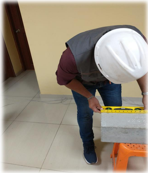
Probetas prismáticas – toma de medida a la falla.
