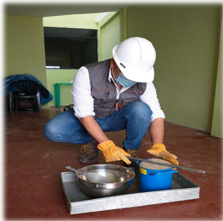
Enrazado del agregado fino.
