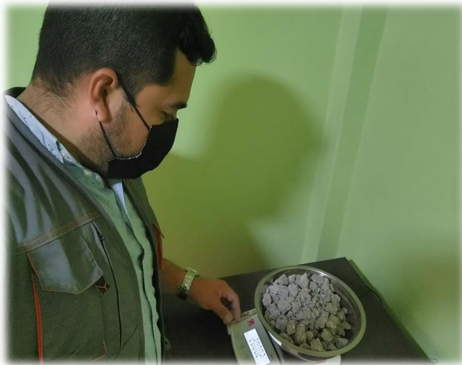
Pesado del concreto reciclado antes de meter al horno
