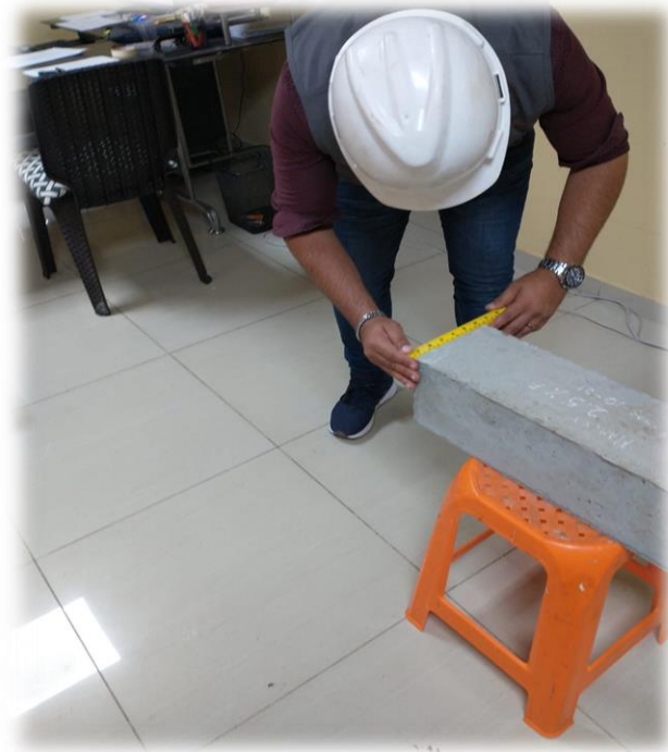
Probetas prismáticas – toma de medida del ancho.
