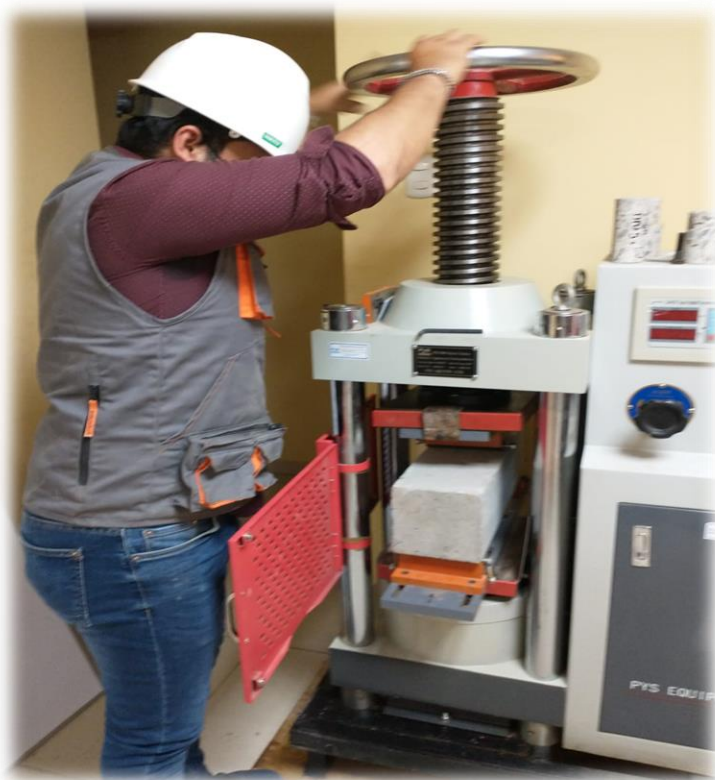
Probetas prismáticas – prueba de flexión.
