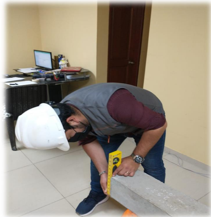
Probetas prismáticas – toma de medida de la altura.
