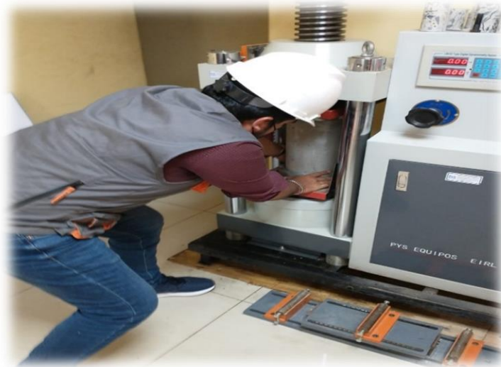
Probetas cilíndricas – prueba de compresión.
