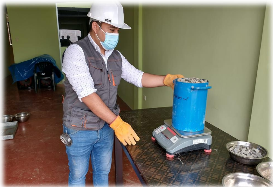
Pesado del agregado grueso convencional
