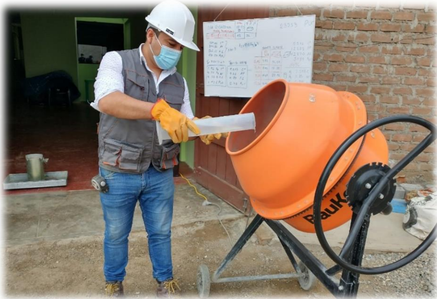
Elaboración del concreto patrón.
