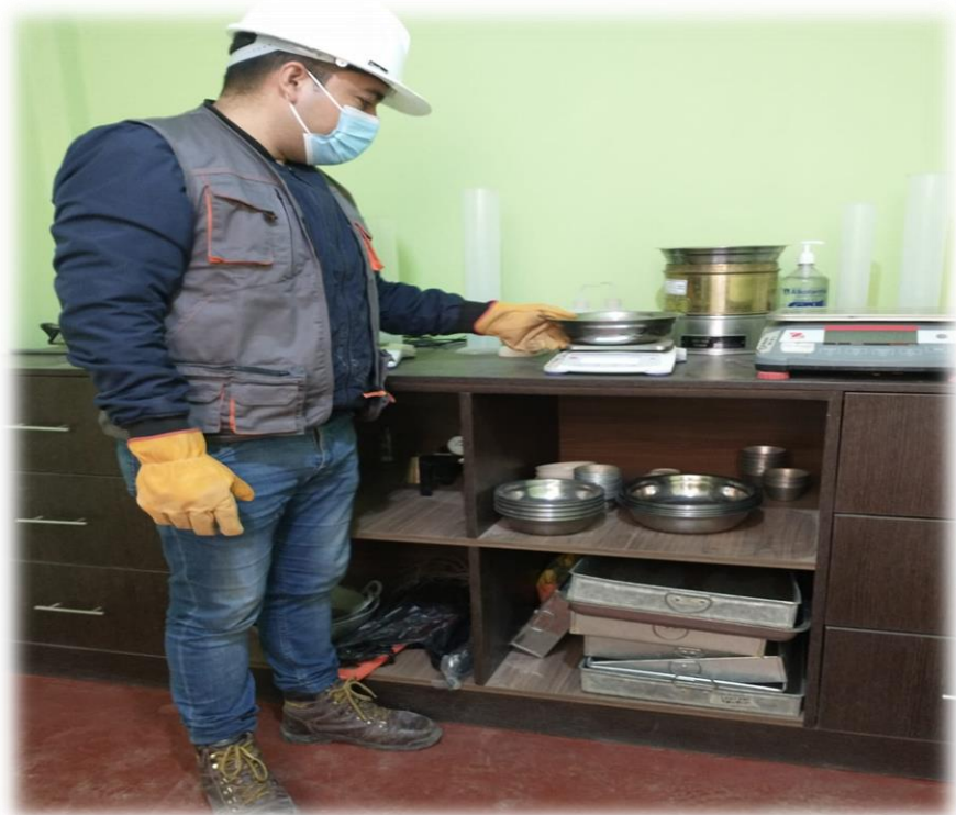
Pesado del agregado fino antes del entrar al horno.
