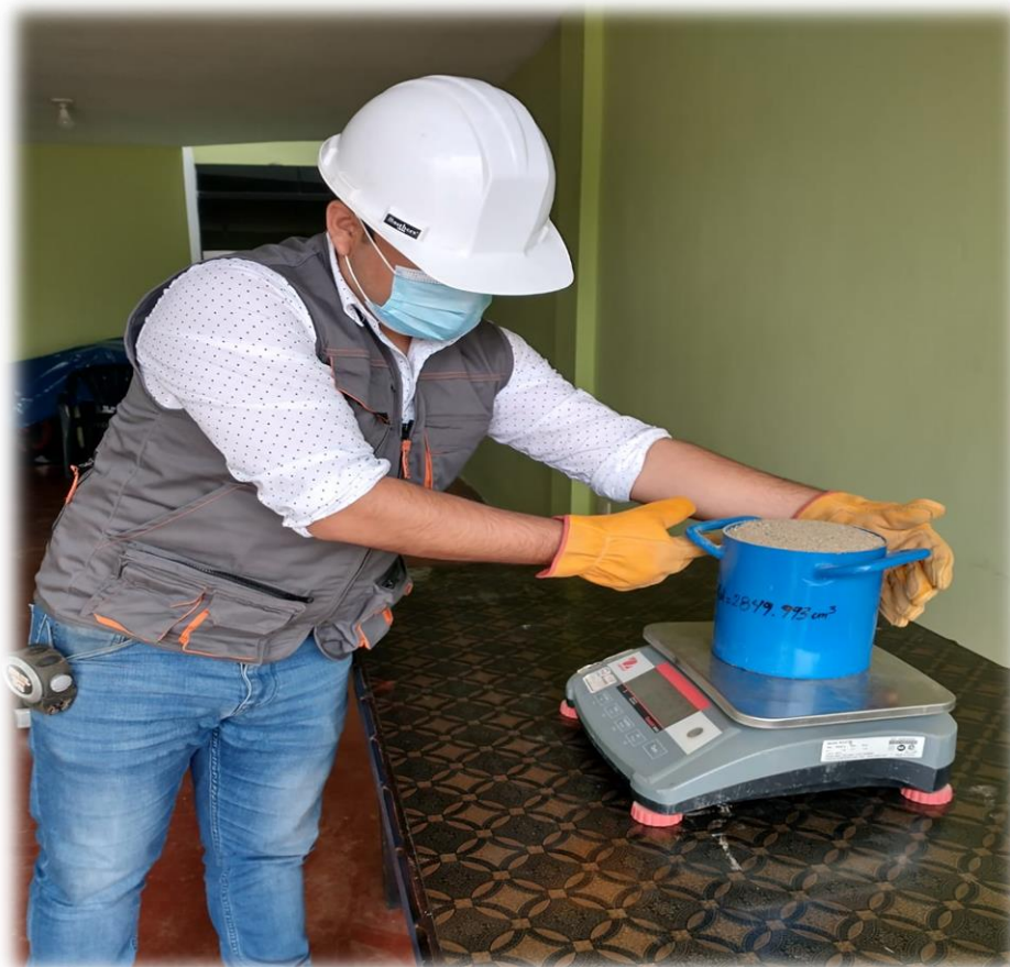
Pesado del agregado fino.
