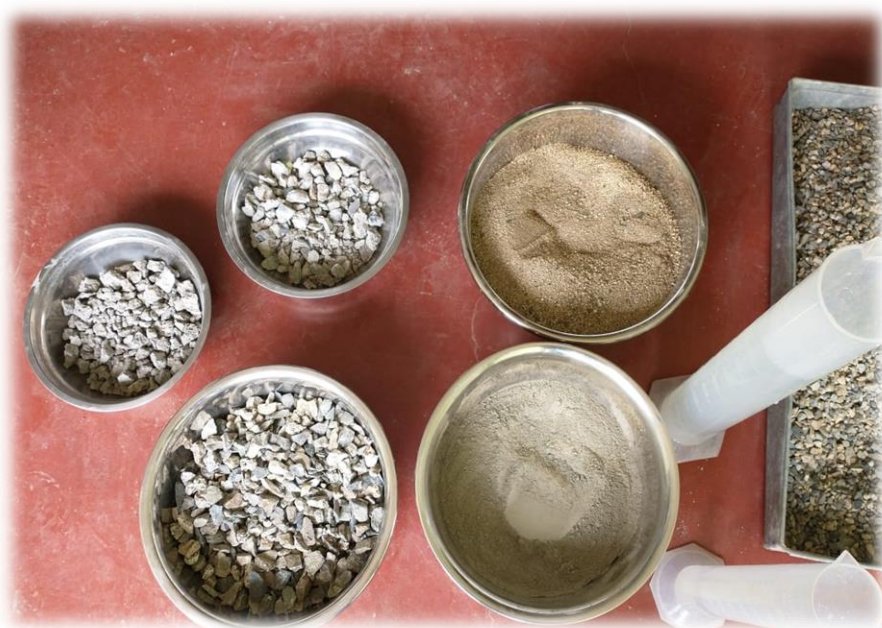
Agregados de reemplazo para elaboración de concreto
