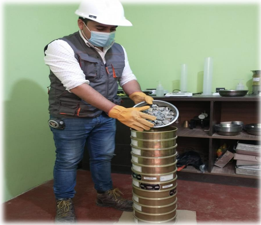
Agregado grueso convencional, paso por las mallas.
