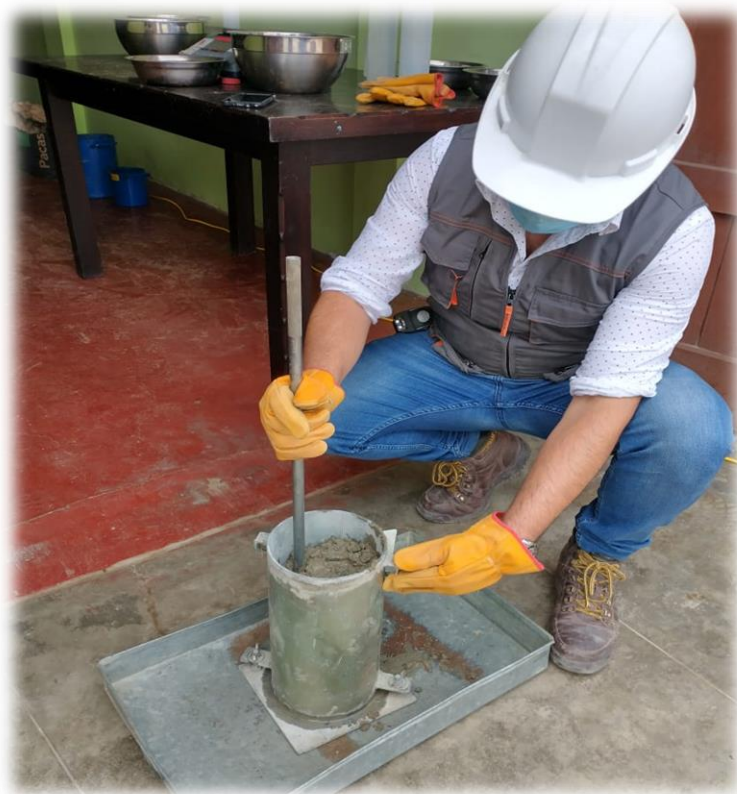
Chuseado de la segunda capa concreto patrón.
