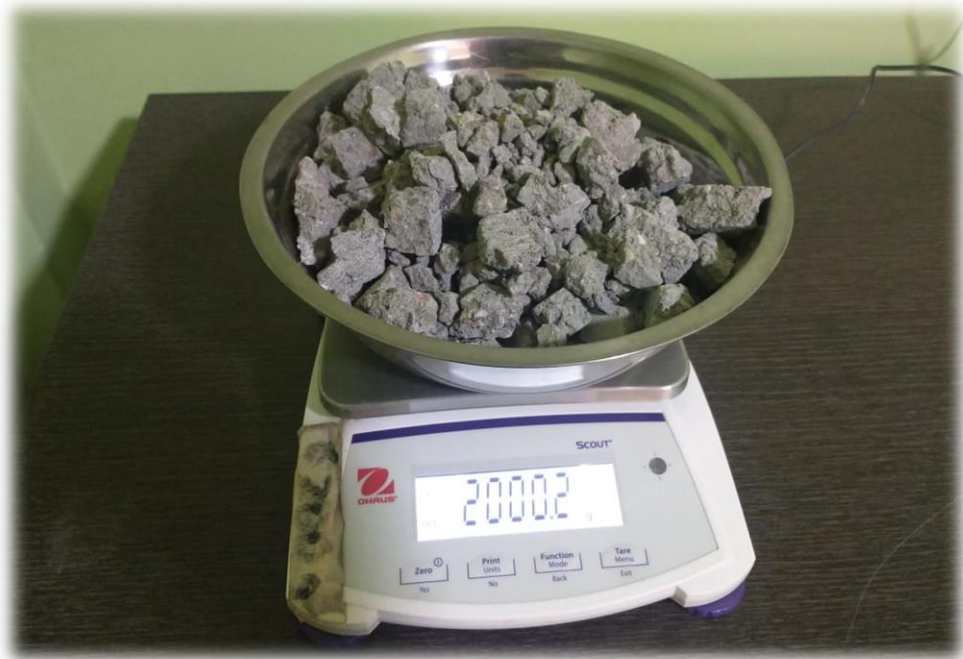
Pesado del agregado de ladrillo triturado.
