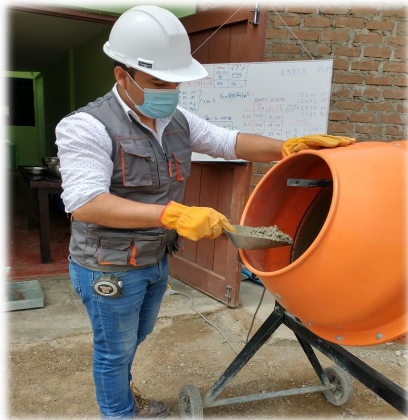
Sacando concreto para la elaboración de probetas de concreto patrón.
