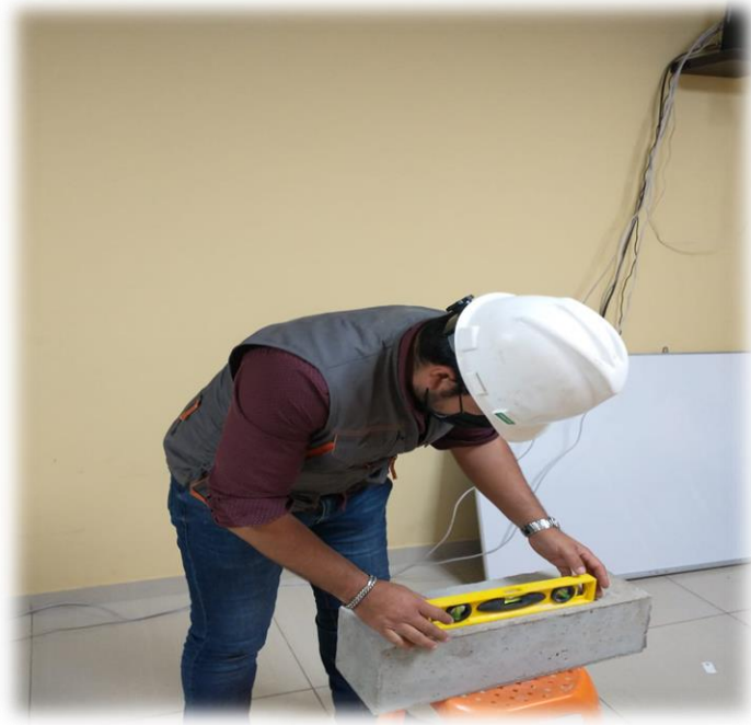
Probetas prismáticas – toma de medida a la falla.
