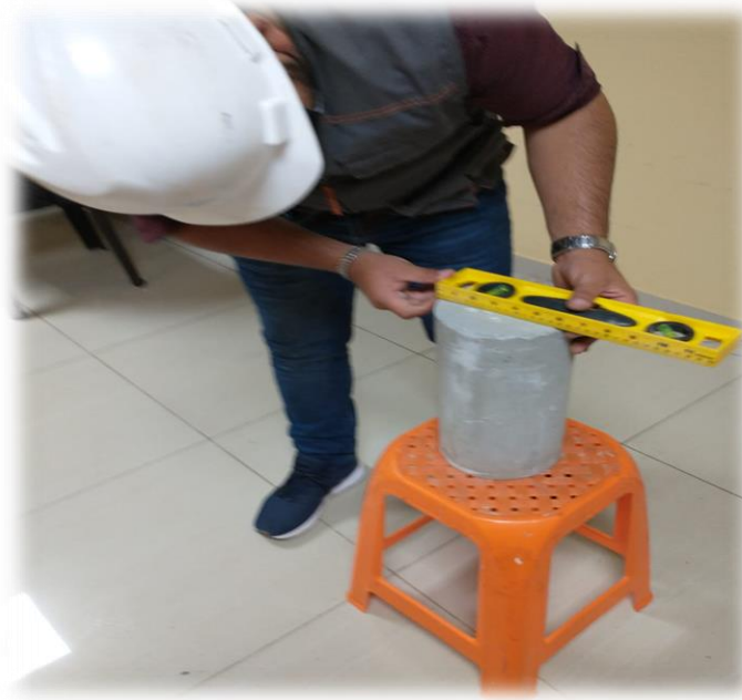
Probetas cilíndricas – toma de medida del diámetro.
