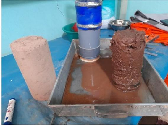
Testigo extraído del equipo después de realizado el ensayo
