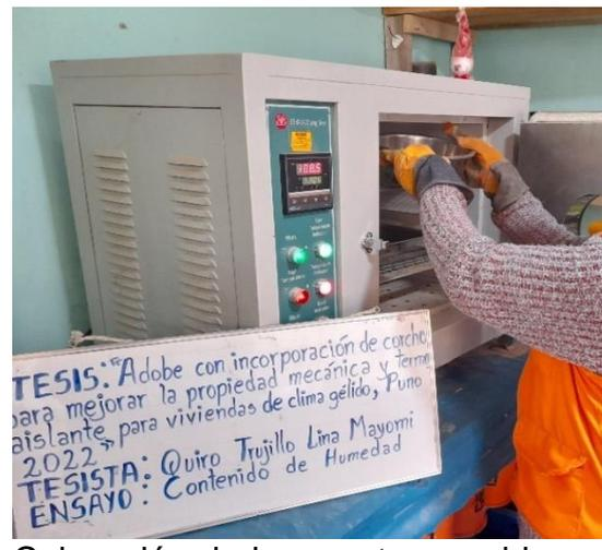
Colocación de la muestra en el horno para obtener contenido de humedad
