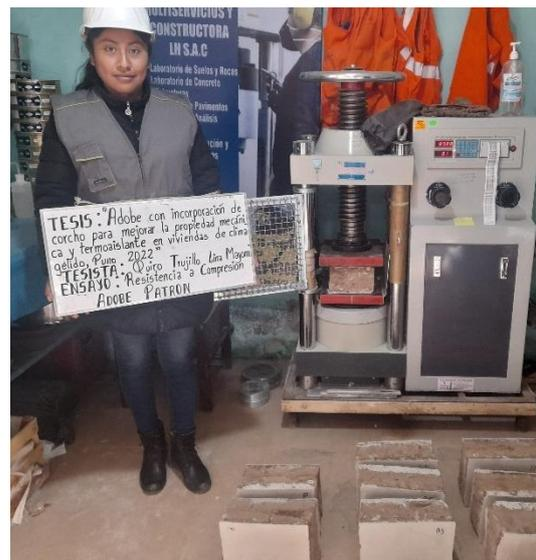
Ensayo de resistencia a compresión de la muestra patrón
