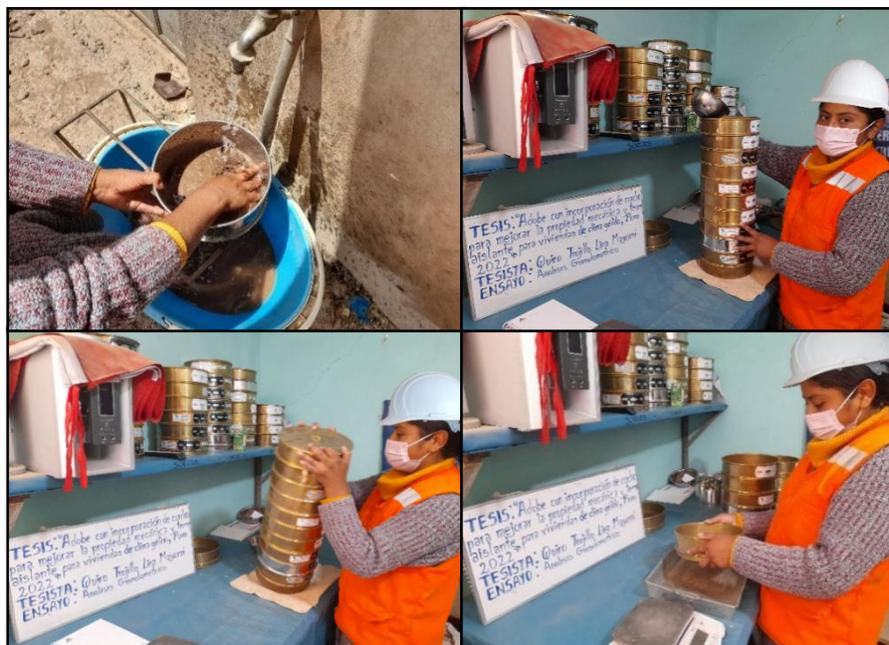
*Figura 15.* Ensayo de análisis granulométrico.
