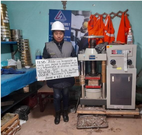
Ensayo de resistencia a compresión de adobe+1.0%corcho
