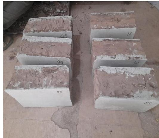
Adobes refrentados para realizar el ensayo de resistencia a compresión
