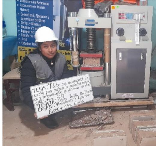
Ensayo de resistencia a compresión de adobe+0.5%corcho
