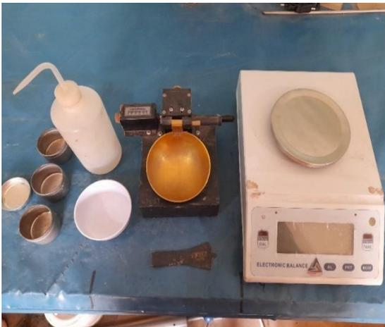
Materiales empleados para realizar el ensayo límites de consistencia
