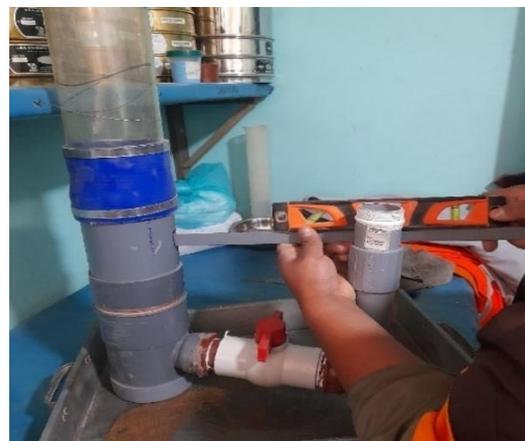
Posicionamiento del equipo para realizar en ensayo de permeabilidad
