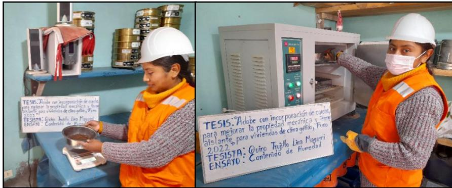
observa en la figura 14, para después pesar la muestra seca.
