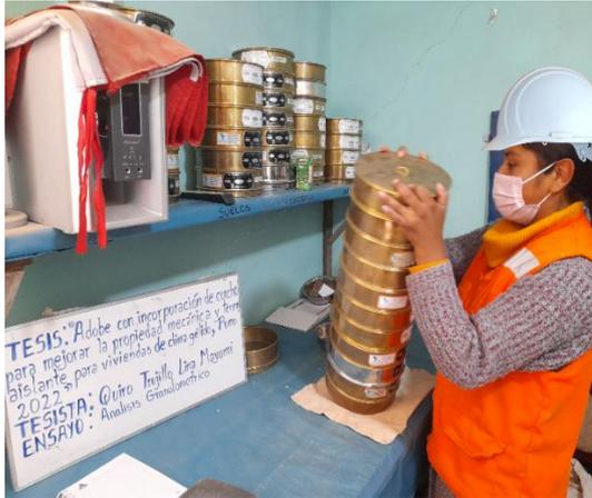
Tamizado de la muestra de suelo seco en las diferentes aberturas
