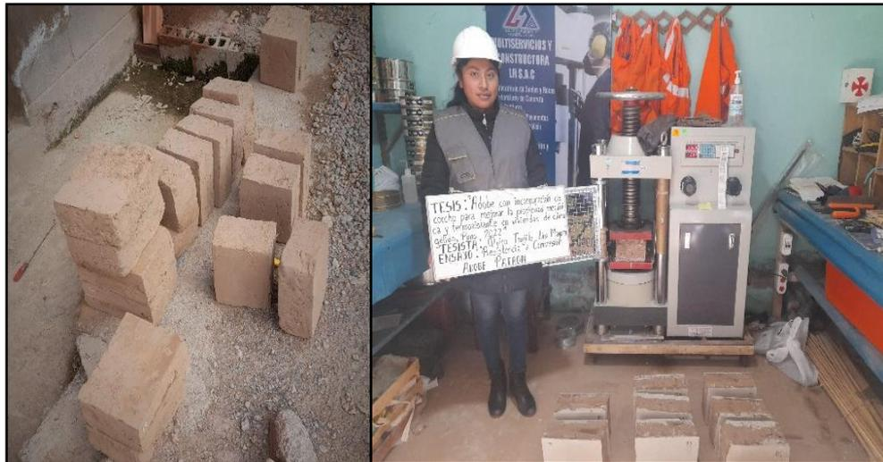
Figura 20. Resistencia a compresión
