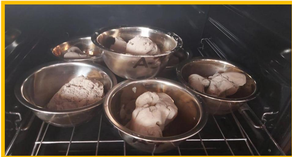
**Figura 30.** Secado de muestra
