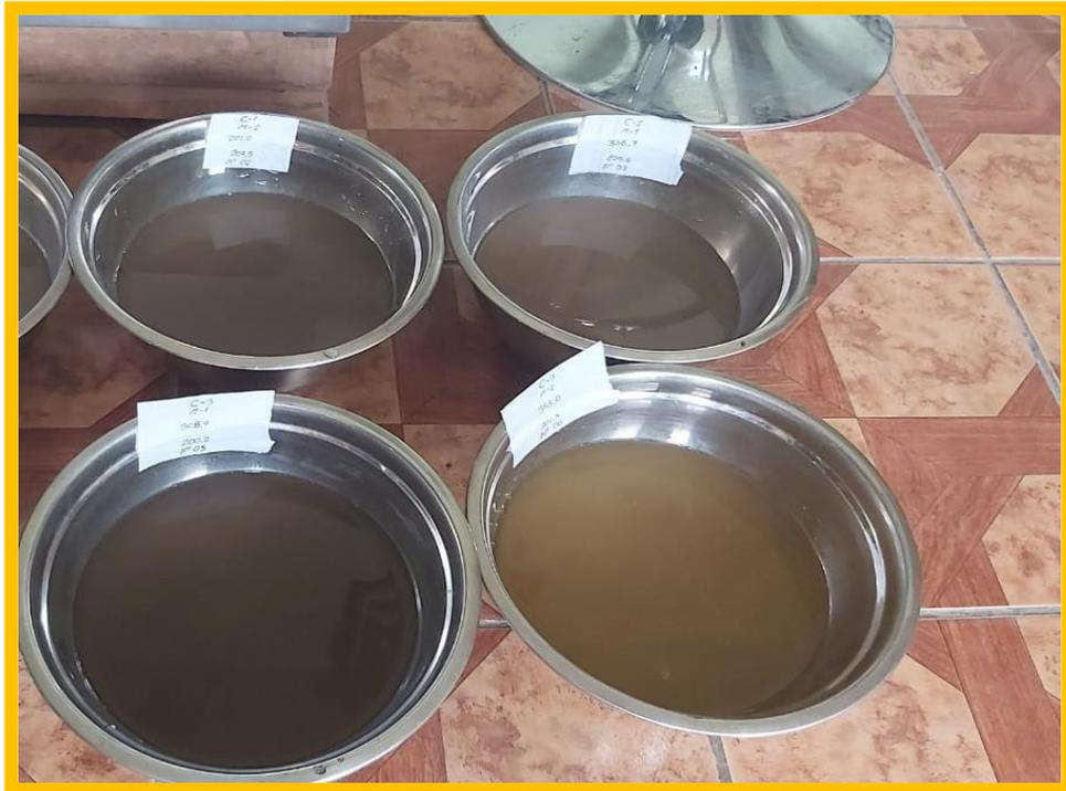
**Figura 31.** Saturación de muestra para lavarlas por la malla #200
