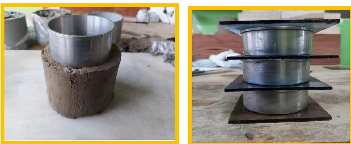
**Figura 34.** Tallado de muestras en moldes para saturarlas y ensayarlas
