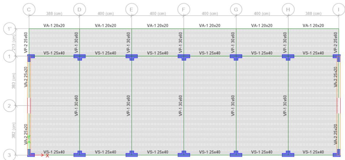
**Figura 105.** Elementos estructurales primer piso y segundo piso Bloque 01
