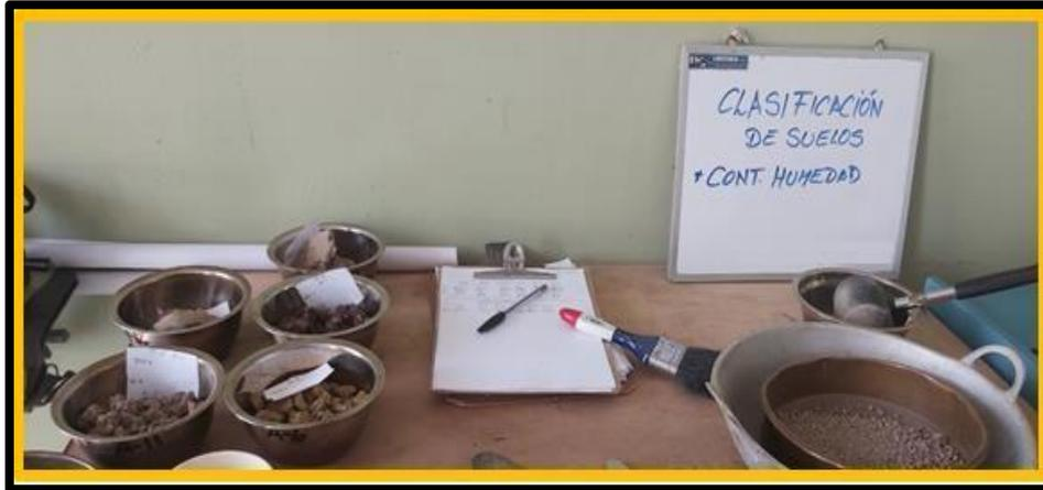
**Figura 29.** Peso de muestra para calcular el contenido de humedad.
