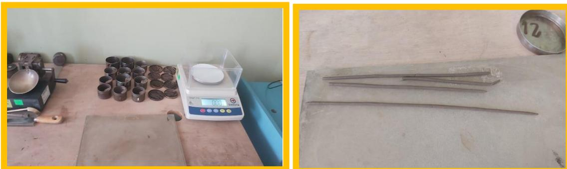
**Figura 33.** Ensayo de limite líquido y limite plástico
