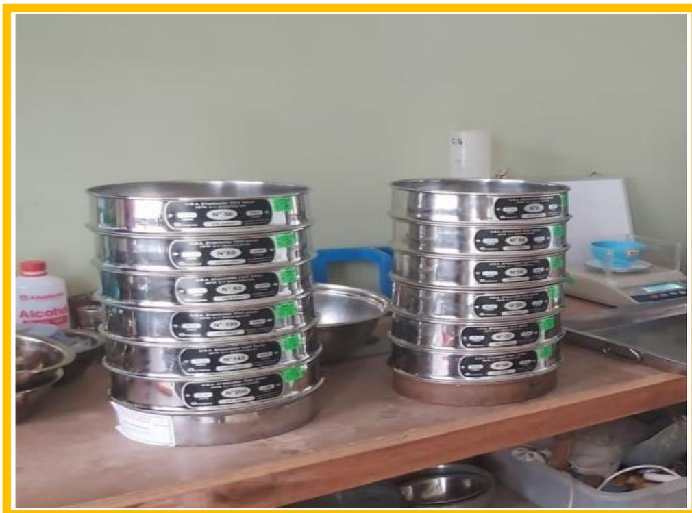
**Figura 32.** Análisis granulométrico de muestras
