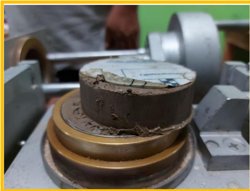
**Figura 37.** Ensayo de corte Directo
