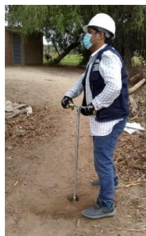
Ilustración 14: Extracción de calicatas Ilustración 15: Penetración Dinámica Ligera
