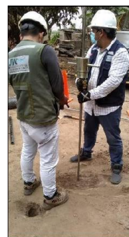
Ilustración 14: Extracción de calicatas Ilustración 15: Penetración Dinámica Ligera
