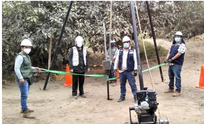
Ilustración 13: Ensayo de penetración estándar (SPT)
