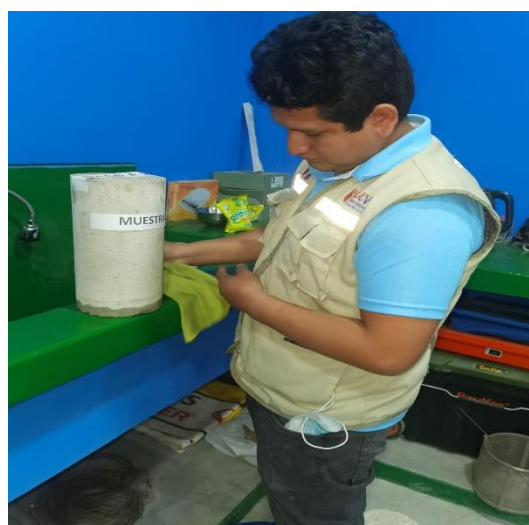
Limpiando exceso de agua.
