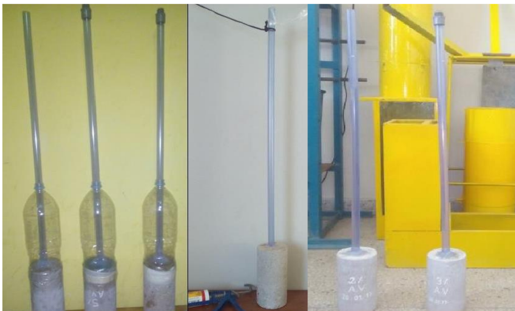
Figura 3. Concreto con infiltración de agua.
