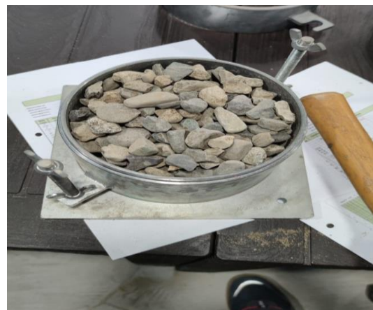
Golpeo con martillo agregado grueso
