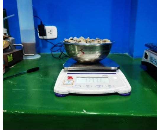
Pesaje agregado grueso
