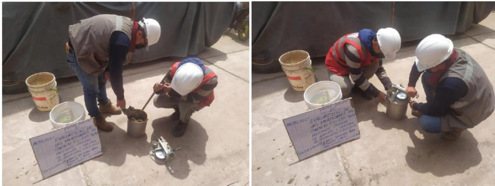
Fotografía 3 y Fotografía 4 Determinación del contenido de aire del concreto fresco - Ceniza de Eucalipto.
