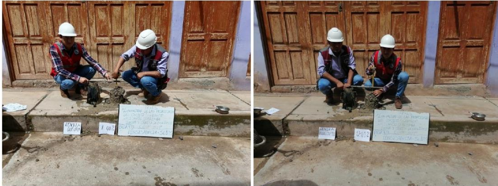
Fotografía 5 y Fotografía 6 Determinación del SLUMP, concreto + Ceniza de horno de queuña.
