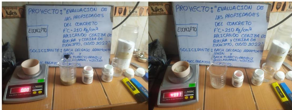
Fotografía 3 Y Fotografía 4 IZQUIERDA: Análisis químico de los agregados, DERECHA: Análisis granulométrico.
