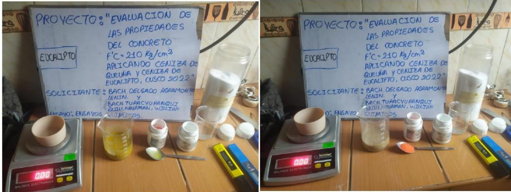
Fotografía 1 Y Fotografía 2 IZQUIERDA: Determinación de sales solubles, DERECHA: Determinación de sulfatos solubles.
