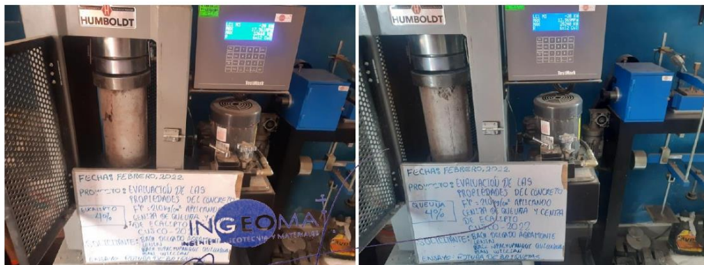
Fotografía 3: Compresión uniaxial de unidades de concreto 4% ceniza de eucalipto C.E. Y Fotografía 4: Compresión uniaxial de unidades de concreto 4% ceniza de Queuña C.Q.
