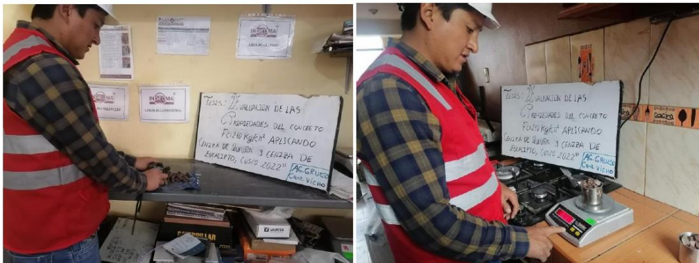
Fotografía 3 Y Fotografía 4: IZQUIERDA: Secado superficial del agregado grueso, para determinar la absorción y peso específico, DERECHA: Pesado de agregado grueso para determinar el contenido de humedad.
