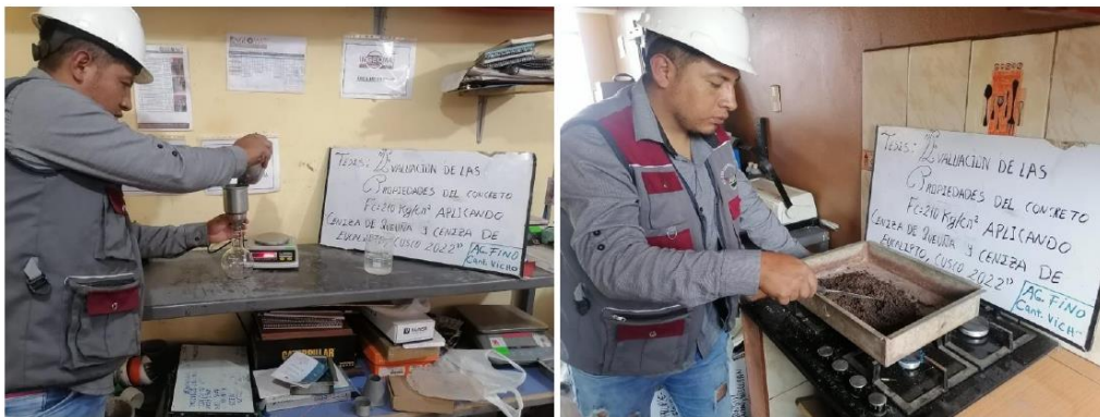
Fotografía 7 Y Fotografía 8: IZQUIERDA: Determinación del peso específico, DERECHA: Secado de muestras para el análisis granulométrico.
