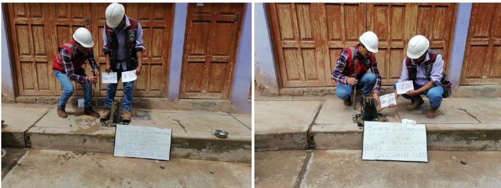
Fotografía 3 y Fotografía 4 Determinación del SLUMP, concreto + Ceniza de eucalipto.
