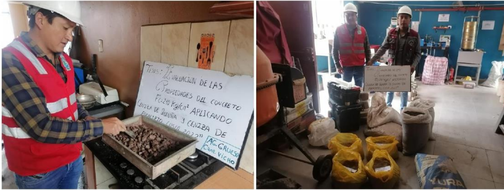
Fotografía 1 Y Fotografía 2 IZQUIERDA: secado de muestra para el análisis granulométrico, DERECHA: Preparación de materiales para la elaboración del concreto. (FUENTE: INGEOMAT.)
