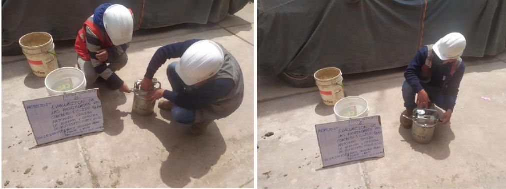
Fotografía 5 y Fotografía 6 Determinación del contenido de aire del concreto fresco – Ceniza de Queuña.
