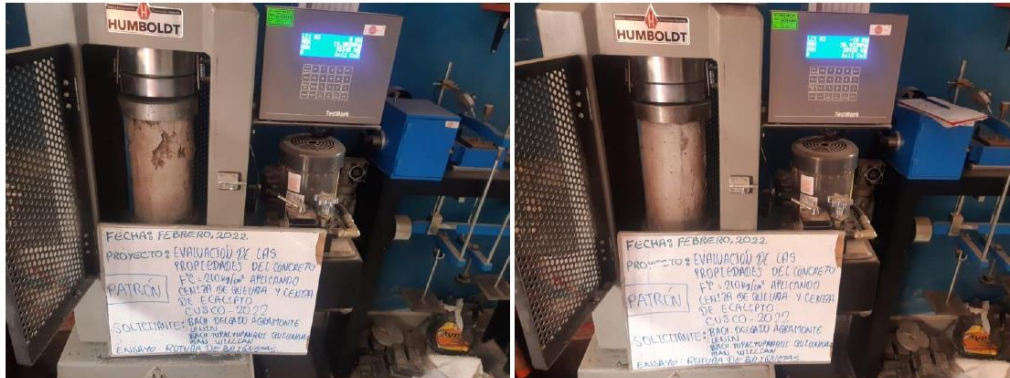
Fotografía 1 Y Fotografía 2: Compresión uniaxial de unidades de PATRON
