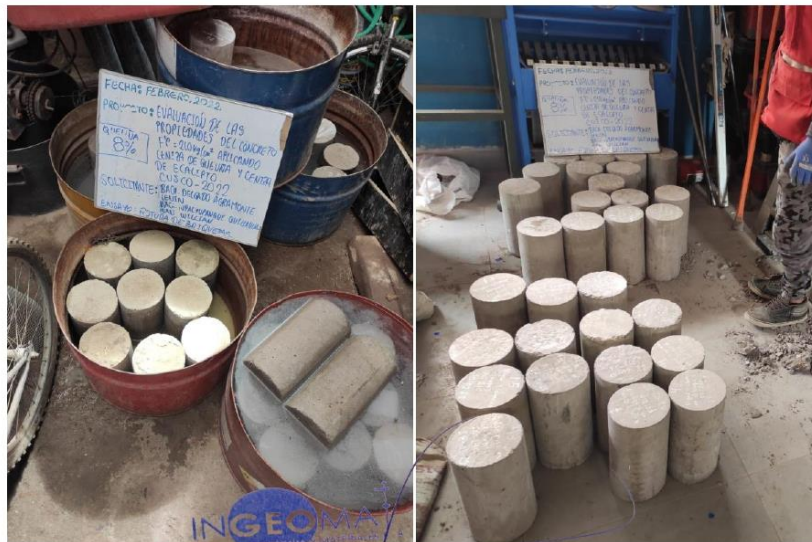
Fotografía 23 y Fotografía 24 Sumergido y codificación de los especímenes de concreto, para la futura a compresión Uniaxial.
