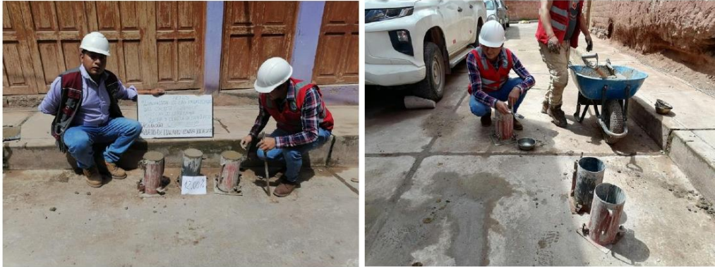
Fotografía 21 y Fotografía 22 Vaciado del concreto en las briqueteras de 15*30 cm, tercera capa.
