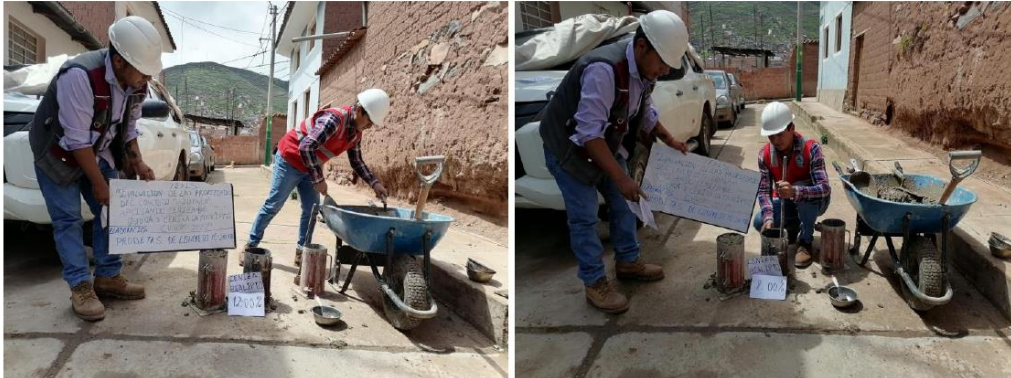
Fotografía 17 y Fotografía 18 Vaciado del concreto en las briqueteras de 15*30 cm, primera capa.
