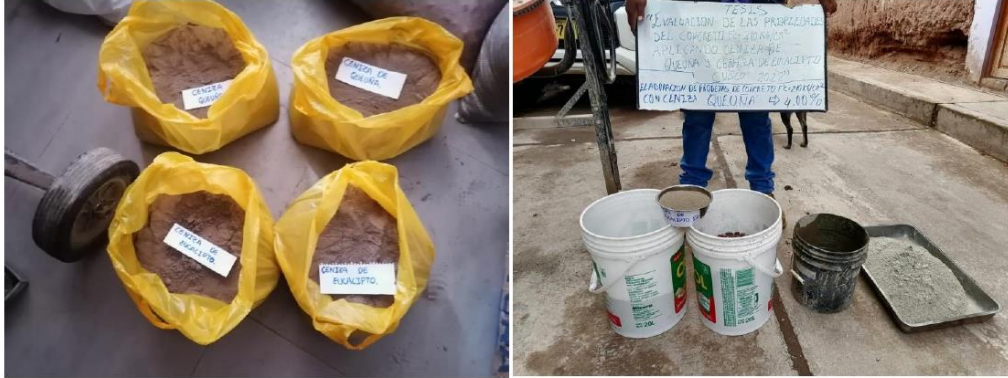
Fotografía 9 y Fotografía 10 Derecha: Preparación de la ceniza de eucalipto y queuña, IZQUIERDA: Pesado de los componentes de la mezcla de concreto.
