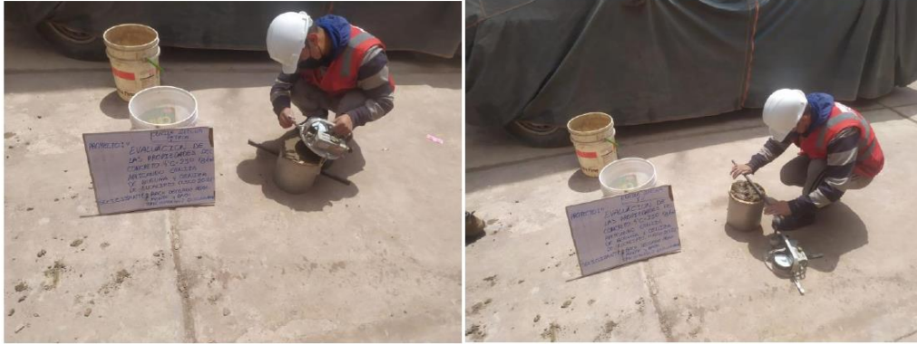
Fotografía 1 y Fotografía 2 Determinación del contenido de aire del concreto fresco - PATRON.
