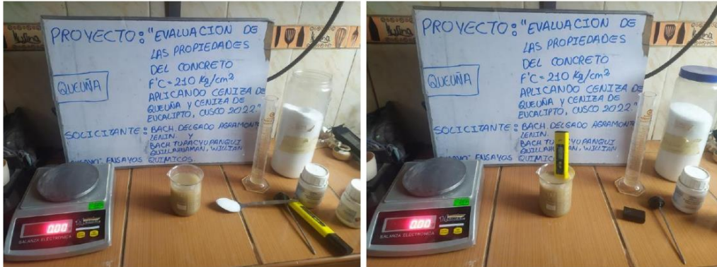
Fotografía 5 Y Fotografía 6 IZQUIERDA: Determinación de sales solubles, DERECHA: Determinación de sulfatos solubles.
